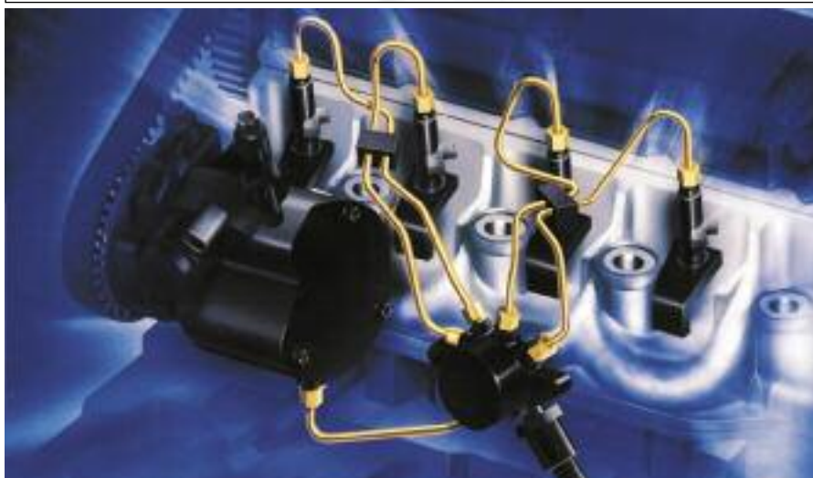
Sistema "Common rail" de inyección directa de gasoil de alta presión. El combustible es sometido a ensayo en laboratorio –test HFRR– para medir su "poder lubricante".
