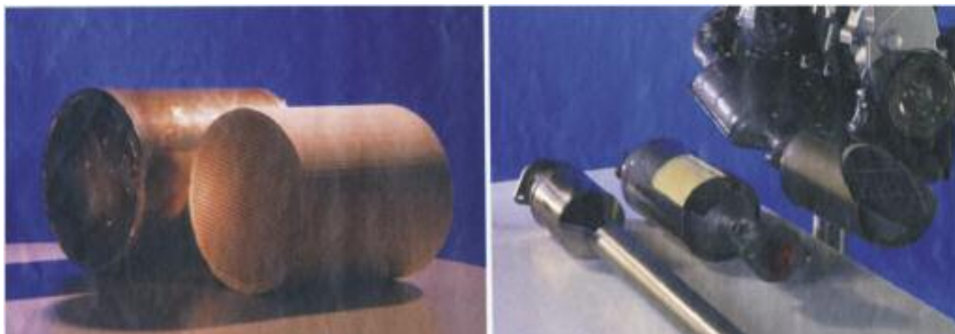
Los filtros de partículas tienen la finalidad de retener o de quemar las partículas de hollín o de carbono particulado.
