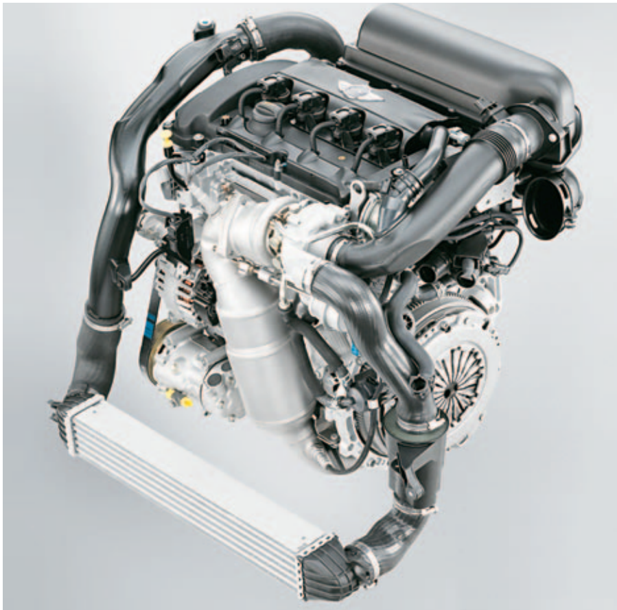
Motor de 4 cilindros en línea de 1.6 litros, turbo-intercooler con inyección directa de nafta, y sistema Valvetronic, con una potencia de 184 HP y 240 Nm de par motor- MINI.
