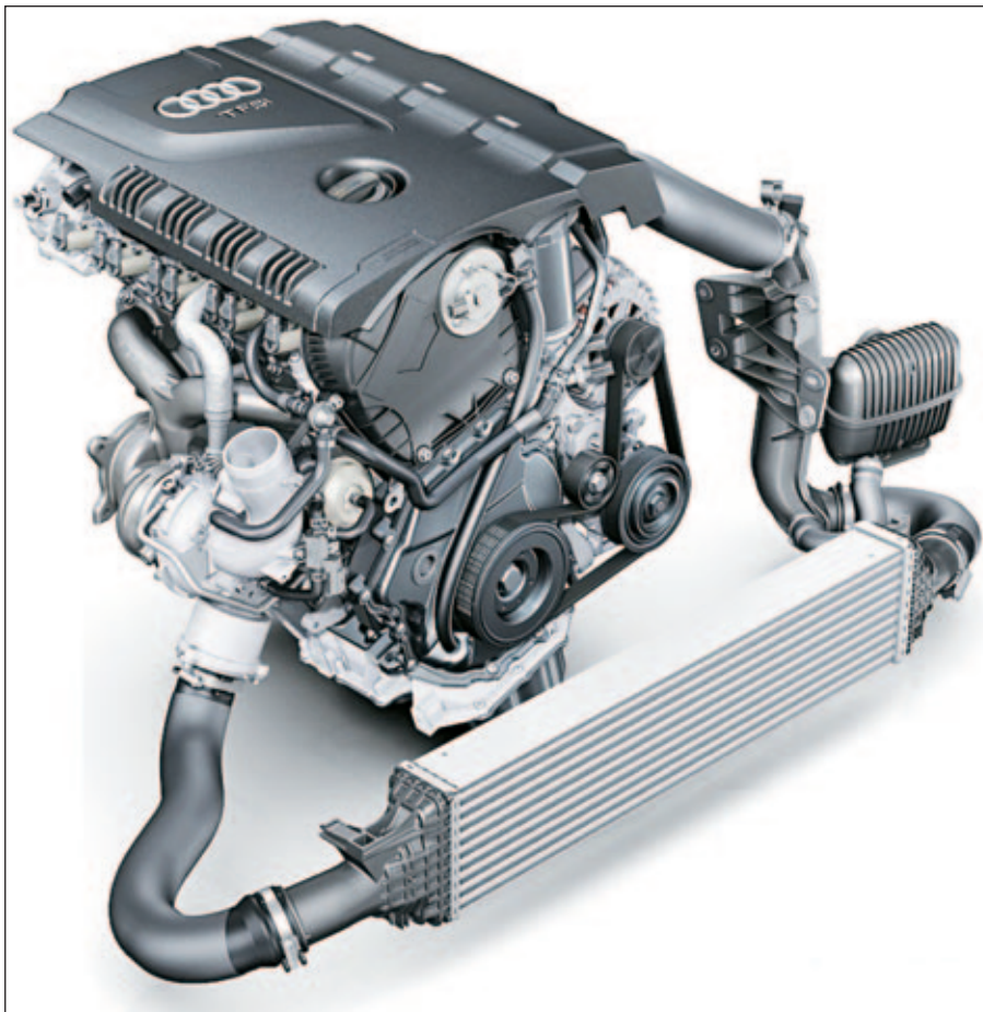
Motor de 2.0 litros, 4 cilindros en línea TFSI., con inyección directa de nafta, turbo-intercooler, distribución variable (admisión), con una potencia de 211 CV a 6.000 rpm., y un par motor de 350 Nm. a 4.200 rpm.- Audi A4.
