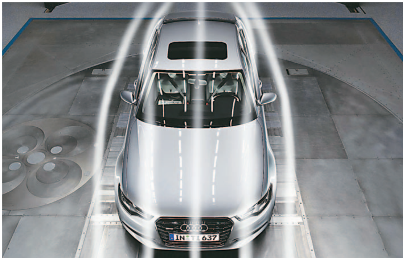
Comportamiento del flujo aire en la parte exterior del Audi A6. Durante el desarrollo de la aerodinámica en el túnel de viento de la planta de Ingolstadt se ha conseguido reducir la resistencia aerodinámica en un 20%.
