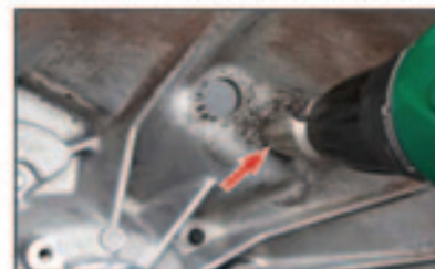
Fig. 5: Ampliación de los orificios con un taladro
