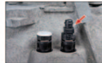
Fig. 8: Se puede accionar la boquilla de purga con la mano o con una llave de boca (ancho de llave: 13)
