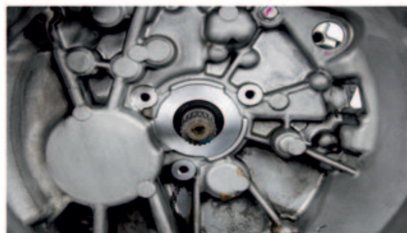
Fig. 1: Superficie de montaje del Collarín hidráulico en la carcasa de la caja de cambios
