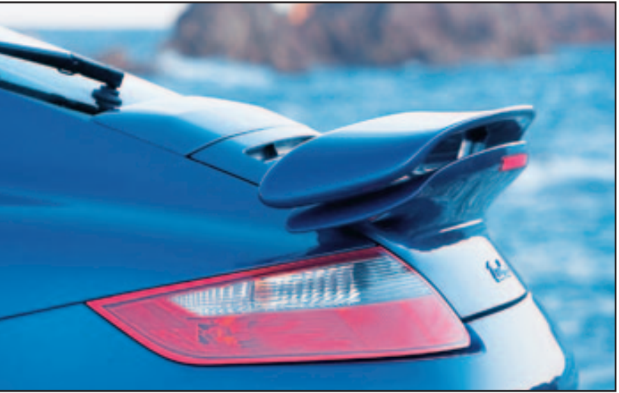
Los alerones crean una presión suplementaria sobre las ruedas aumentando la potencia de tracción, entre otras cosas.
