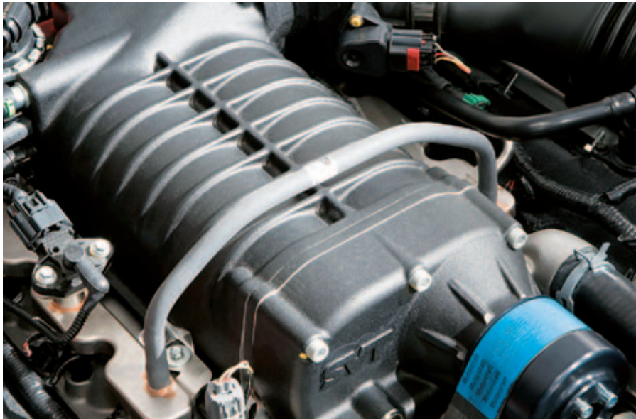
Motor del Ford Shelby con compresor volumétrico - Ford Shelby Cobra GT 500.
