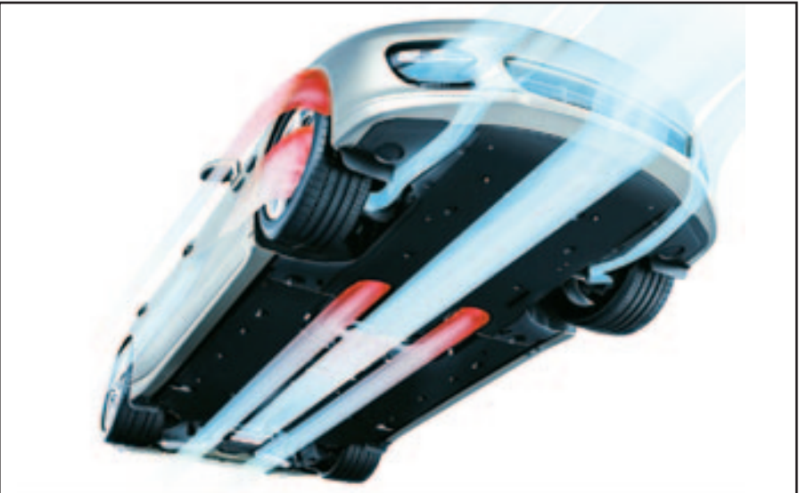
Flujo de aire externo, entre el piso del vehículo y el suelo o superficie.-Porsche.
