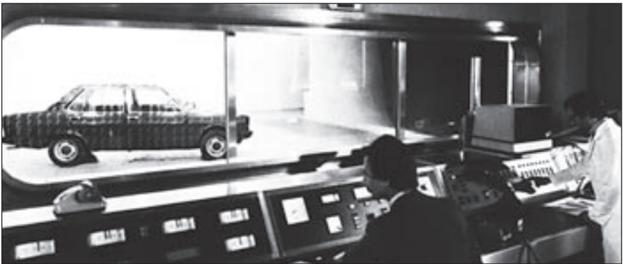
Desde hace años, se usa para medir y observar, el túnel de viento, muy equipado, en la industria automotriz. Este permite hacer un relevamiento de las mediciones de la resistencia al aire, y observar al mismo tiempo la trayectoria de filetes testigos, ubicados en el modelo sometido a ensayos.-
