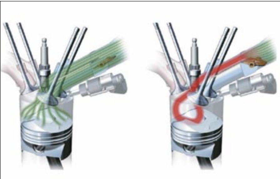
La inyección directa de nafta/gasolina de alta presión (200 bares) logra en sus diferentes versiones, una combustión completa.
