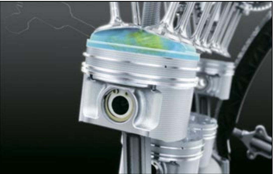
Cámara de combustión con inyección directa de nafta/gasolina- BMW.
