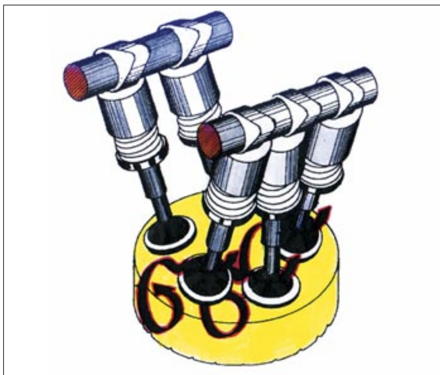
Sistema de distribución con válvulas múltiples, 3 de admisión y 2 de escape.
