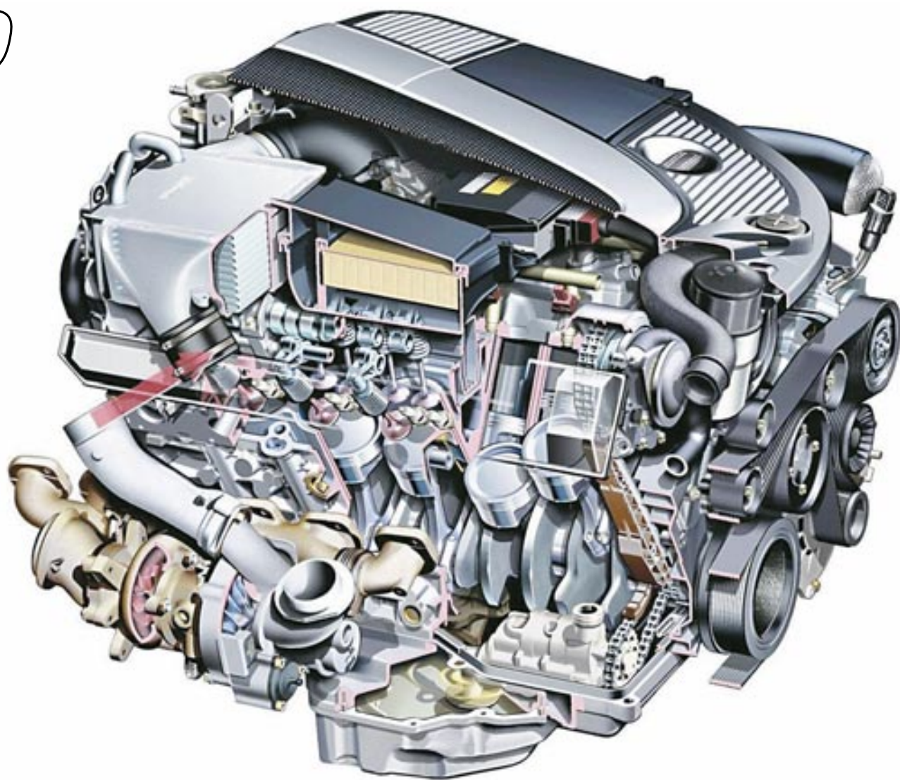
Motor en corte de 12 cilindros en V, turbosobrealimentación doble con intercooler - M.Benz.
