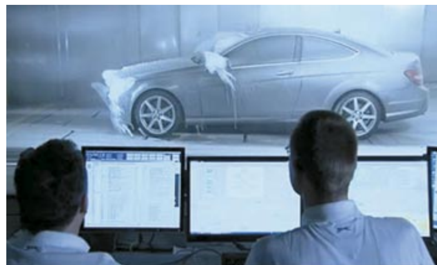
En este túnel, se pueden además realizar precipitaciones pluviales, regulando la intensidad y la forma de los gotas.
