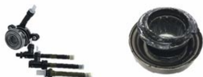
Fig. 1: Cilindro maestro LuK 511 0326 10 y comparativo de tamaño entre una vedación, antes y después de la contaminación.
