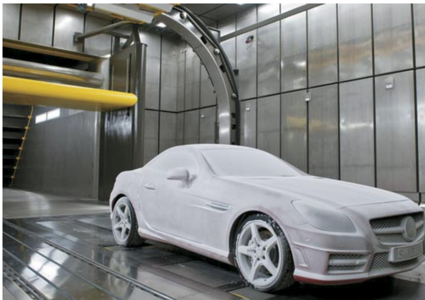
Posee un potente ventilador, capaz de generar velocidades de viento de 270 km/h., apoyado en amortiguadores.
