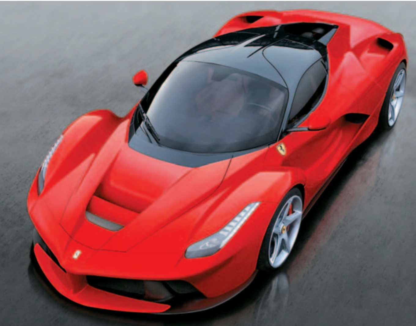
Ferrari: LaFerrari desarrolla 963 CV de potencia y un par máximo de 900 Nm. Los obtiene de un motor V12 que entrega 800 CV y de uno eléctrico de 163 CV. Ferrari llama al sistema híbrido «HY-KERS».
