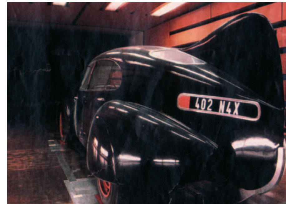
Actualmente se habla del Cx. y de los estudios en el túnel de viento de los automóviles perfilados - Peugeot 402/N4x de los años '30.
