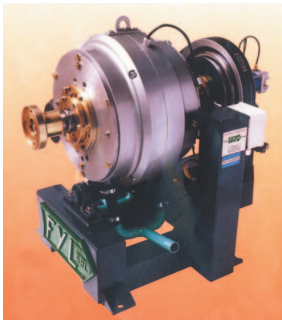
El freno dinamométrico eléctrico FYL. Diseñado para ser usado en motores Diesel y Otto de hasta 3000 cm 3 . Su efecto de frenado se efectúa a través de corrientes parasitas, con refrigeración por líquido. Posee una potencia máxima de disipación de 300 CV.con un régimen máximo de 10.000 rpm. Programable por PC.para operación y adquisición de datos.
