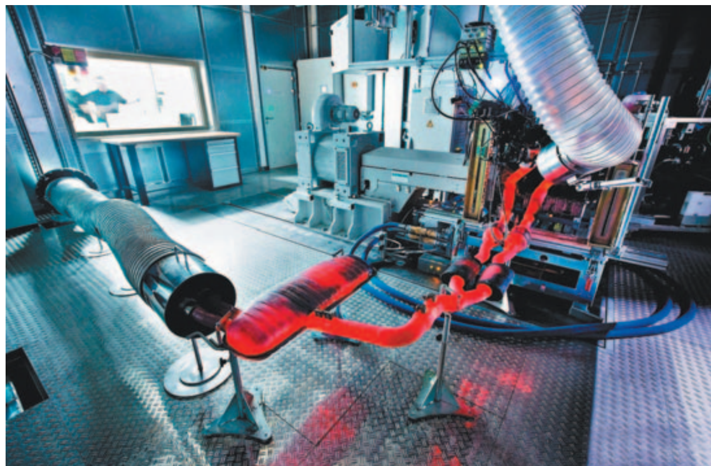
Motor de 4 cilindros posicionado en el banco de pruebas –freno dinamométrico– de un laboratorio de ensayos, para relevar las curvas características del propulsor (potencia, par motor y consumo específico). Detalle del colector de escape al rojo cereza. – Centro de ensayos Skoda de motores.
