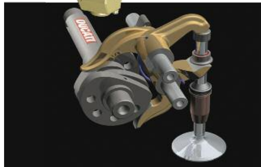
Sistema desmodrómico con una válvula que se abre y se cierra por medio de balancines y levas - Ducati
