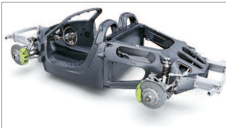
La estructura portante en su núcleo, está construida en fibra de carbono, completada por dos falsos chasis de aluminio.
