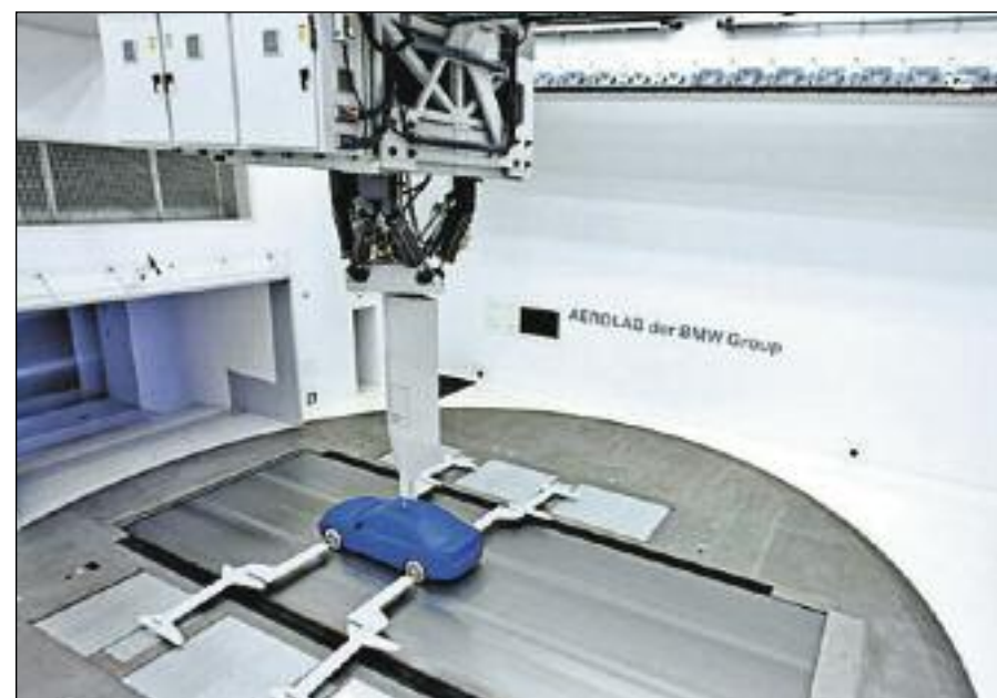
Las maquetas en escala, para el estudio en túneles, siempre deberán representar fielmente, al vehículo definitivo.
