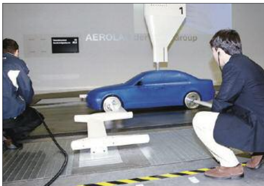
Las maquetas en escala, para el estudio en túneles, siempre deberán representar fielmente, al vehículo definitivo.
