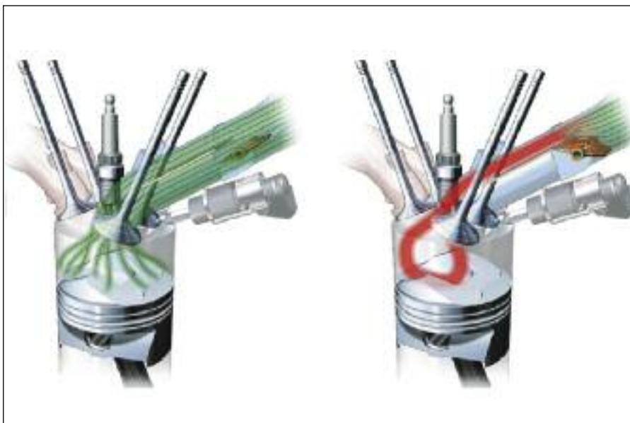
La inyección directa de nafta/gasolina de alta presión (200 bares) logra en sus diferentes versiones, una combustión completa.
