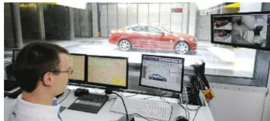
Basicamente un túnel aerodinámico, está compuesto por, un colector, una cámara de experiencia, un difusor, y un ventilador.
