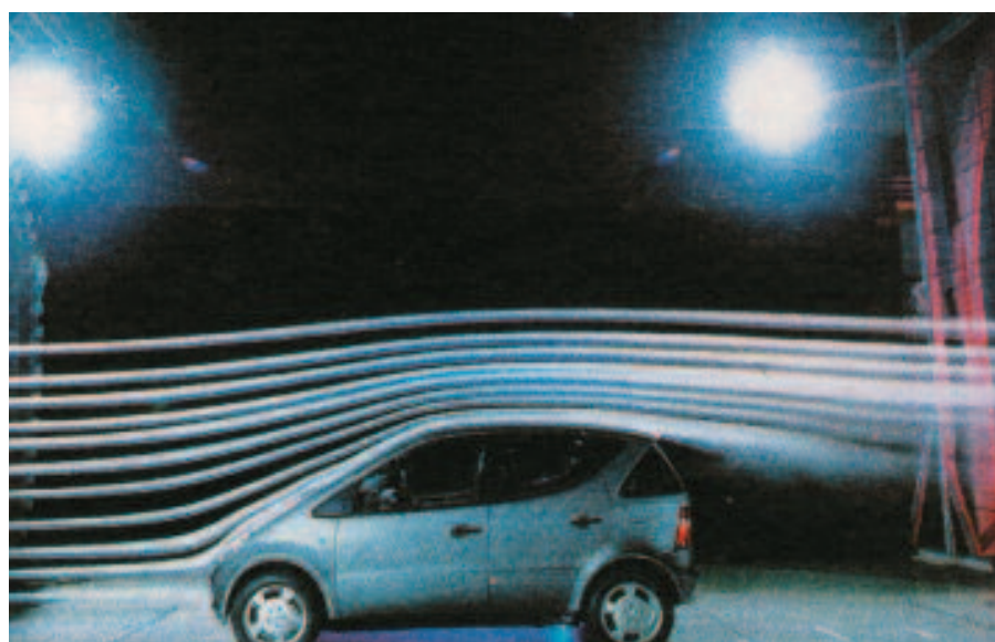
Ensayos en el túnel aerodinámico del Mercedes Benz Clase A, con humo químico. El coeficiente de penetración Cx del Clase A es similar a los excelentes valores aerodinámicos restantes.
