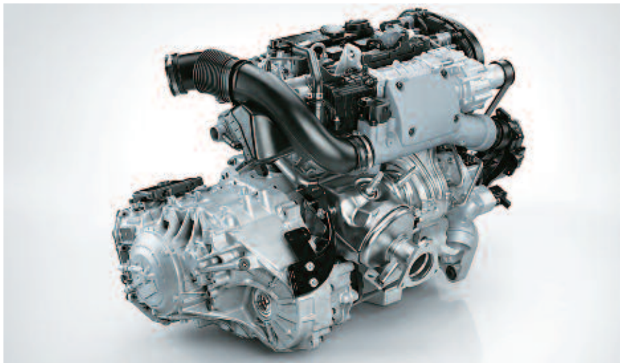
Vista exterior del motor Volvo Drive con compresor volumétrico de desplazamiento positivo.
