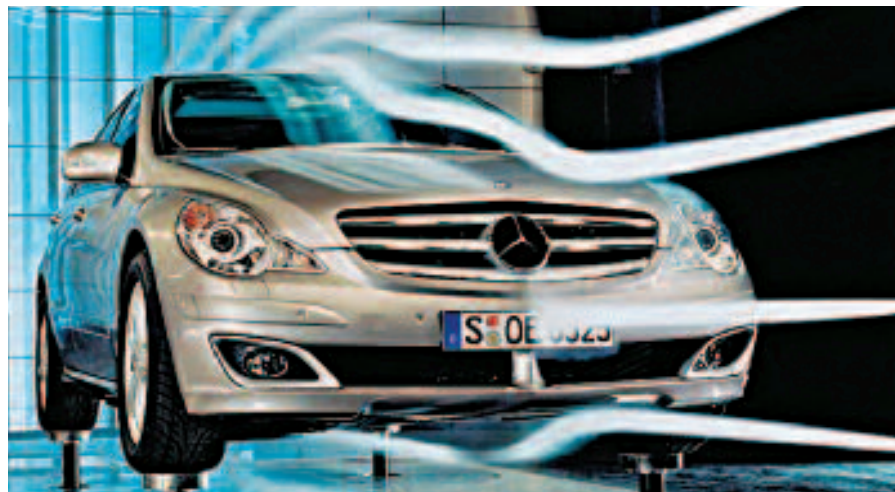
Detalle de los chorros de humo, utilizado por las terminales automotrices como método clásico para el estudio de la aerodinámica – Mercedes Benz.
