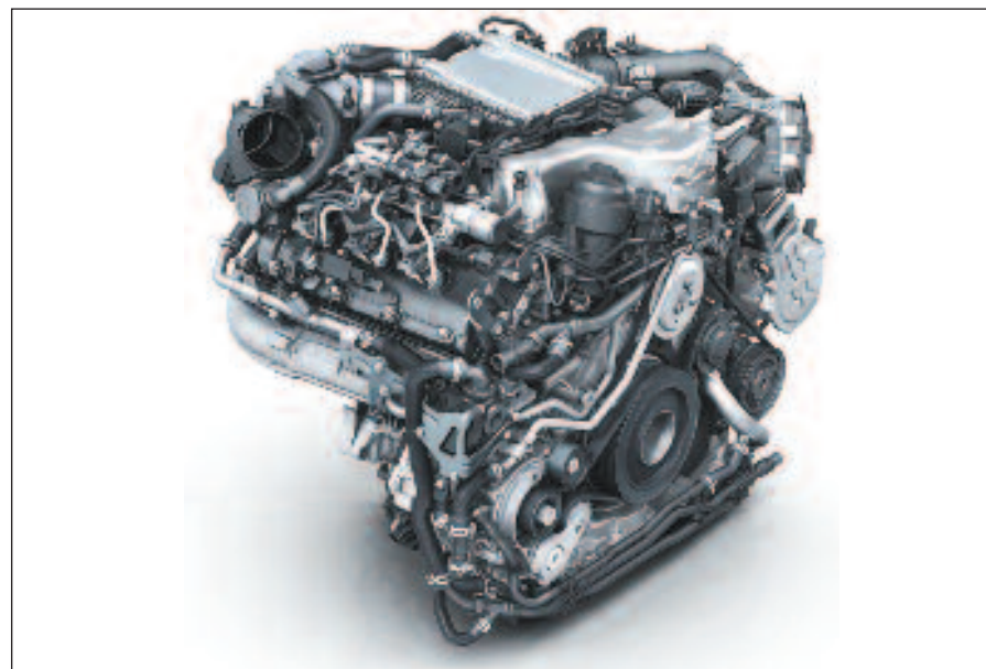
Motor Diesel de 3.0 litros V6, de 341 CV y 700 Nm de par motor. Posee doble trubo con compresor accionado electricamente (EPC) y convertidores catalíticos SCR.- Audi.
