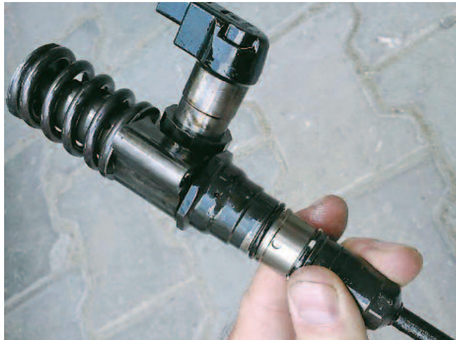
El inyector/bomba reagrupa en un solo cuerpo, una bomba de alta presión, una electroválvula de comando, y un inyector.
