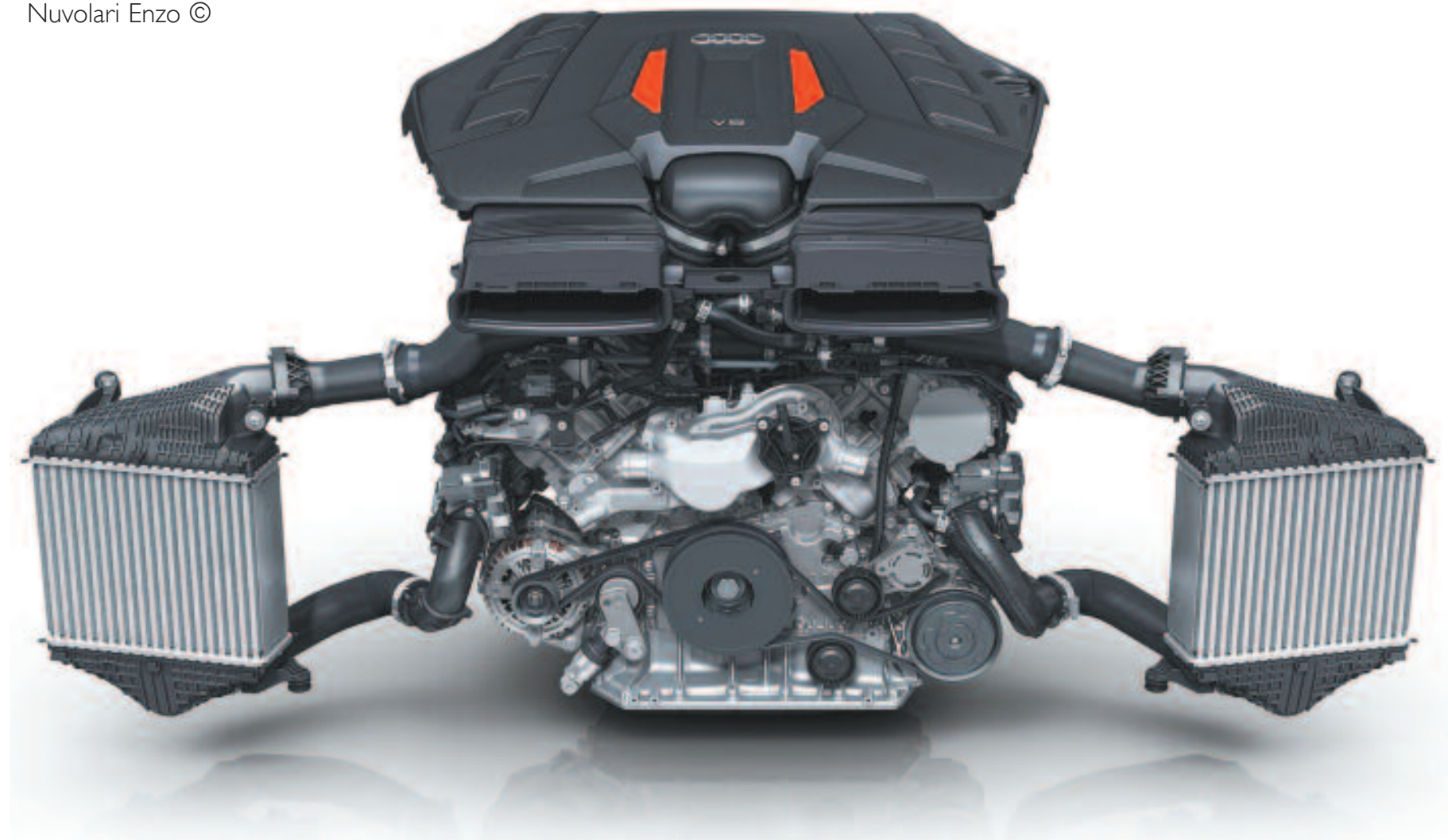
Motor naftero V8 de 4.0 litros, inyección directa, turbo con intercooler, vista de frente, potencia 373 CV y 740 Nm.). Desactiva 4 cilindros en función de la marcha.- Audi
