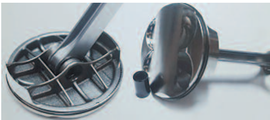
Pistón del motor naftero de alto rendimiento, de cuatro tiempos en aleación de acero (control termomecánico), realizado con el proceso DMLS (Direct Metal Laser Sintering).
