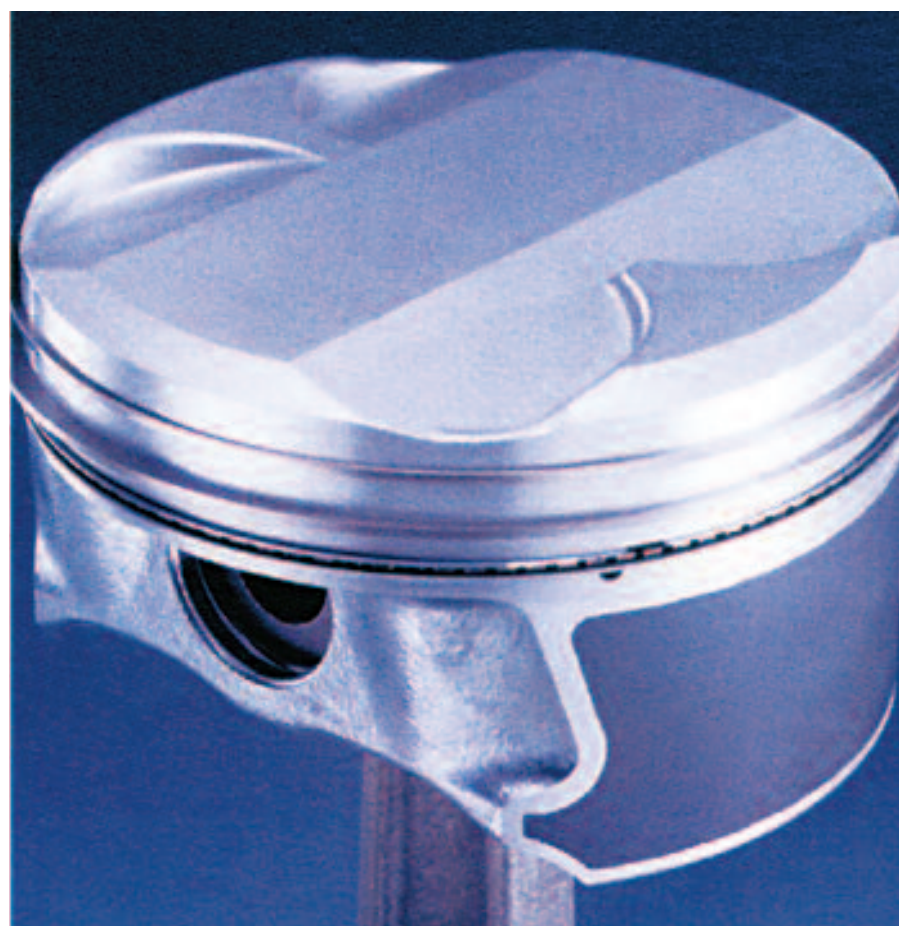
Pistón característico, diseño clásico con falda recortada y cabeza o cielo mecanizado para apertura de válvula.
