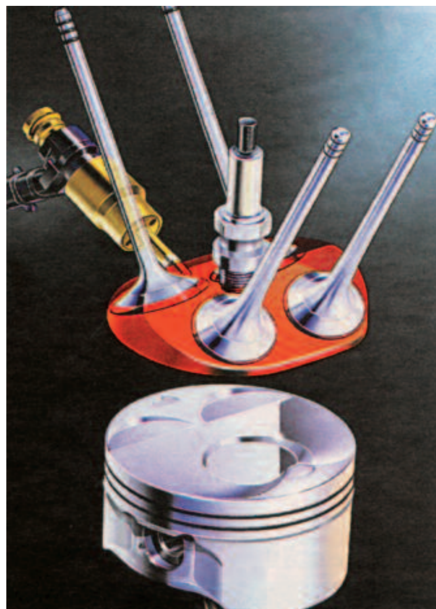
Detalle de la cámara de combustión, del estudiado diseño de la cabeza del pistón, y de la posición del electroinyector de inyección directa de nafta/gasolina - Alfa Romeo.
