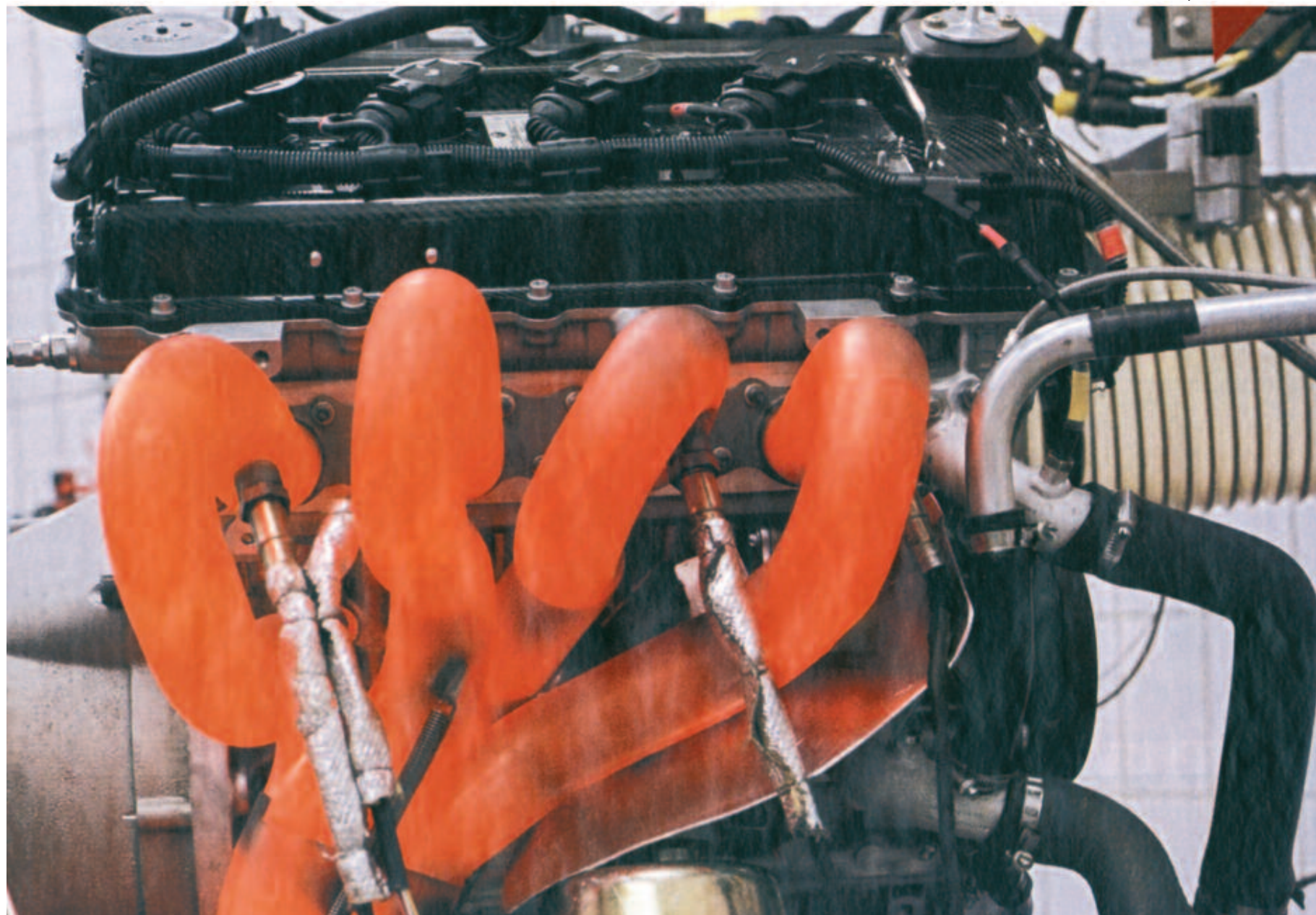
Motor sobre banco de pruebas dinamométrico, con el sistema de escape en color rojo cereza, debido a las exigencias- BMW.
