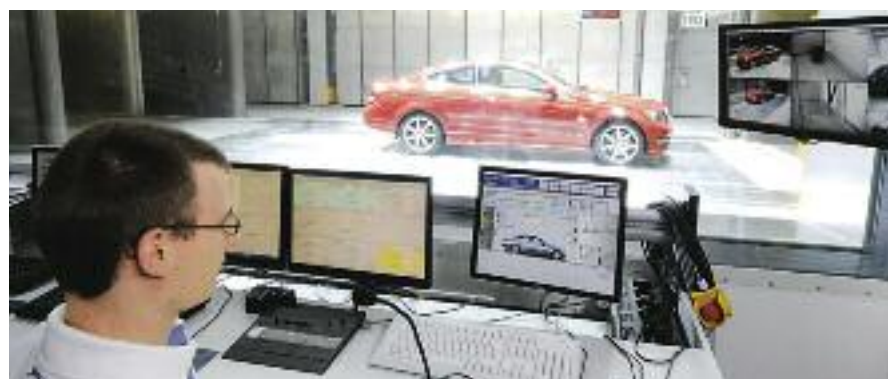
Basicamente un túnel aerodinámico, está compuesto por, un colector, una cámara de experiencia, un difusor, y un ventilador.
