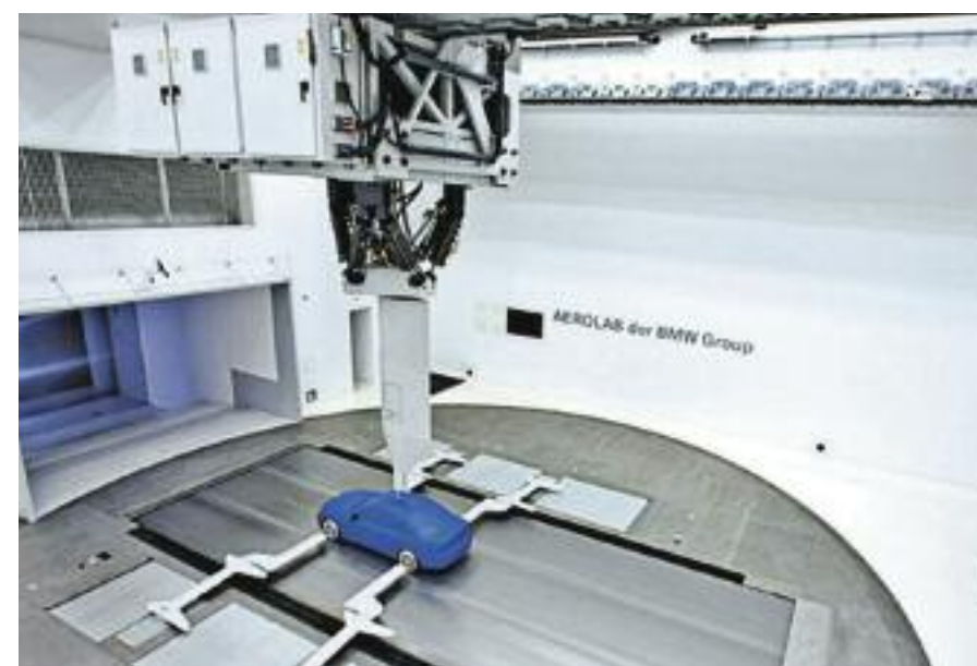
Las maquetas en escala, para el estudio en túneles, siempre deberán representar fielmente, al vehículo definitivo.
