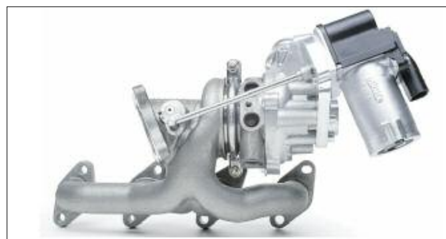
El compresor centrífugo, es el encargado de presurizar al aire de admisión, que ingresa a los cilindros del motor. El valor de sobrepresión es controlado por la válvula "waste gate" o por el sistema TGV o VNT (de álabes variables).
