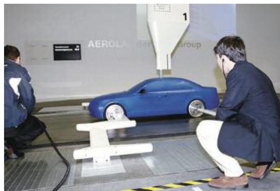
Las maquetas en escala, para el estudio en túneles, siempre deberán representar fielmente, al vehículo definitivo.
