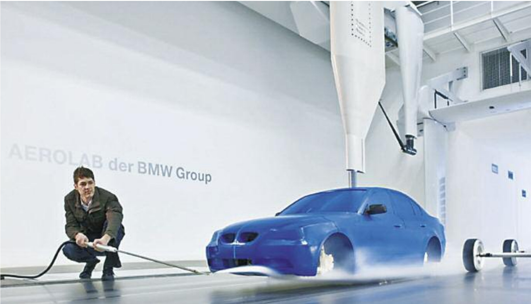
El coeficiente de penetración Cx. es un factor de forma, que tiene relación con la sección frontal.
