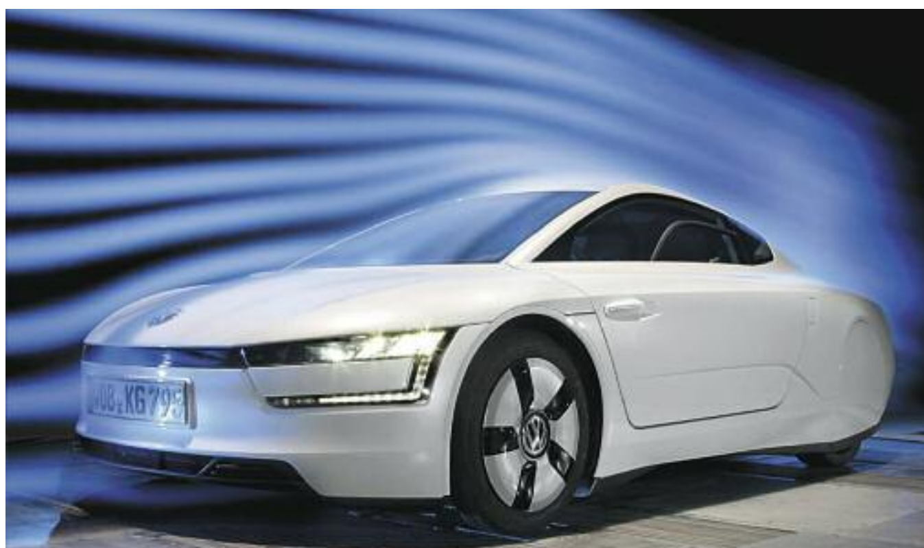
En los automóviles actuales, las terminales automotrices buscan, a través de los trabajos aerodinámicos, disminuir el gasto energético - Volkswagen XL1.
