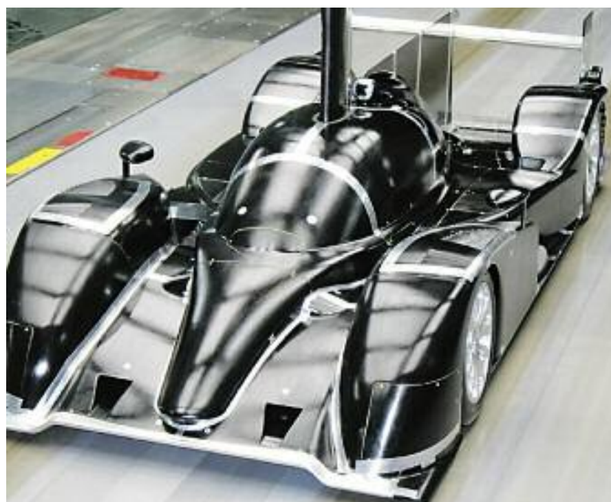
Las maquetas para estudio en el túnel de viento, se construyen normalmente en madera, yeso o arcilla especial.
