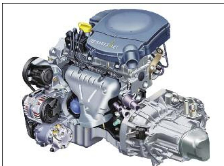
Motor de ciclo Otto Renault de 1.6 litros –atmosférico– con inyección del tipo multipunto MPI indirecta, con una potencia de 105 CV y un par motor de 148 Nm.
