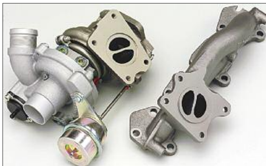
Turbo con válvula "waste gate", y colector de escape con doble conducto denominado "Twin scroll", que se utiliza en el motor de nafta/gasolina.
