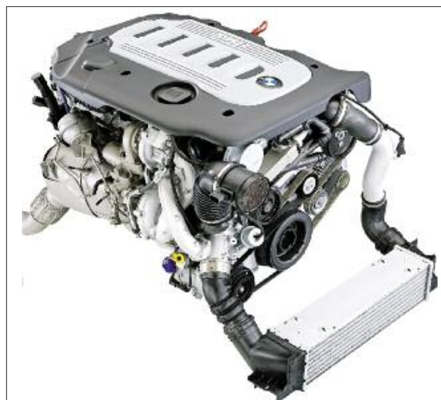
Motor de ciclo Diesel de 3.0 litros, 6 cilindros con doble turbo-intercooler, inyectores con tecnología piezoeléctrica, inyección de gasoil de alta presión “Common rail”, y block cilindros en aluminio – BMW.
