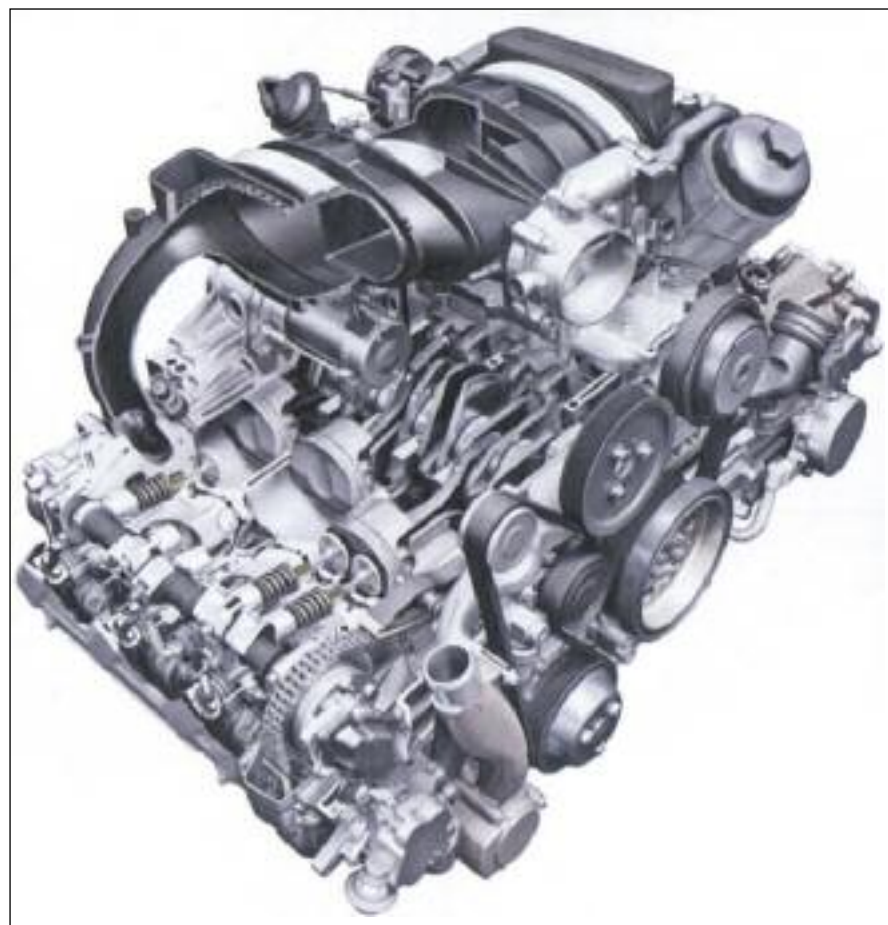
Motor 6 cilindros opuestos, con una potencia de 345 CV y un par motor máximo de 390 Nm; la relación de compresión es de 12,8 a 1.
