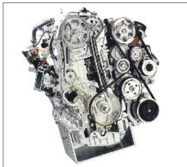
Detalle del motor Honda Diesel 2.2 i-CDTi compacto y liviano, de 4 cilindros con inyección directa y turbo Garrett Honeywell-TGV con intercooler, recirculación de los gases de escape (EGR) y catalizador de 3 vías (oxidante + reductor) con temperatura ideal de 400 grados C.
