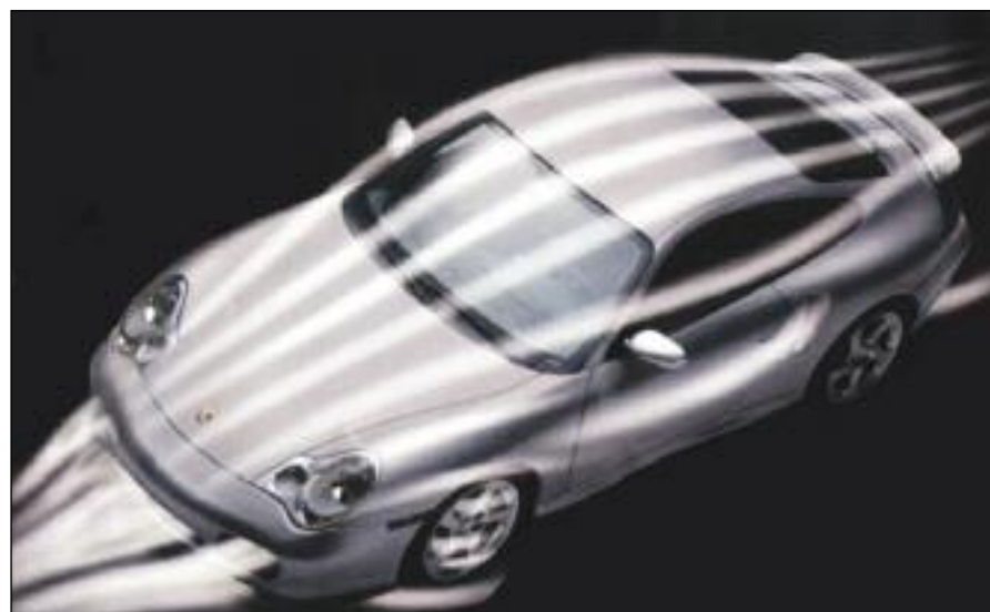
El coeficiente Cx de penetración, es un factor de forma que indica cuánto de eficiente es el vehículo, en pasar a través del fluido, con la sección frontal – S-Porsche.
