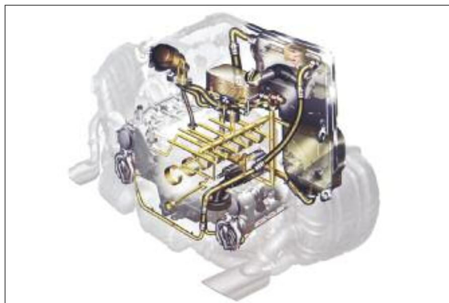
Circuito de lubricación, de un motor de 3,6 litros de 6 cilindros opuestos boxer con doble árbol de levas a la cabeza por banco de cilindros y 24 válvulas - Porsche GT3.
