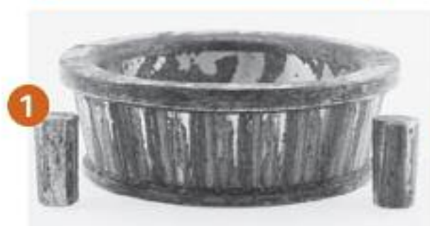
Oxidación Corrosión causada por la humedad o el agua, formando pequeñas cavidades.
