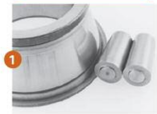
Desgaste abrasivo Contaminación por polvo abrasivo.
