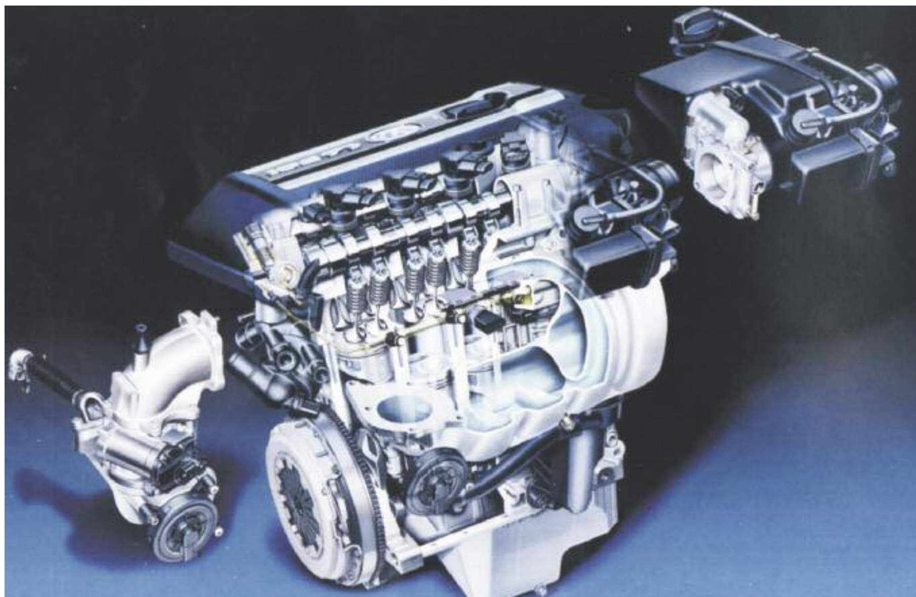
Motor con inyección directa de nafta/gasolina de 4 cilindros en línea, 1.4 litros FSI-Volkswagen.
