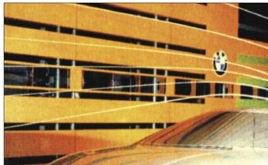
Trayectoria de filetes, de un “Concept car” en el túnel de viento, con las ruedas posteriores carenadas – BMW.
