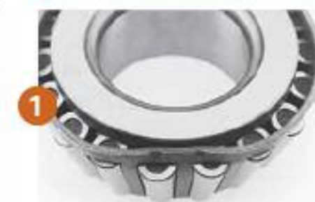
Deformación del soporte del rodillo Instalación incorrecta o daños por golpes.
