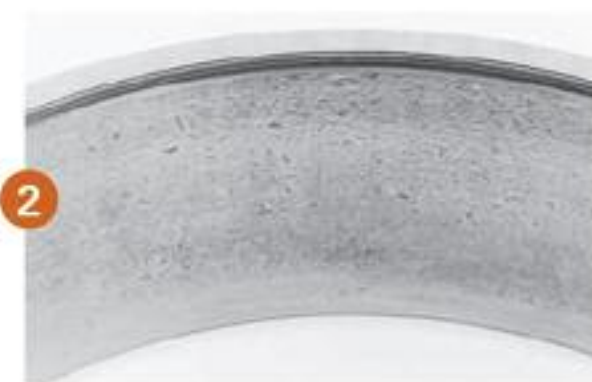
Escoriaciones Fragmentos de metal de otros componentes, un sellado inadecuado y un mantenimiento pobre.
