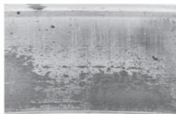
Micro descamación debido al delgado espesor del lubricante asociado a cargas altas/bajas velocidades o altas temperaturas.
