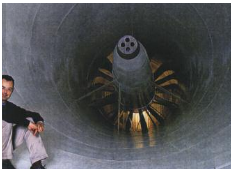
El túnel de viento es una sala en la cual se hace pasar un flujo rápido de aire, a través de un vehículo real o de uno a escala, con el fin de recopilar datos aerodinámicos.
