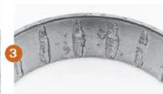
Líneas de descamación Líneas de descamación espaciadas por los rodillos, en cojinetes mantenidos en servicio después de un fallo de corrosión.
