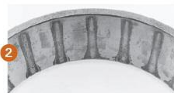
Manchas Manchas superficiales, sin corrosión significativa, asociado con la humedad.
