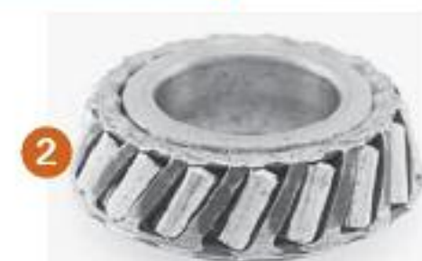
Bloqueo e inclinación de los rodillos Compresión del anillo portador del rodillo en la instalación o interferencia durante su funcionamiento.
