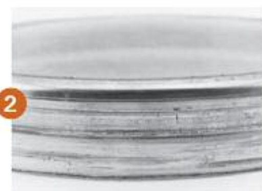
Cubierta suelta Instalado con espacio libre del cubo de la rueda girando, la cubierta gira en falso.
