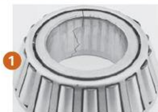
Daño en el agujero del cono Fracturas de cono por eje excéntrico y por encima de la medida.
