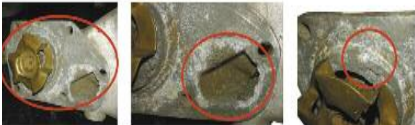
Ejemplos de bomba de agua con efectos de la corrosión-cavitación:
