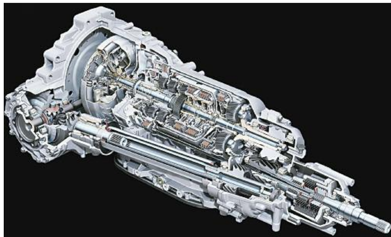
Caja automática en corte del Mercedes Benz S400 Hybrid
