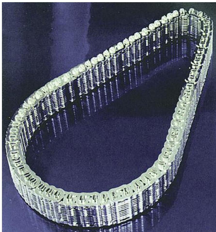
De todos los componentes, la cadena de transmisión es la joya técnica. Está compuesta de 1.025 plaquetas y 150 ejes móviles que —en el arranque— son sometidos a una fuerza de 8 toneladas —LuK.
