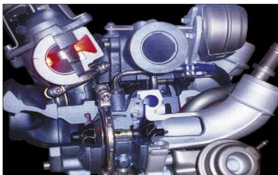
Turbos de doble etapa paralelos y secuenciales. Son dos pequeños turbosobrealimentadores, unidos para máxima eficacia, de los motores Diesel, y desarrollados para el propulsor de 2,2 litros HDi del Grupo PSA - Honeywell Garrett.
