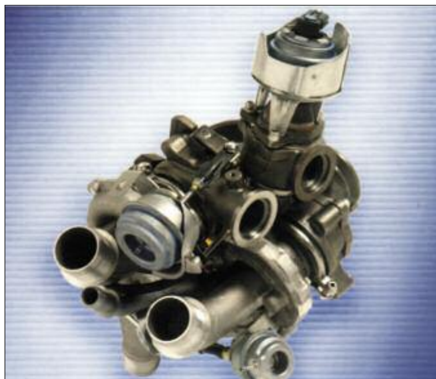
Sistema de sobrealimentación, con “doble turbo secuencial paralelo”, para un motor Diesel de 4 cilindros en línea. Un turbo pequeño –de inercia reducida– se utiliza en los bajos regímenes, el mismo es reemplazado a las 2.700 rpm por otro turbo de las mismas dimensiones, todo controlado electrónicamente – Ford/Grupo PSA/Honeywell.
