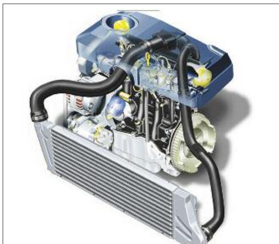
Motor Diesel de 1,5 litros de 100 CV con turbo de geometría variable (TGV) e intercooler, sistema de inyección directa “Common rail” de tipo esférico, y sistema anticontaminación – Renault.
