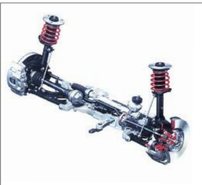
Sistema de suspensión McPherson, delantera, montado sobre un subchasis liviano de aluminio - Audi.
