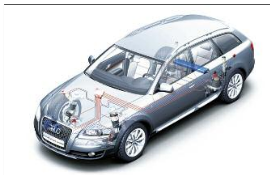
La suspensión activa se adapta en forma automática e instantánea, al ángulo de dirección, a la velocidad, a la carga, y al estado de la superficie o del suelo - Audi.
