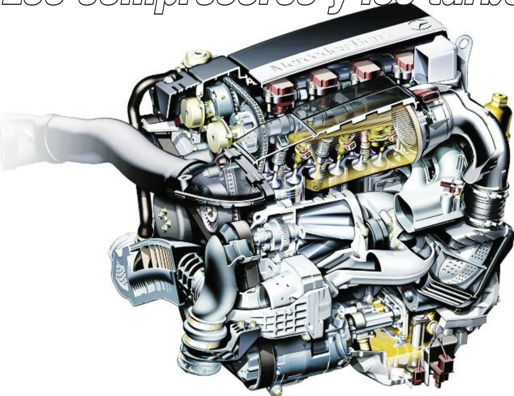
Motor en corte de 4 cilindros en línea, con compresor centrífugo M. Benz C-Class Estate.
