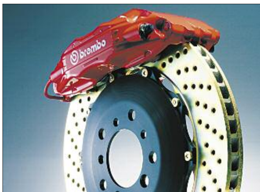
Los vehículos deportivos y de competición utilizan, desde hace un tiempo, discos de freno ventilados y perforados – Brembo.
