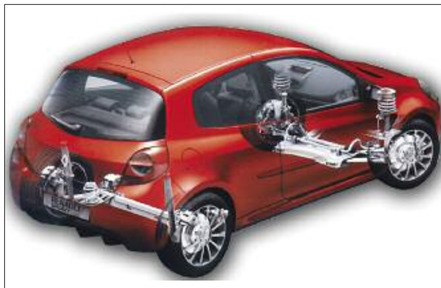
Transparencia de un automóvil, con suspensión delantera y trasera y sus componentes - Renault Clio Sport.
