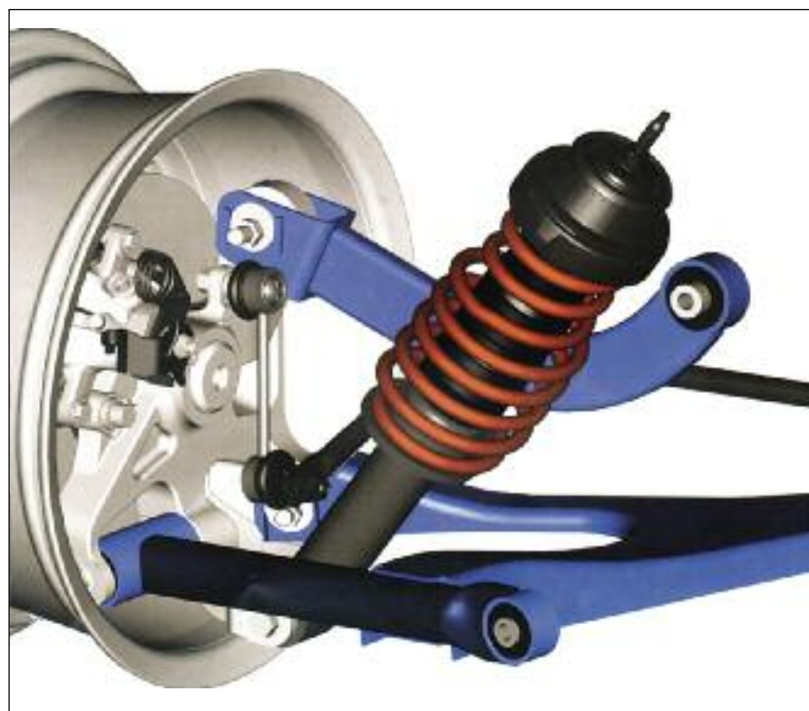
Transparencia de un automóvil, con suspensión delantera y trasera y sus componentes - Renault Clio Sport.
