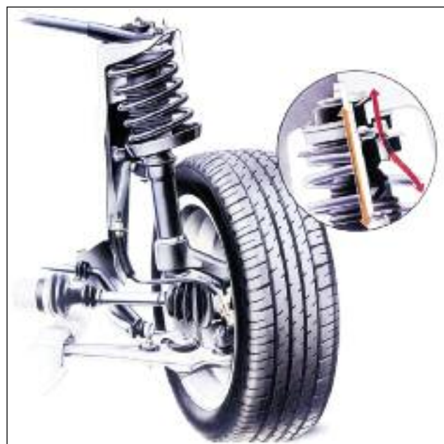
El sistema McPherson incorpora amortiguadores de gas de acción directa, y resorte de largo recorrido. Detalle del apoyo del resorte/amortiguador superior, de diseño exclusivo - Saab.
