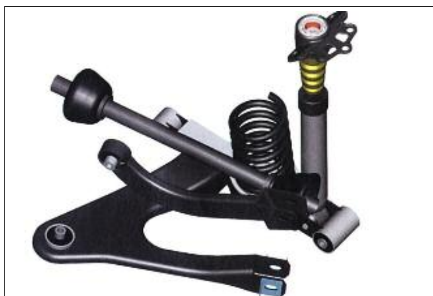
Brazo inferior en U, resorte helicoidal, amortiguador, y brazo superior simple.
