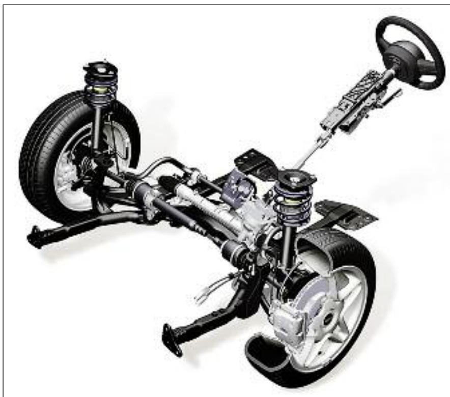
Tren delantero y suspensión del conocido MINI del grupo BMW.
