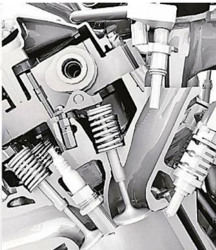
La inyección doble fue usada en 2006, en el motor de la industria japonesa Lexus. Cámara de combustión y dos inyectores (directa e indirecta).
