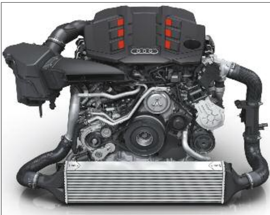
Motor V8 turbo-intercooler con consumo reducido, buenas prestaciones, y emisiones reducidas - Audi.
