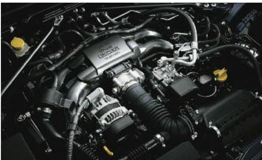
Motor en cofre con doble inyección de nafta Subaru-Toyota D-45 boxer.
