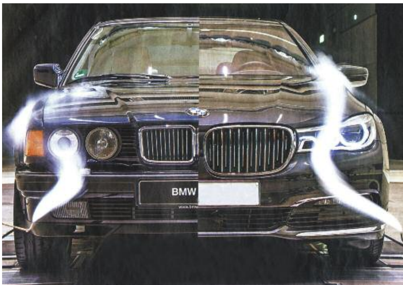
Automóvil sometido al túnel de viento, en este caso, el piso puede simular el movimiento del mismo. – BMW.
