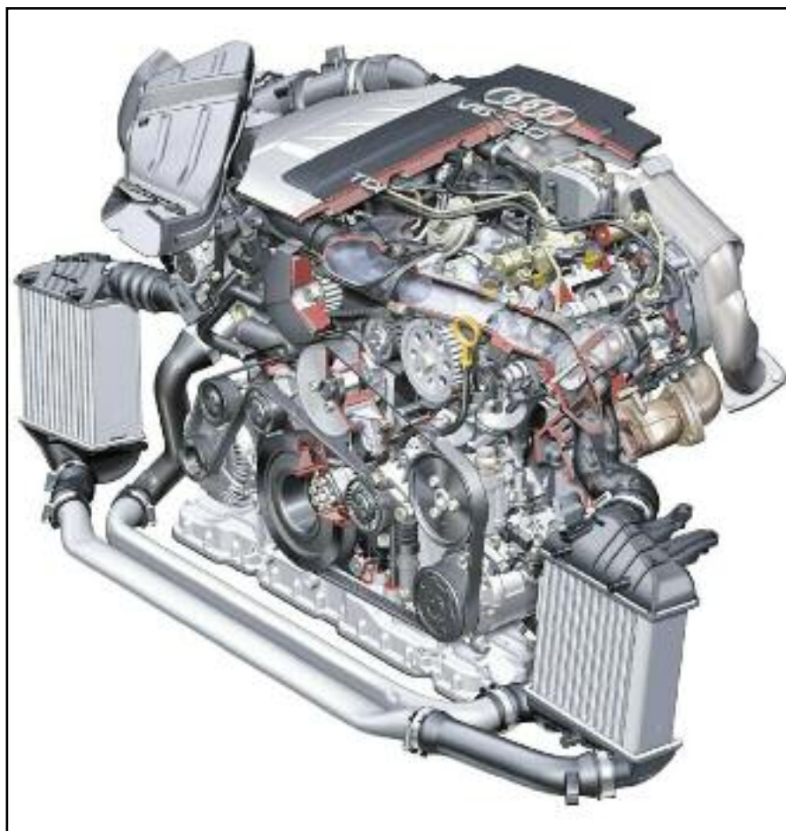
Diseño de motores en V, en este caso de 6 cilindros y 3.0 litros TDI. "Common rail".
