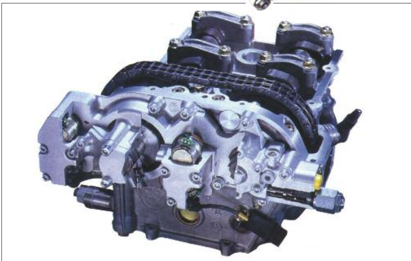
Motor de 6 cilindros en línea de 3.201 cm 3 , con una potencia de 320 CV. a 7.400 rpm. (más de 100 CV. por litro), con un par motor de 35,7 Nm. a 3.250 rpm. con sistema DOBLE VANOS (para admisión y escape) es decir dos variadores de fase, para incrementar el par motor en los regímenes bajos e intermedios.
