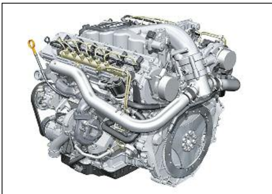
Sistema "Common rail" en detalle, de un motor V12 TDI - Audi.
