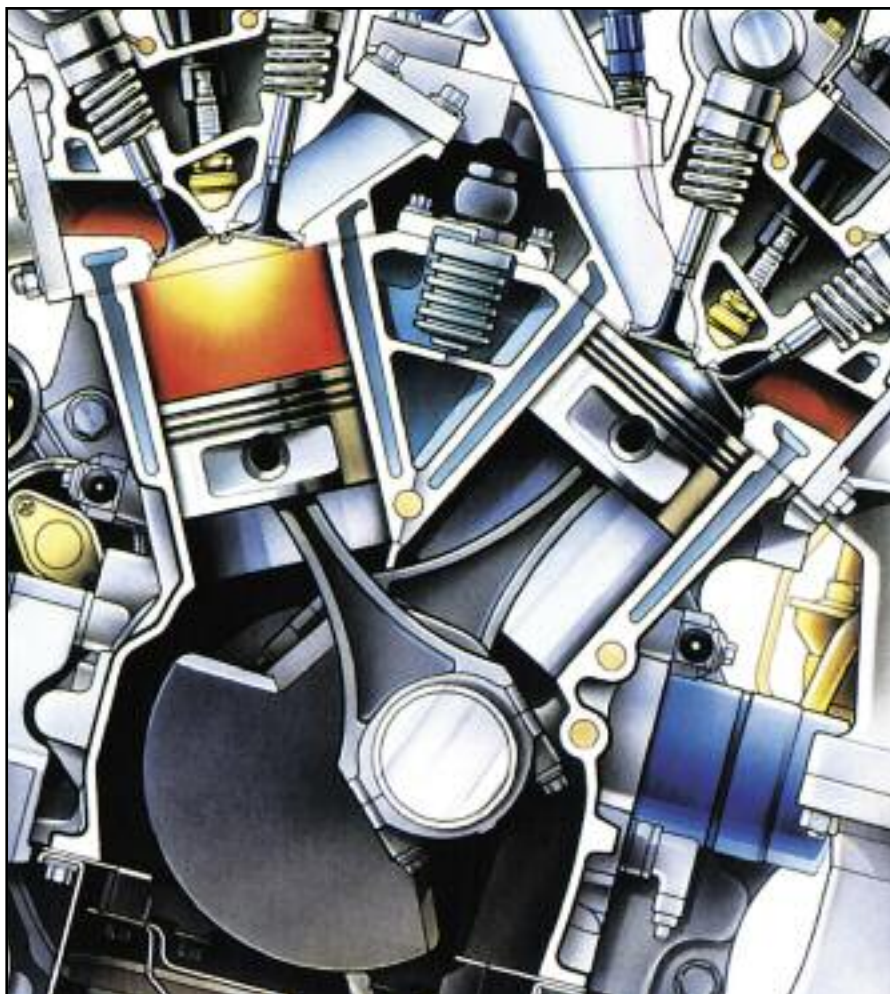
Motor en corte transversal, donde se observan las bielas de dos cilindros, que soportan fuerzas de inercia, centrífuga, y los de tracción estática- Saab.
