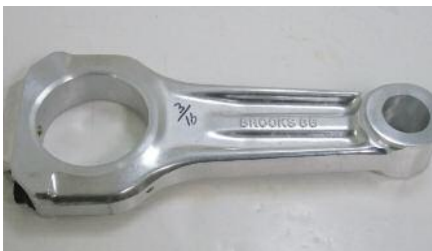
Entre los metales usados en la construcción de una biela moderna, esta el aluminio estampado.
