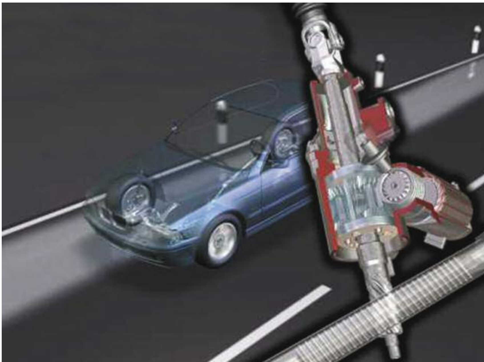
Sistema “Active Steering”, que logra que el guiado de las ruedas, se adapte en forma continua a cada circunstancia de conducción sin pérdida de sensibilidad.
