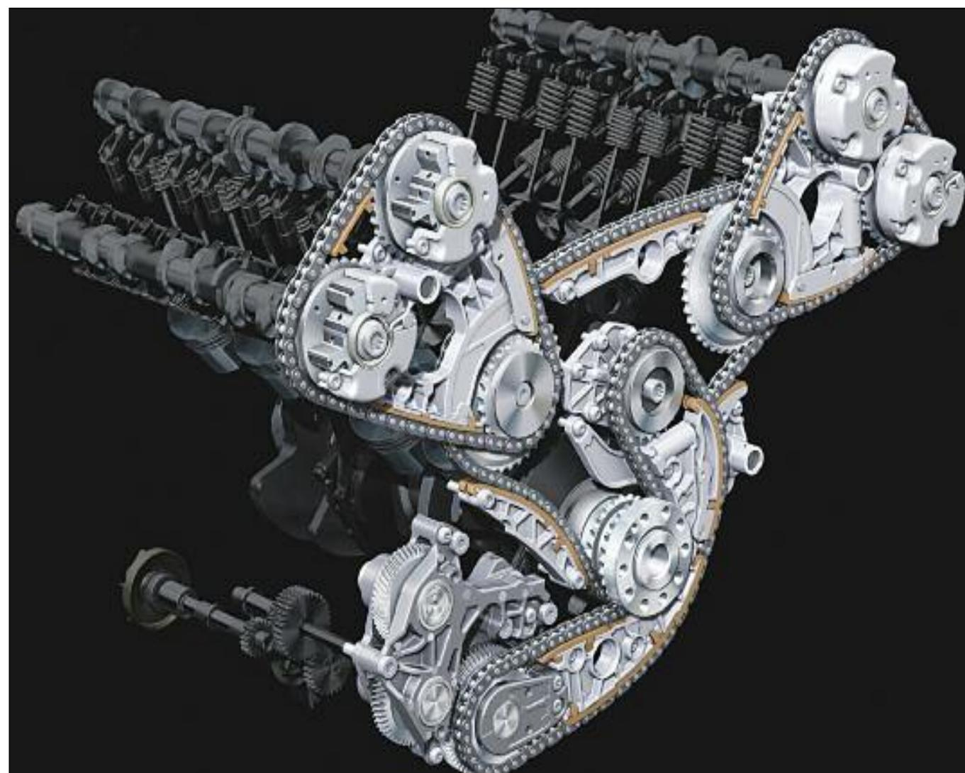
**Componentes de la distribución por cadena de un motor V8, con sistema variable de válvulas.**
