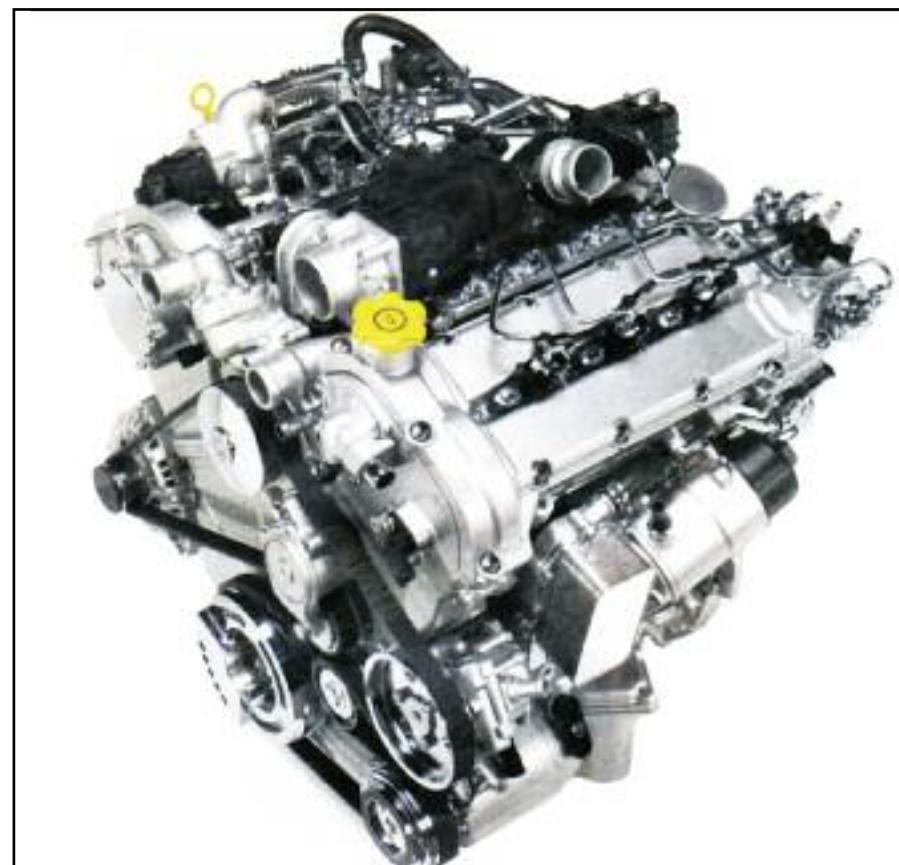
**Motor Diesel V6 de 3 litros de GM. que equipa a los modelos Cadillac, con bujías incandescentes de pre-poscombustión, que miden directamente la presión de combustión. Con esta información, la ECU puede modificar el momento de inyección del gasoil.**
