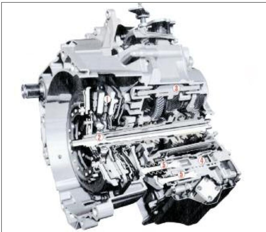
**Caja DSG de 7 marchas con doble embrague en seco (1) que transmite la potencia a los ejes (2) uno dentro del otro, el cambio es hidráulico y son los engranajes deslizables (3) los que comandan las marchas. Una unidad de control hidráulica (4) coordina todo el proceso, los reguladores de los embragues hidráulicos (5) actúan desde la parte baja del conjunto –VW.**
