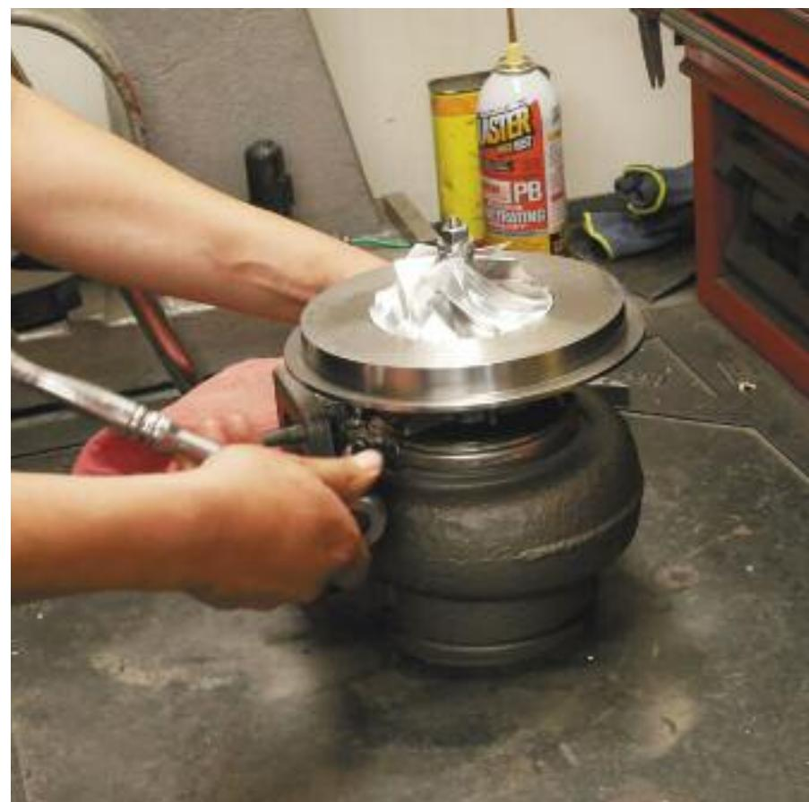
**Actualmente los turbos son fabricados “al estado del arte”, recurriendo a una tecnología aeroespacial, y es vital para su mantenimiento; comprobar el desgaste de los cojinetes y la limpieza de los rotores.**
