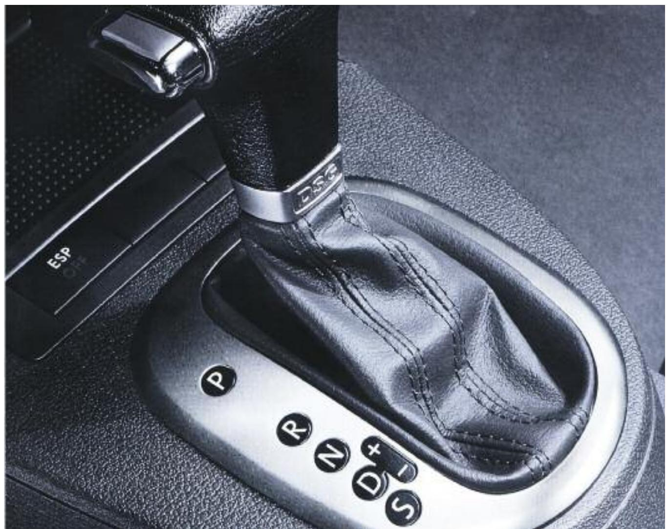
**Palanca selectora de la transmisión DSG de 7 marchas con doble embrague, de funcionamiento similar a una caja automática, con tecla de desbloqueo –VW.**
