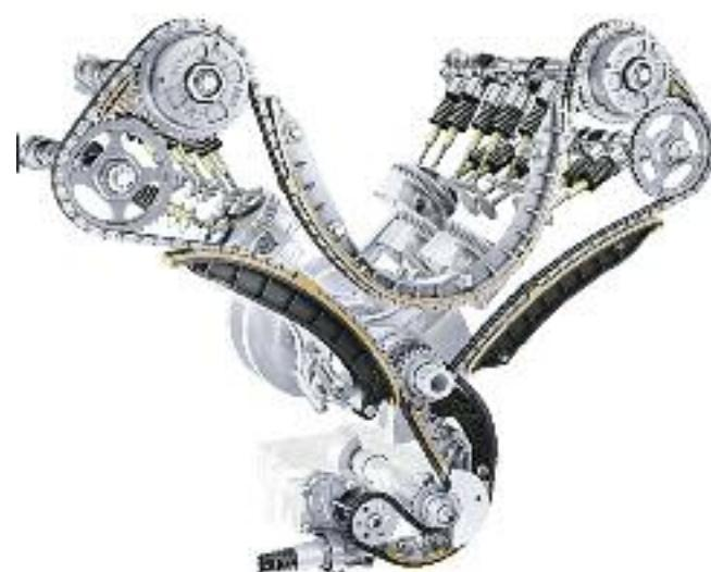
**Corte parcial del motor de 6 cilindros en V con inyección directa de 3.6 litros, y sistema de distribución - Porsche Panamera.**
