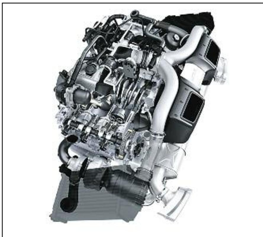
**Motor de inyección directa de nafta/gasolina, de 6 cilindros boxer - Porsche 911 Turbo Cabriolet.**
