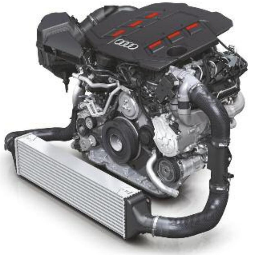
**Motor ciclo Diesel V6 turbo-intercooler - Audi.**
