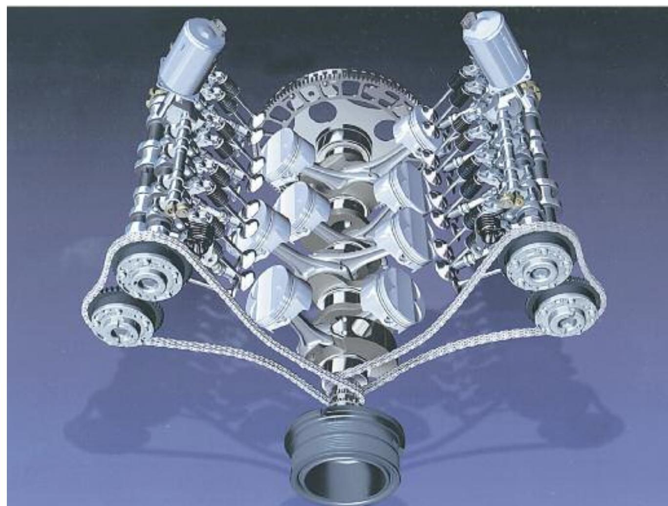
**Parte alternativa/rotativa del motor V8 de 3.6 litros, y accionamiento por cadena del sistema de distribución de doble árbol de levas a la cabeza por cada banco de cilindros. Posee 32 válvulas y tecnología Bi-Vanos con Valvetronic – BMW/735 i.**
