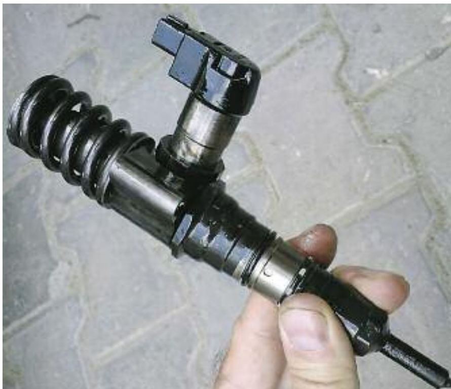
El inyector/bomba reagrupa en un solo cuerpo, una bomba de alta presión, una electroválvula de comando, y un inyector.
