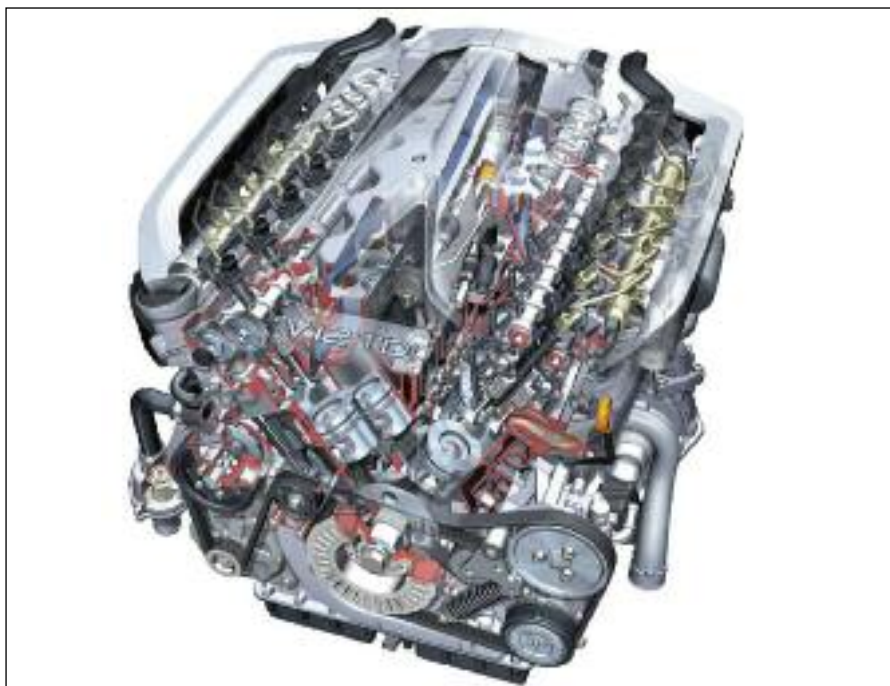
Los motores multicilindros, en donde el peso y las dimensiones son importantes - Motor Diesel V12 TDI - Audi.
