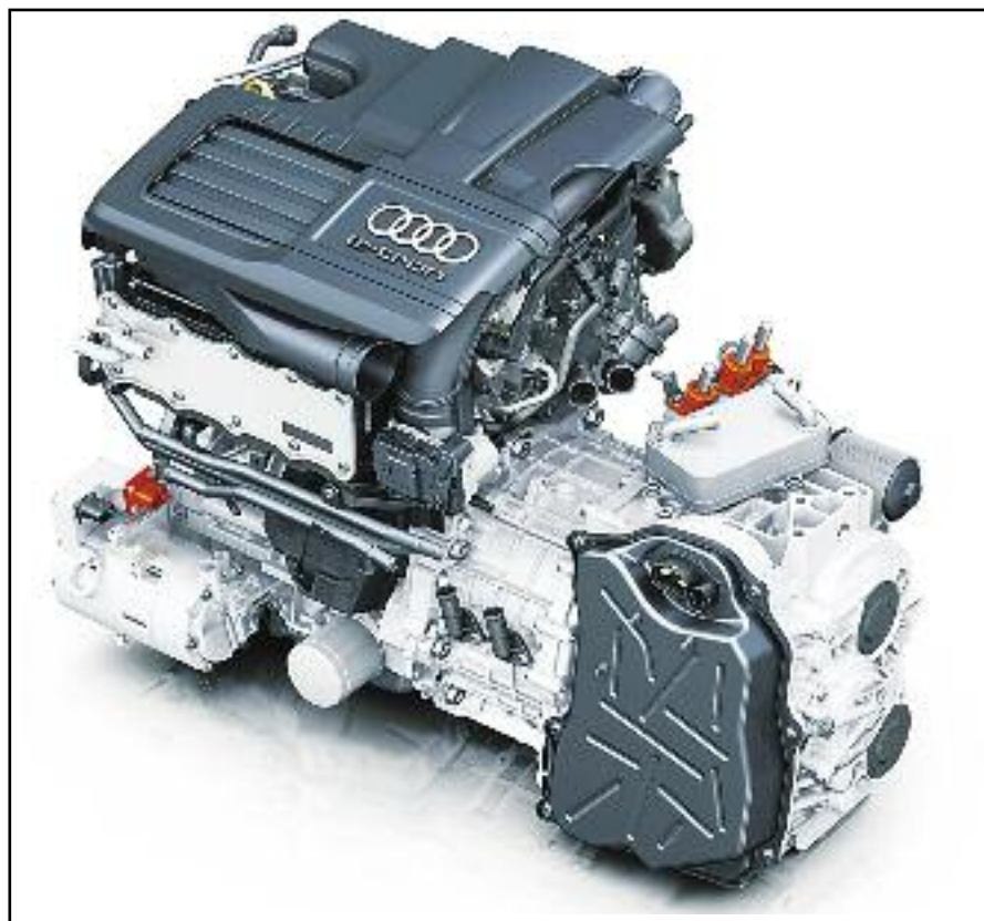
Adaptación técnica para combinar motores térmicos y eléctricos, y desarrollar una tecnología híbrida - Audi.
