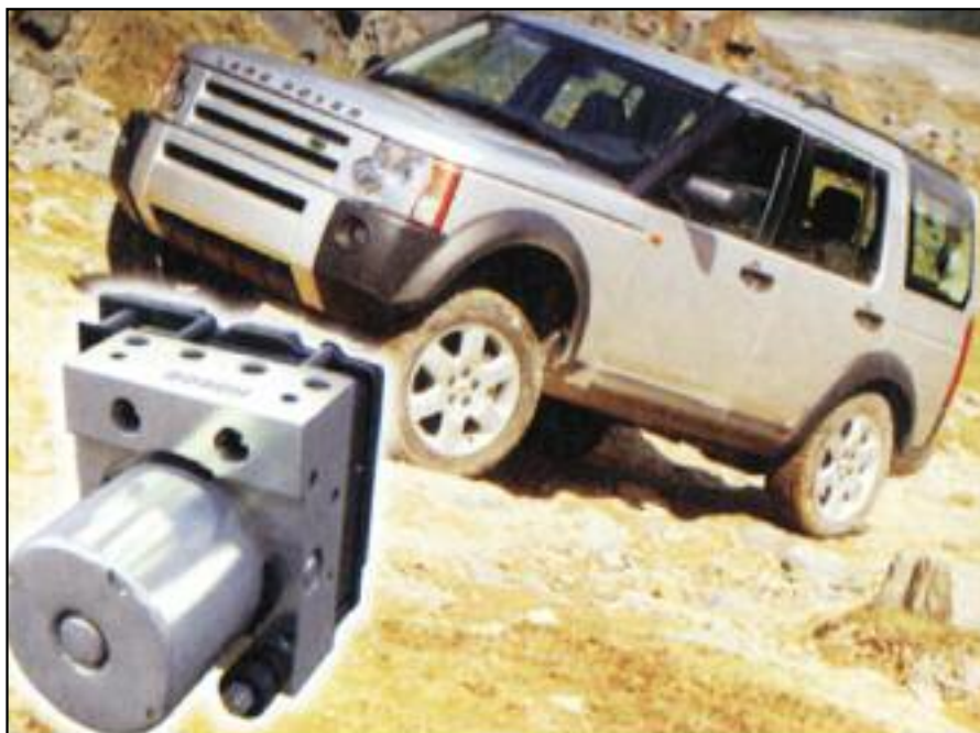
El montaje de un sistema ESP de última generación, permite tener un efectivo sistema Terrain Response. El ESP se adapta al tipo de terreno seleccionado con efectividad – Land Rover.
