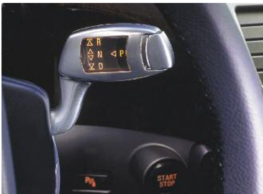
En esta caja automática la palanca de selección se encuentra en la columna de dirección. Para pasar del "modo" automático al deportivo o manual, se debe pulsar una tecla (SMD) ubicada en el volante de dirección – BMW.
