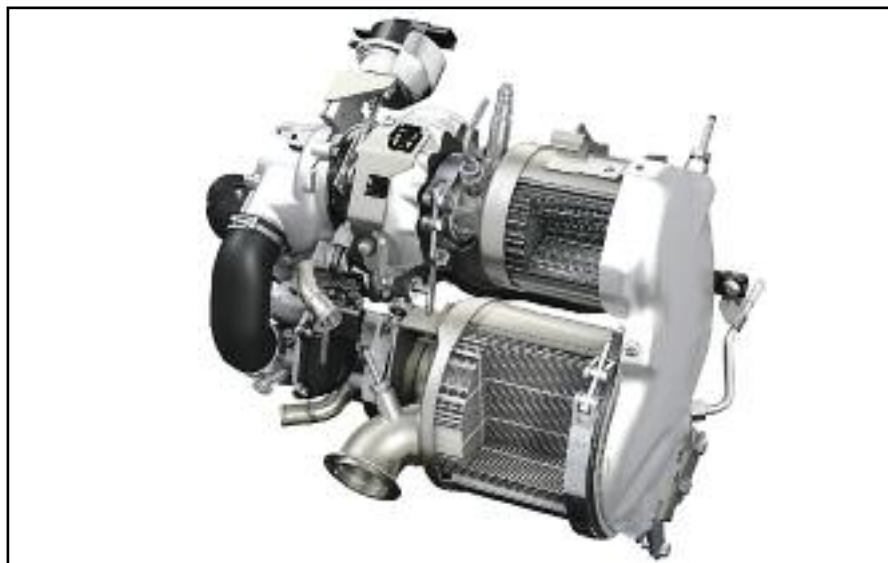
Los sistemas de post-tratamiento, tienen influencia en el rendimiento del motor, debido al aumento de la contrapresión en el escape - Volkswagen.
