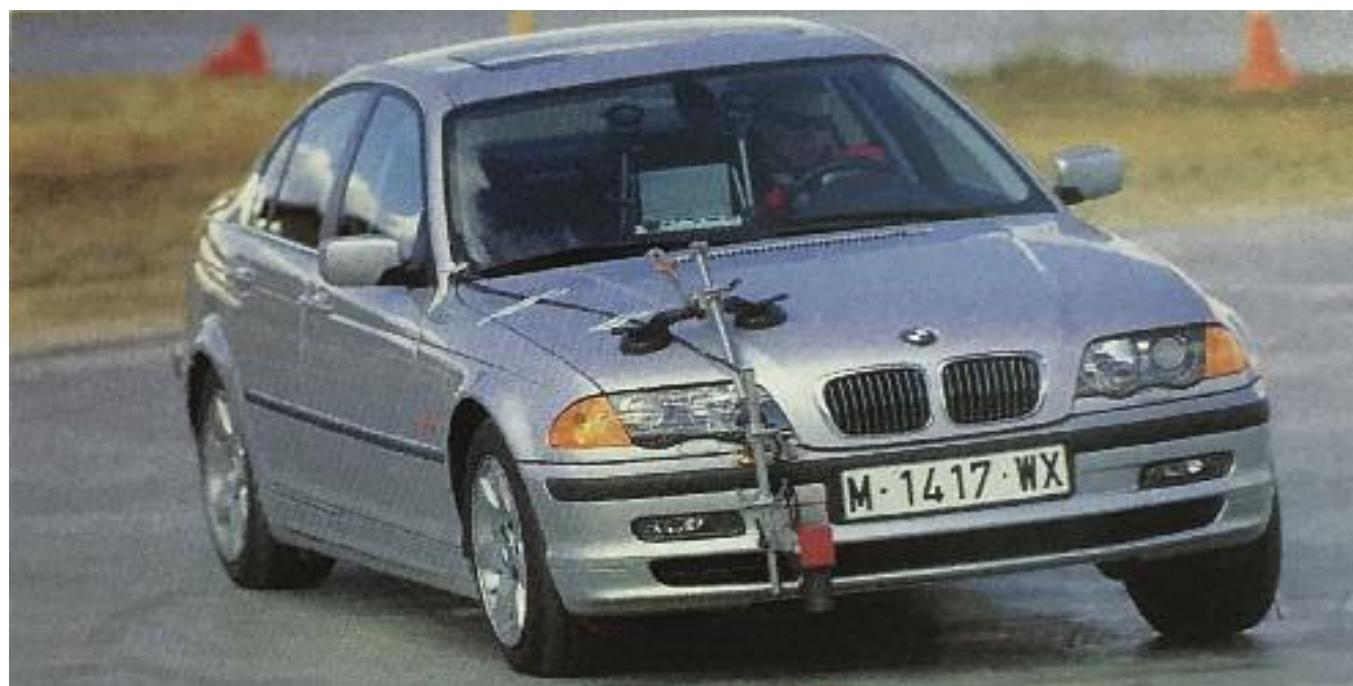
Pruebas efectuadas en superficies secas y mojadas, para comprobar el rendimiento del ESP. –con y sin sistema aplicado– respecto a la estabilidad y al comportamiento del automóvil.
