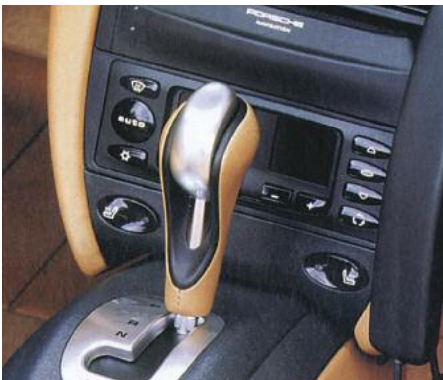
Detalle de la palanca selectora de la transmisión automática Tiptronic S, un concepto para dos sistemas de cambios de velocidades; por un lado "manual" M (6 velocidades) y por el otro completamente "automático" D (5 velocidades).- Porsche.
