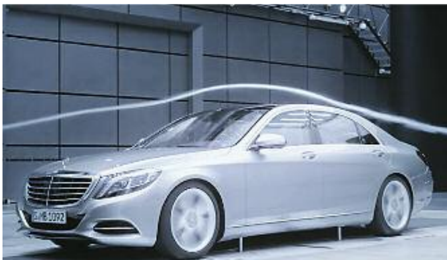
Los resultados del túnel, determinan el comportamiento del automóvil, y los aspectos a mejorar - M. Benz.
