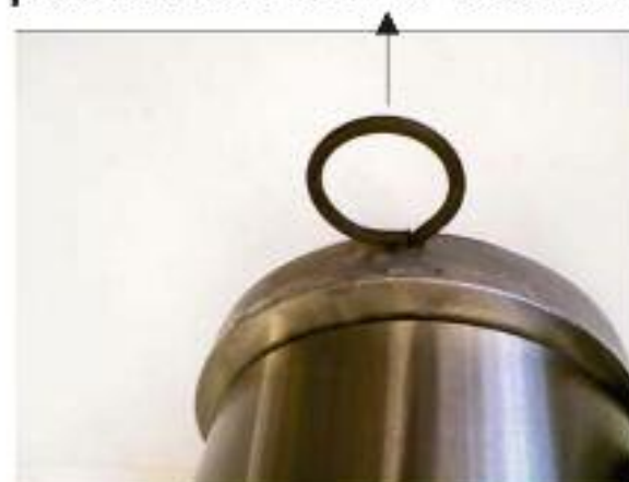
Fig. 3 Variante 2 - Extraer el pasador tras montar la correa
