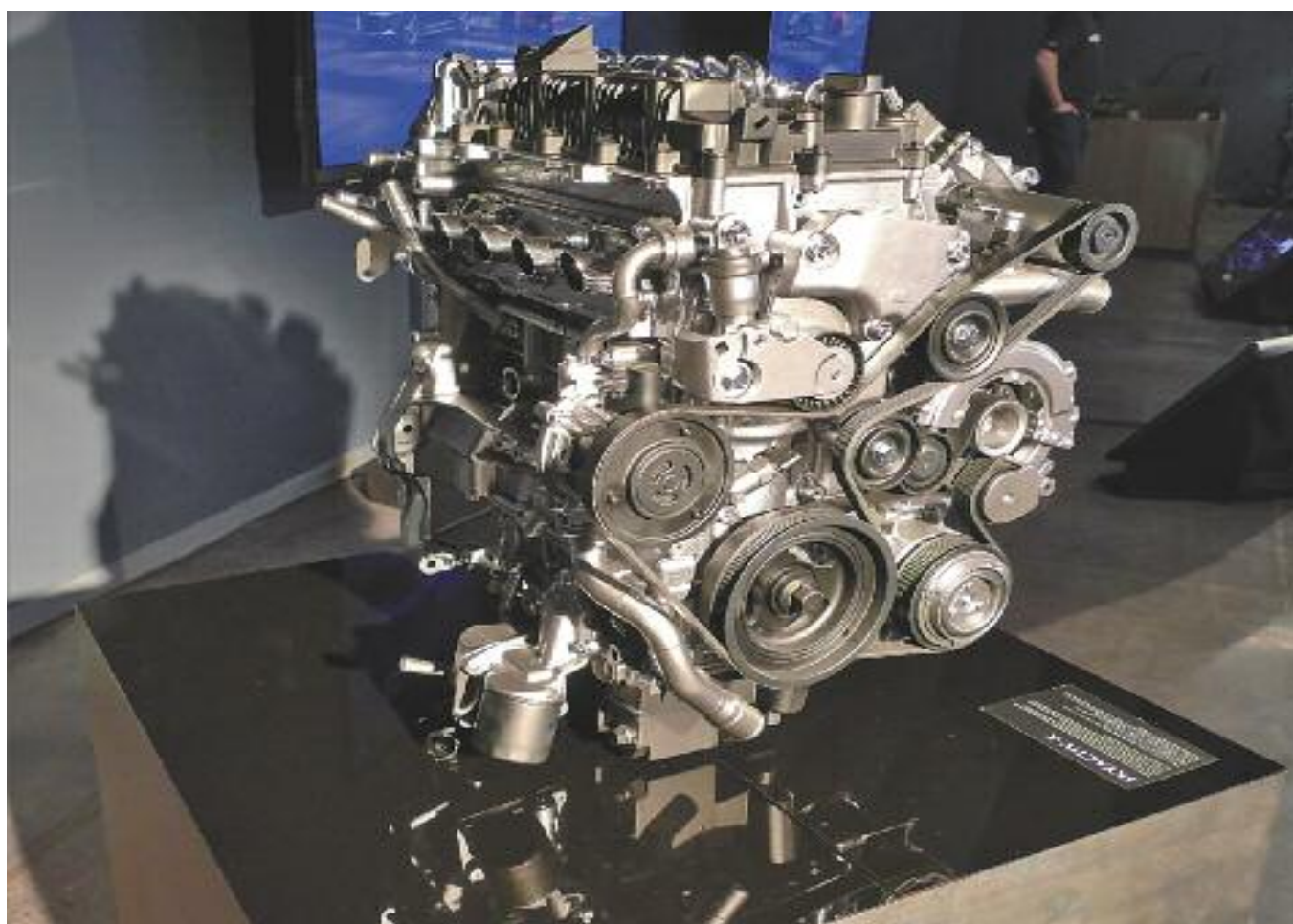
Combinación de un motor térmico (ciclo Diesel), con uno de encendido por chispa (ciclo Otto) – Motor Mazda SPCCI
