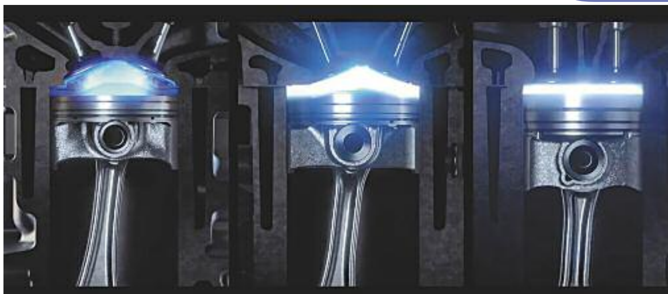
Principio de funcionamiento del motor SPCCI explicado con tres cámaras de combustión, Sistema SKYACTIV-X.
