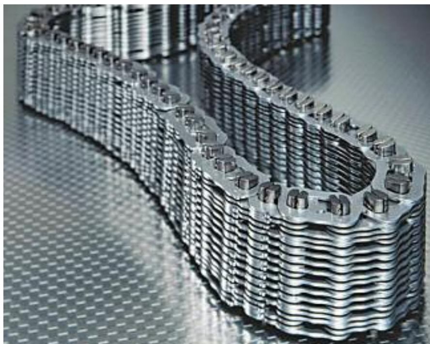
Cadena metálica de especial diseño, utilizada en la conexión de las 2 poleas, compuesta por más de 1.000 láminas y por 75 pernos. Puede soportar tensiones muy elevadas - Audi.
