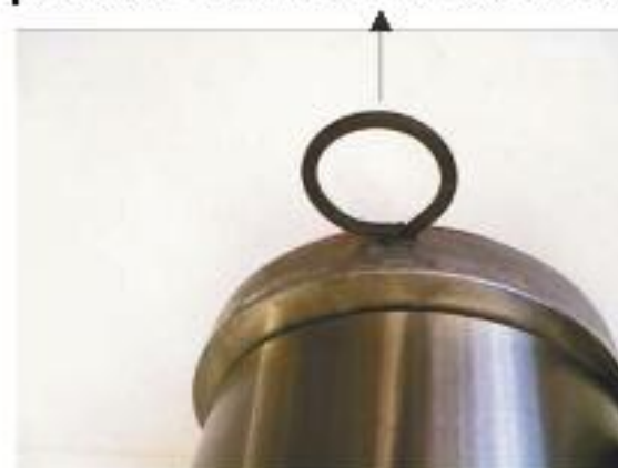
Fig. 3 Variante 2 - Extraer el pasador tras montar la correa
