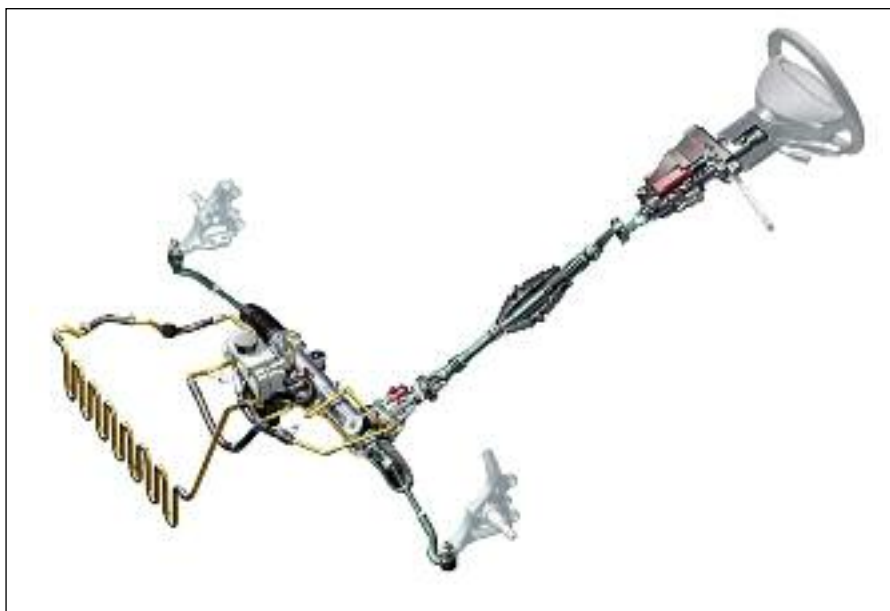
Mecanismo de dirección asistida hidráulicamente, que normalmente está compuesto por: Un depósito de fluido, una bomba, una caja de dirección y una serie de cañerías o canalizaciones (circulación del fluido) - MBenz.
