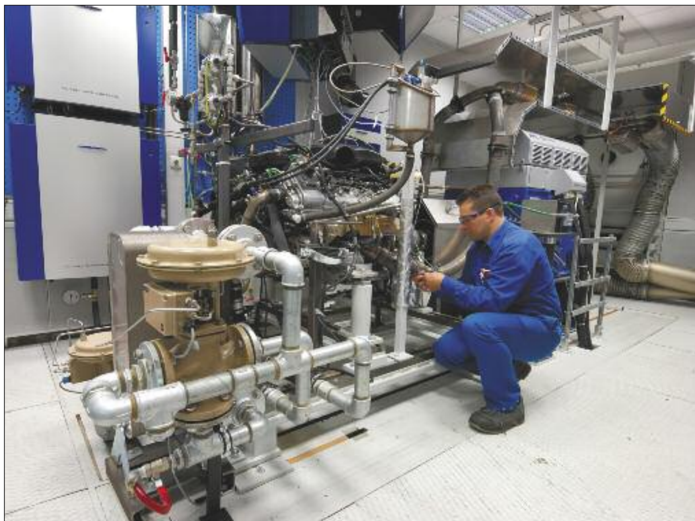
Sala de ensayo: motor alimentado con gas natural sobre banco dinamométrico. —M.Benz.
