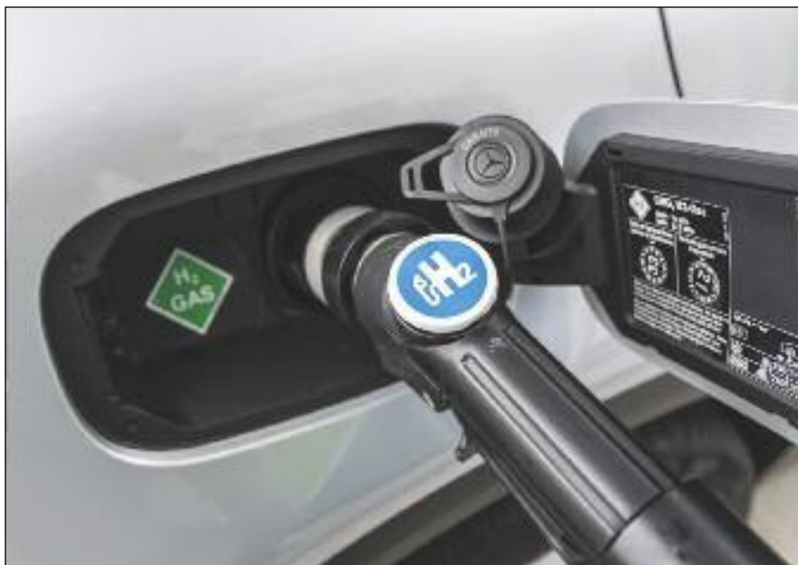
Boca de carga de Hidrógeno 2 en el modelo GLC F-Cell (Célula de Combustible).
