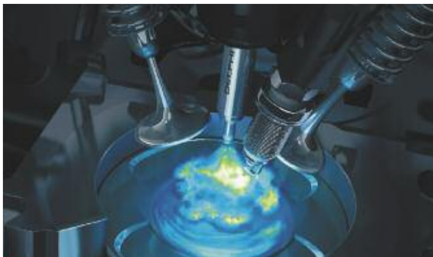
Proceso de combustión en cámara, con inyección directa de nafta de alta presión - Delphi.
