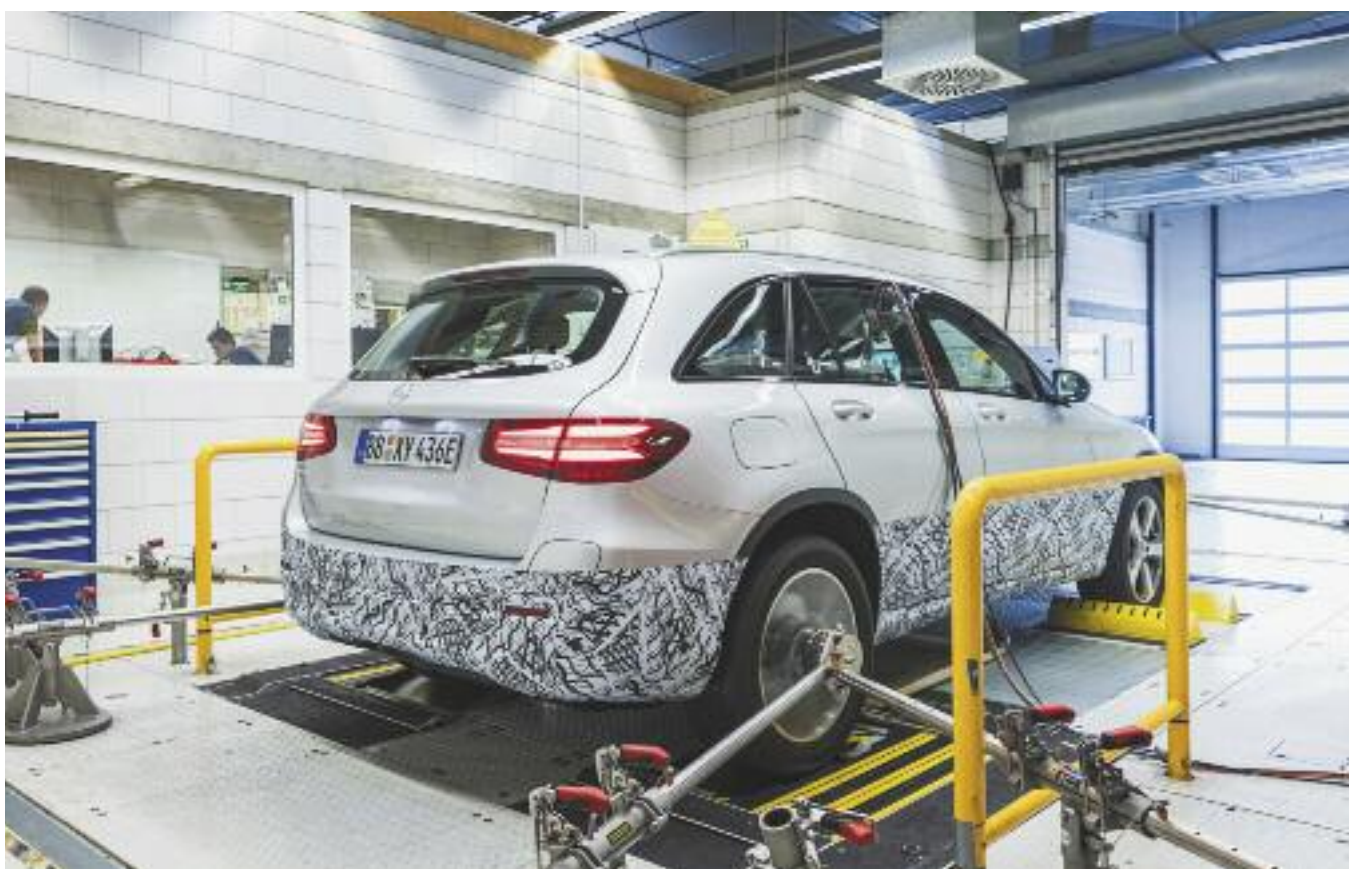
El modelo Mercedes Benz a Hidrogeno Híbrido Plug-in en banco de rodillos (Sala de ensayos). GLC F-Cell.
