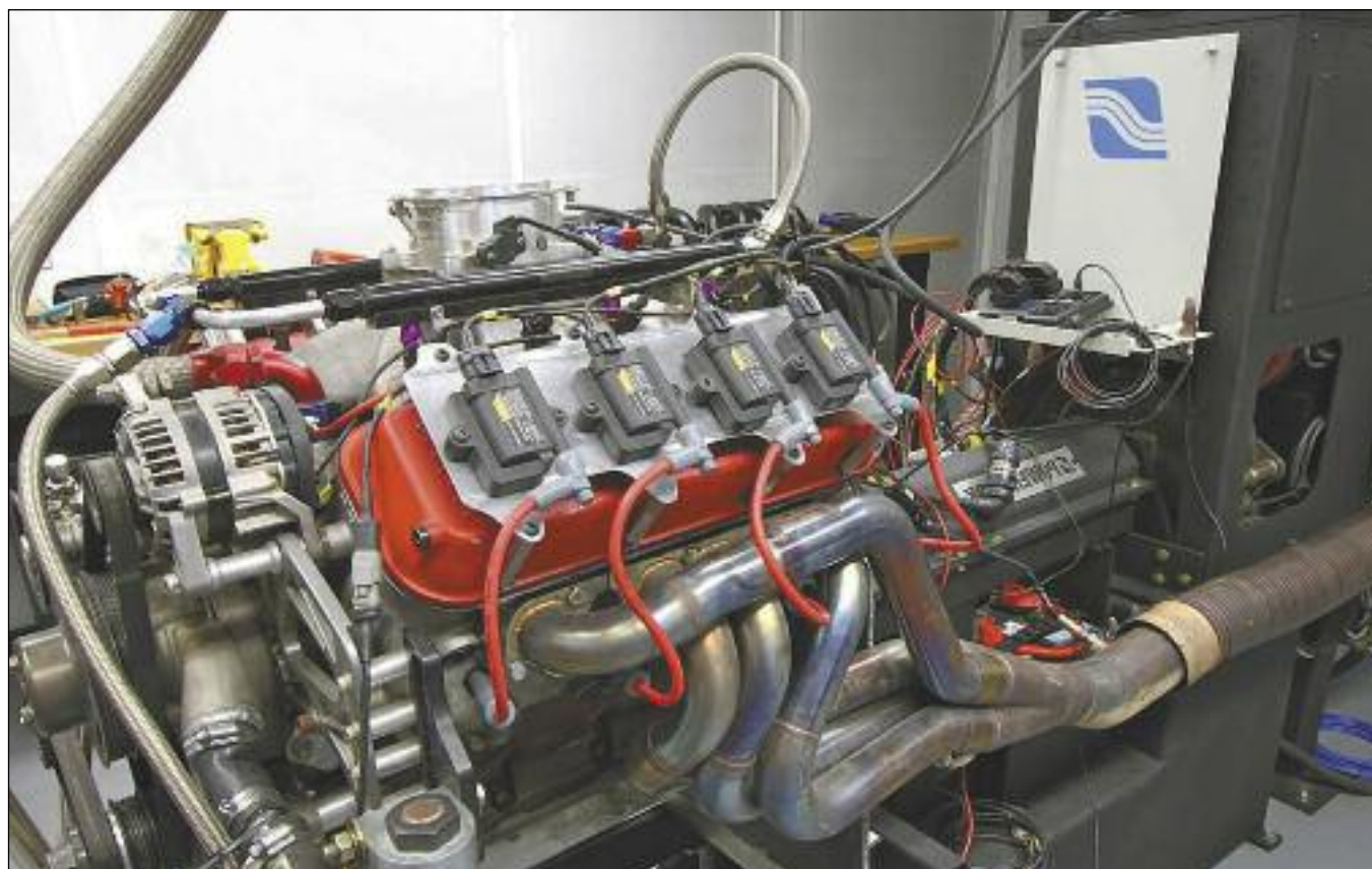
Sala de ensayo: motor alimentado con gas natural sobre banco dinamométrico. —M.Benz.
