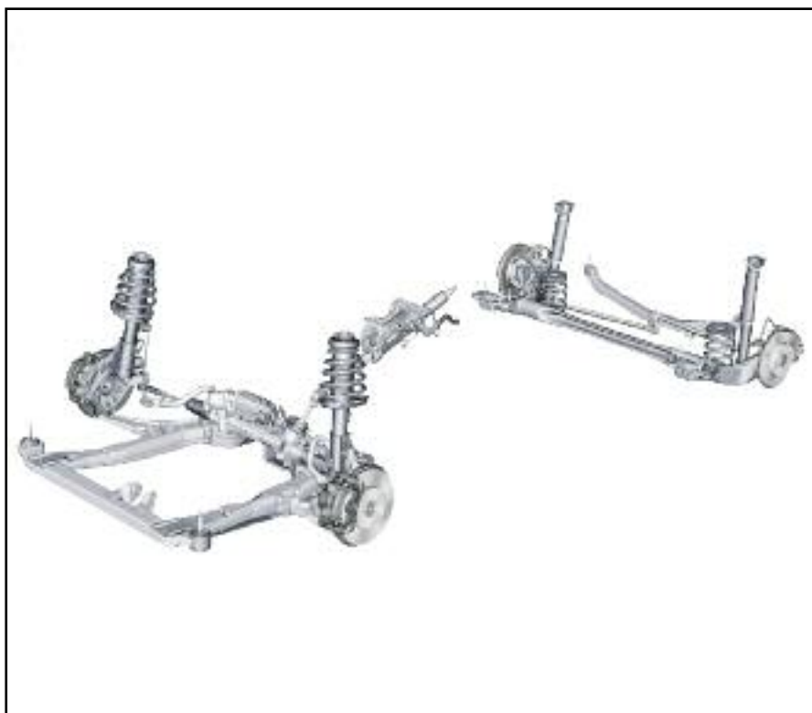
La masa no suspendida, está formada por las ruedas y por todo lo que se mueve verticalmente junto a ellos, debajo de la suspensión.
