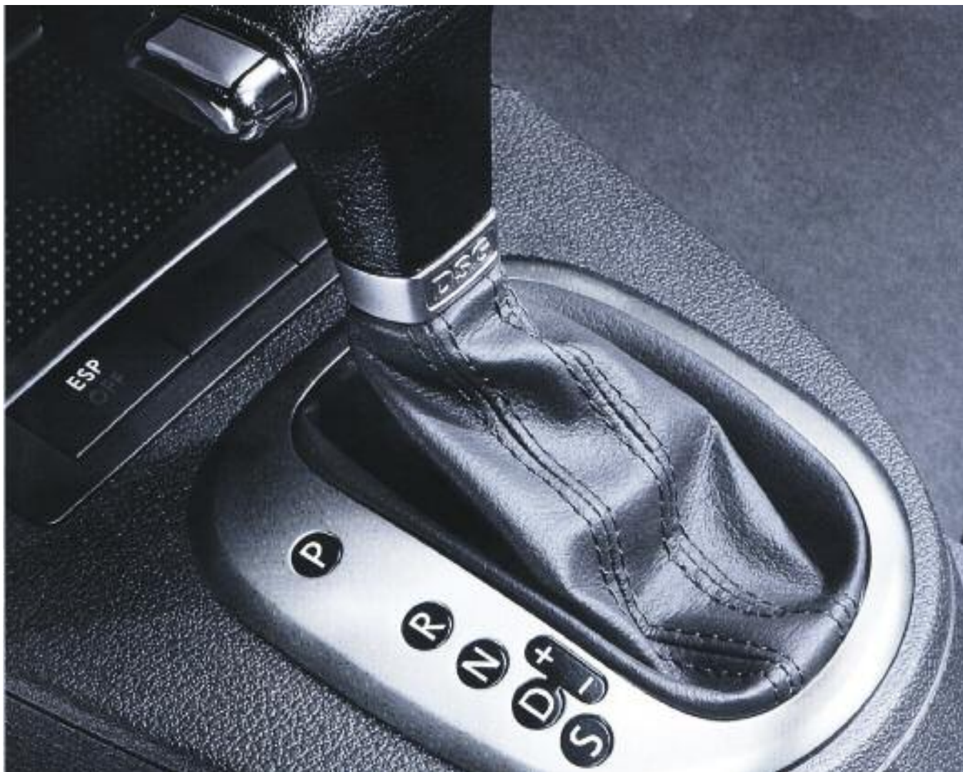
Palanca selectora de la transmisión DSG de 7 marchas con doble embrague, de funcionamiento similar al de una caja automática, con tecla de desbloqueo –VW.
