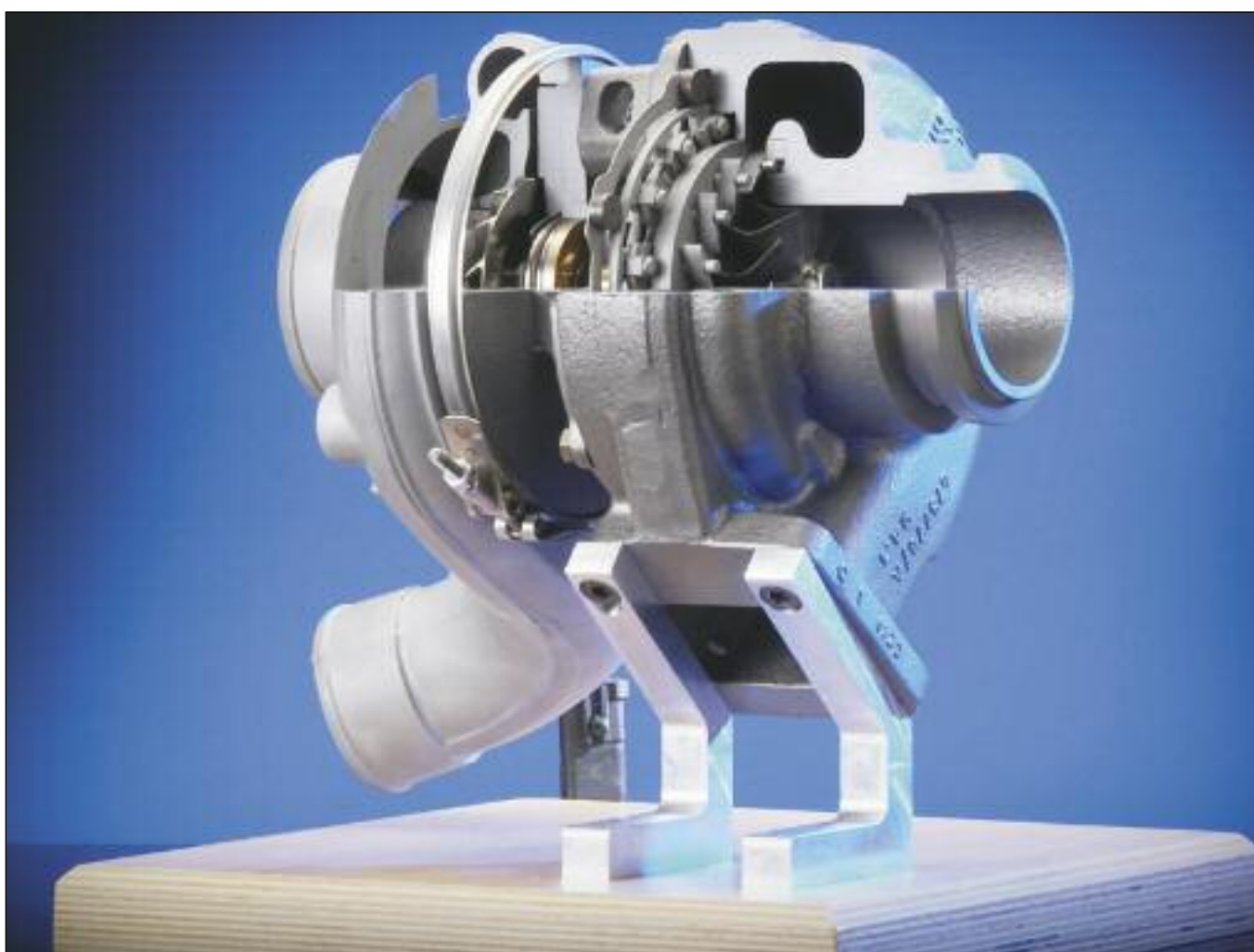
En la actualidad, el turbosobrealimentador del tipo TGV de geometría variable, es utilizado con eficiencia técnica, tanto en motores nafteros como gasoleros – Borg Warner.
