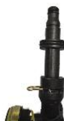
fig. 7 Retirar seguro para que no se dañe el O ring del acople
