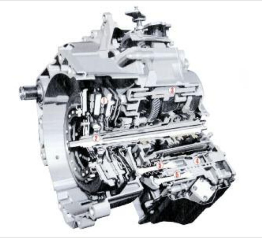
Caja DSG de 7 marchas con doble embrague en seco (1) que transmite la potencia a los ejes (2) uno dentro del otro, el cambio es hidráulico y son los engranajes deslizables (3) los que comandan las marchas. Una unidad de control hidráulica (4) coordina todo el proceso, los reguladores de los embragues hidráulicos (5) actúan desde la parte baja del conjunto –VW.
