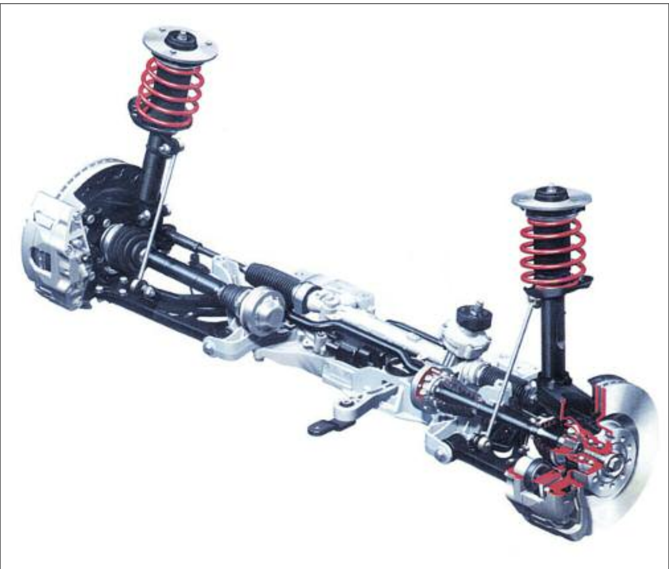
Sistema de suspensión McPherson, delantera, montado sobre un subchasis liviano de aluminio – Audi.
