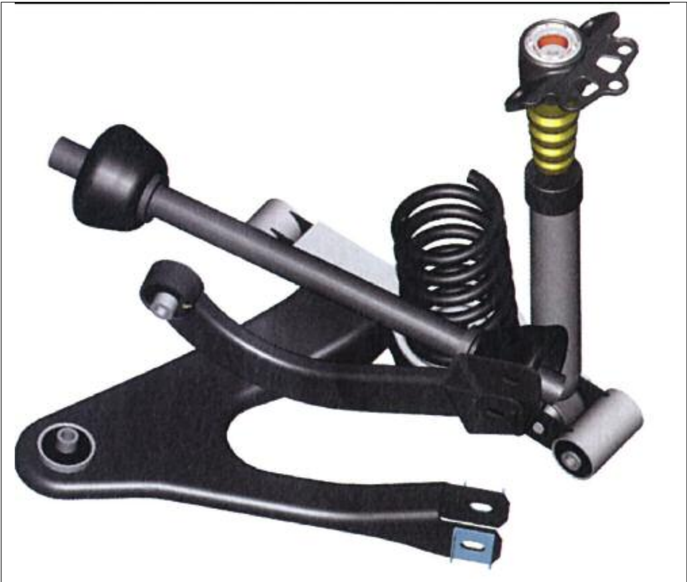
Brazo inferior en U, resorte helicoidal, amortiguador, y brazo superior simple.
