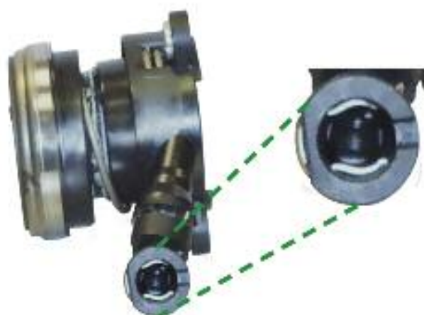
fig. 11 Actuador con fuga, obstruido por no retirar el O ring de la tubería de Equipo Original
