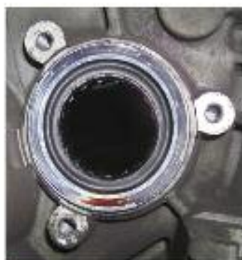
fig. 5 Roscas en la campana de transmisión para la sujeción del actuador y ranura en la campana para el O ring.
