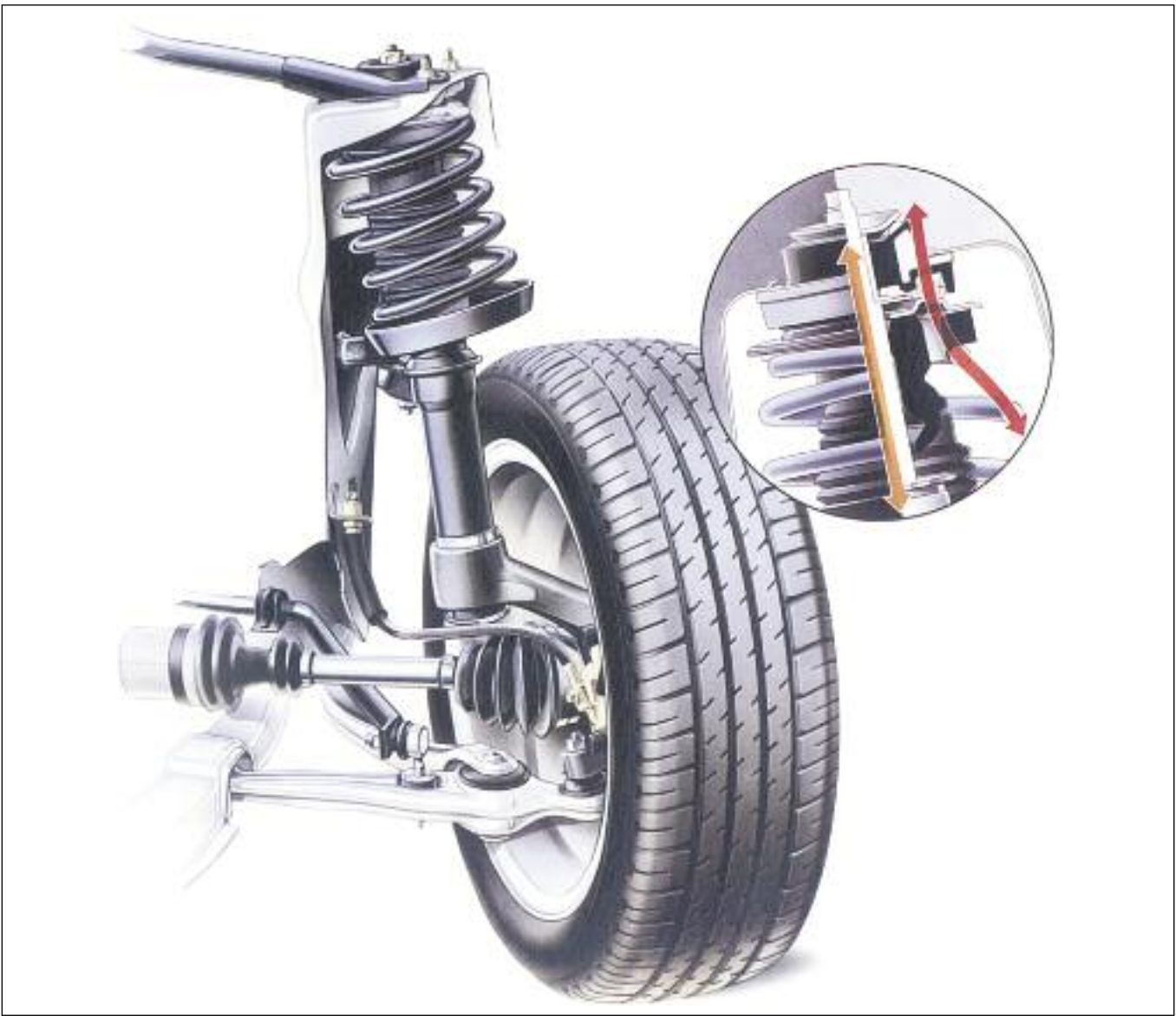
El sistema McPherson incorpora amortiguadores de gas de acción directa, y resorte de largo recorrido. Detalle del apoyo del resorte/amortiguador superior, de diseño exclusivo – Saab.
