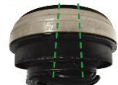
fig. 10 Daño en retén de actuador ocasionado por sobrecarga
