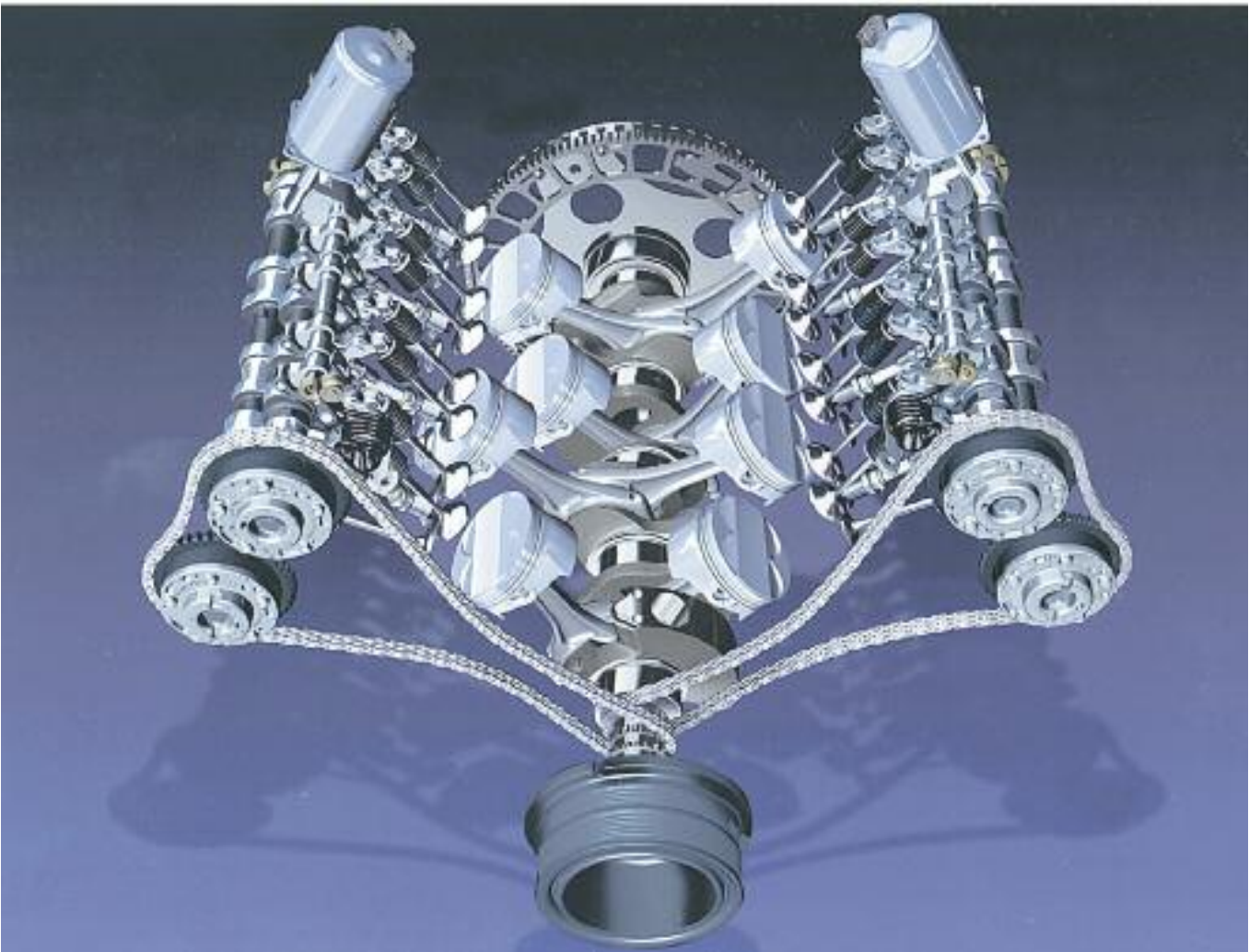
Parte alternativa/rotativa del motor V8 de 3.6 litros, y accionamiento por cadena del sistema de distribución de doble árbol de levas a la cabeza por cada banco de cilindros. Posee 32 válvulas y tecnología Bi-Vanos con Valvetronic – BMW/735 i.
