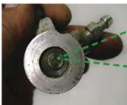
fig. 3 Conexión de manguera sin O ring
