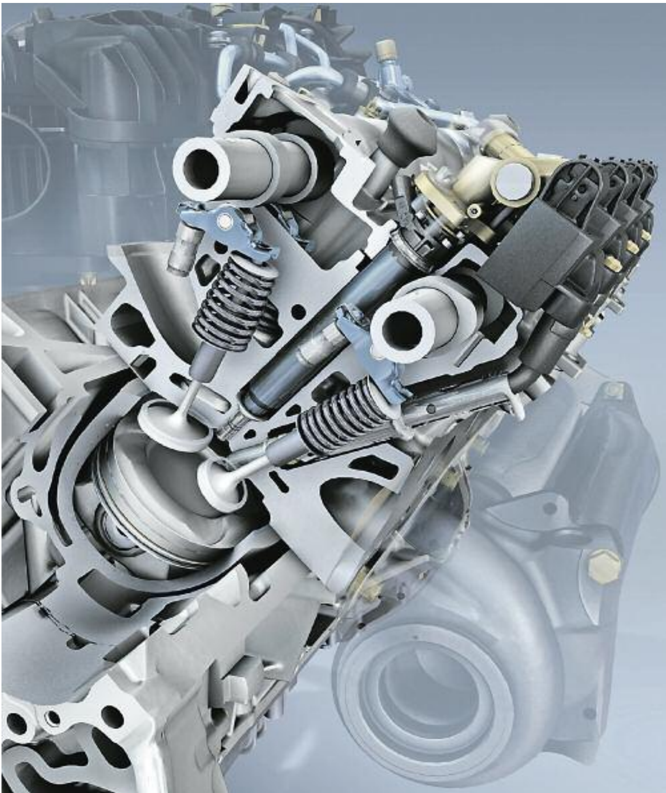
Tapa de cilindros en corte, y detalle de los árboles de levas, botadores y válvulas - MBenz.
