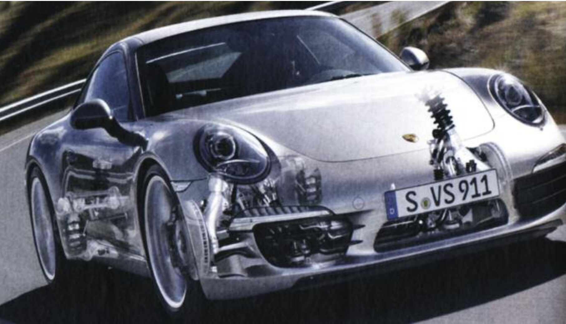
Suspensión activa (cero rolido), con una generosa distribución de pesos, mayor distancia entre ejes, y mayor trocha delantera, aumenta la estabilidad en ruta.
