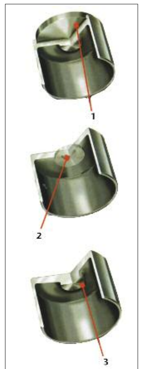
Diferentes maneras de eliminar el juego de válvula mediante espesores calibrados: 1- Espesor calibrado arriba. 2- Espesor calibrado bajo el botador. 3- Fondo con espesor calibrado.
