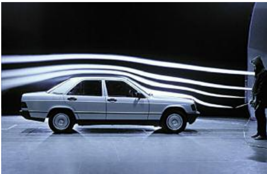
El coeficiente de puntuación Cx, es un factor de forma que indica la eficiencia de un automóvil, respecto a la sección frontal.
