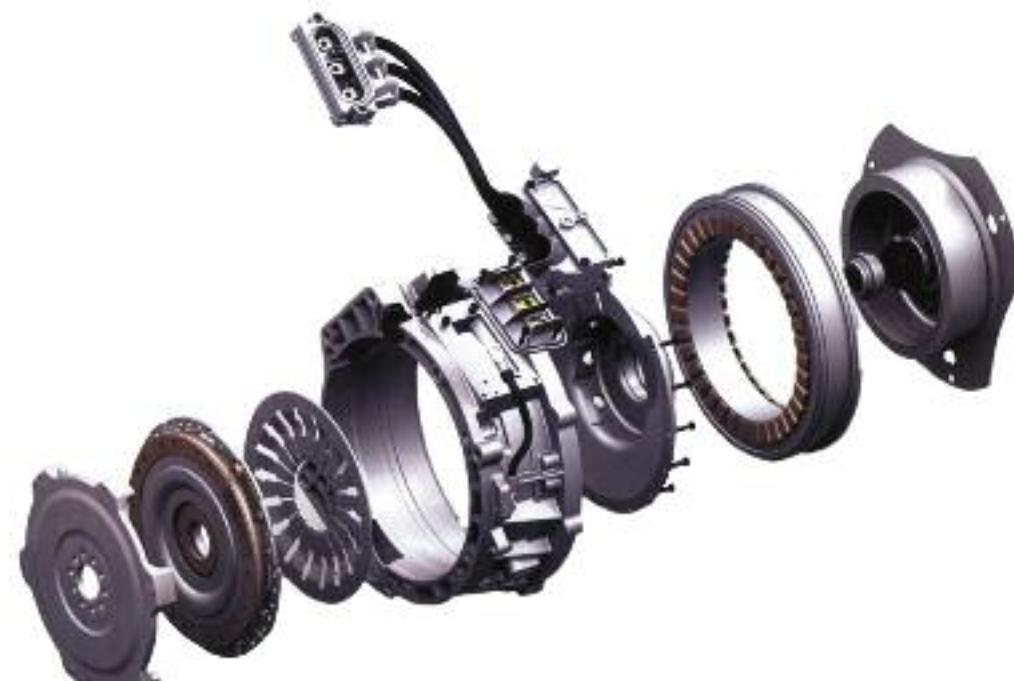
**Vista explosiva del conjunto; 1- Al motor naftero V6 de VW, se le acopla un embrague normal (en seco) 2- Entre el motor térmico y la trasmisión - intercalado - se encuentra el estator del motor eléctrico (enfriado por circulación de agua en su alrededor). 3- El rotor del generador, precede a una caja automática normal, con convertidor de par normal, hidráulico.**
