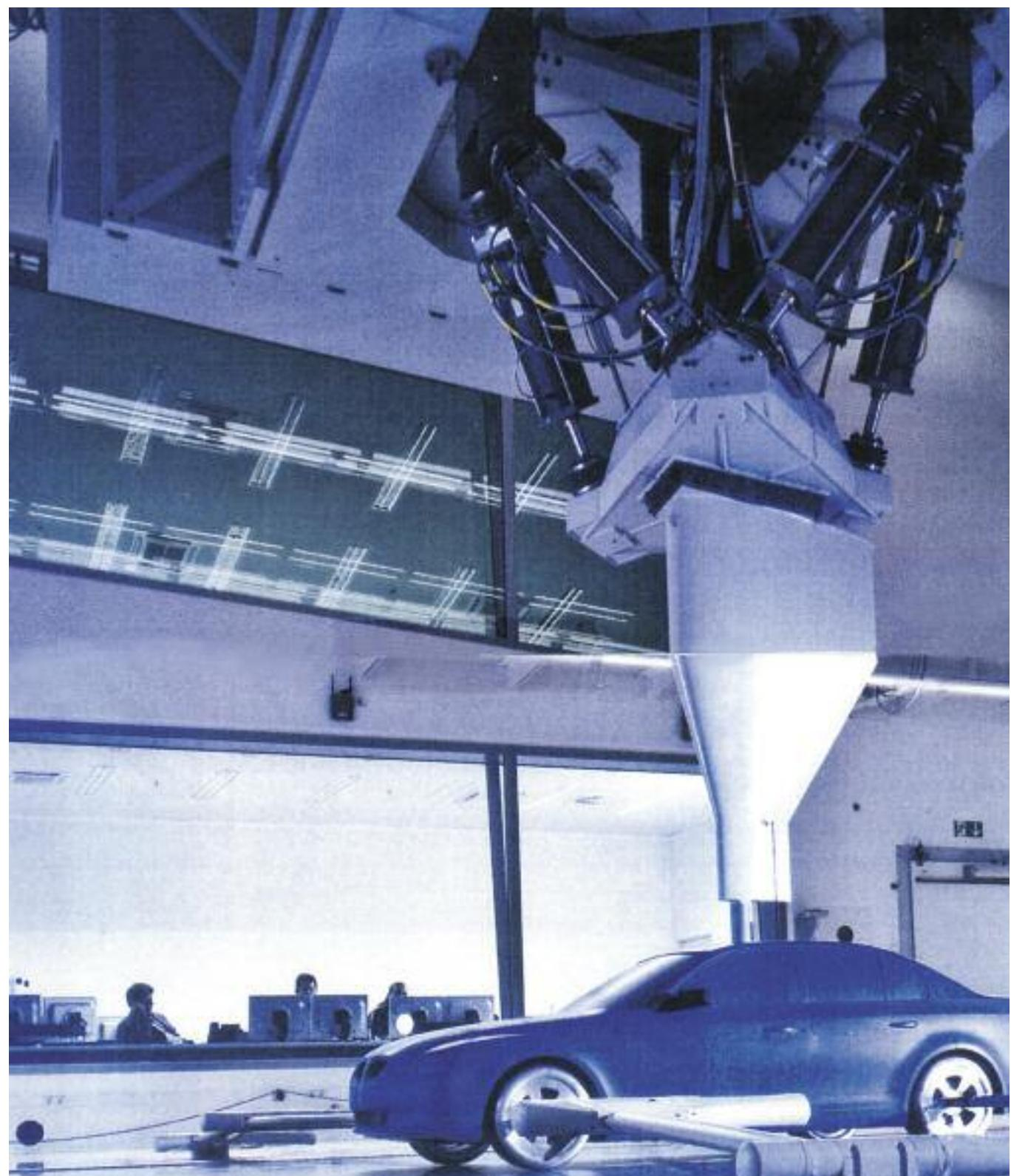
**Túnel de viento moderno, para el estudio aerodinámico de maquetas de distintos tamaños \_BMW.**
