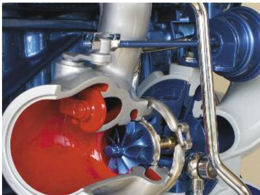
**La turbosobrealimentación hace un aporte de importancia en los motores de 3 cilindros respecto a la potencia y al par motor.**
