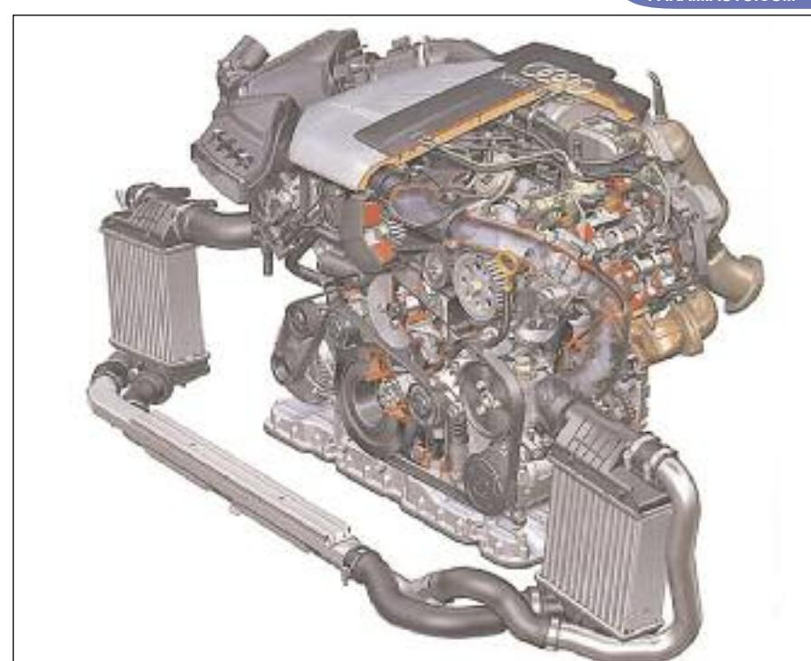
**Motor Diesel de 2,7 litros V6 TDI con inyección directa de gasoil de alta presión, con tecnología "Common rail" e inyectores piezoelectricos, turbo doble e intercoolers – Audi.**
