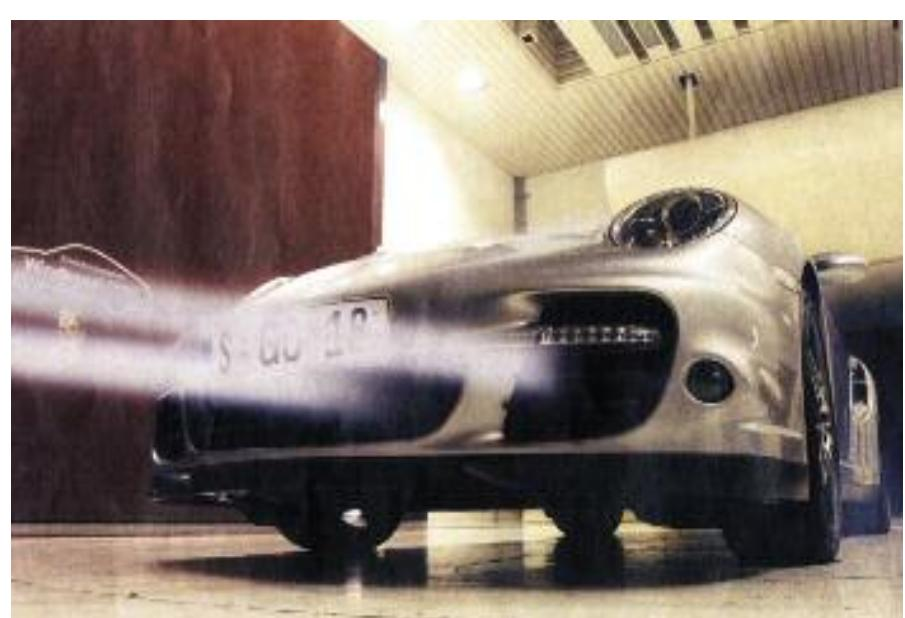
**Automóvil PORSCHE 911 Turbo en el túnel aerodinámico, para desarrollar un Cx. de 0,31 y obtener mayores fuerzas de apoyo, con el uso de un alerón accionado electrohidráulicamente, cuando se supera cierta velocidad -PORSCHE.**
