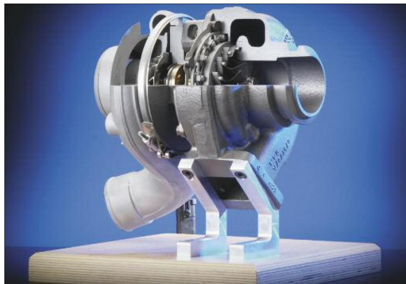
**En la actualidad, el turbosobrealimentador del tipo TGV de geometría variable, es utilizado con eficiencia técnica, tanto en motores nafteros como gasoleros – Borg Warner.**
