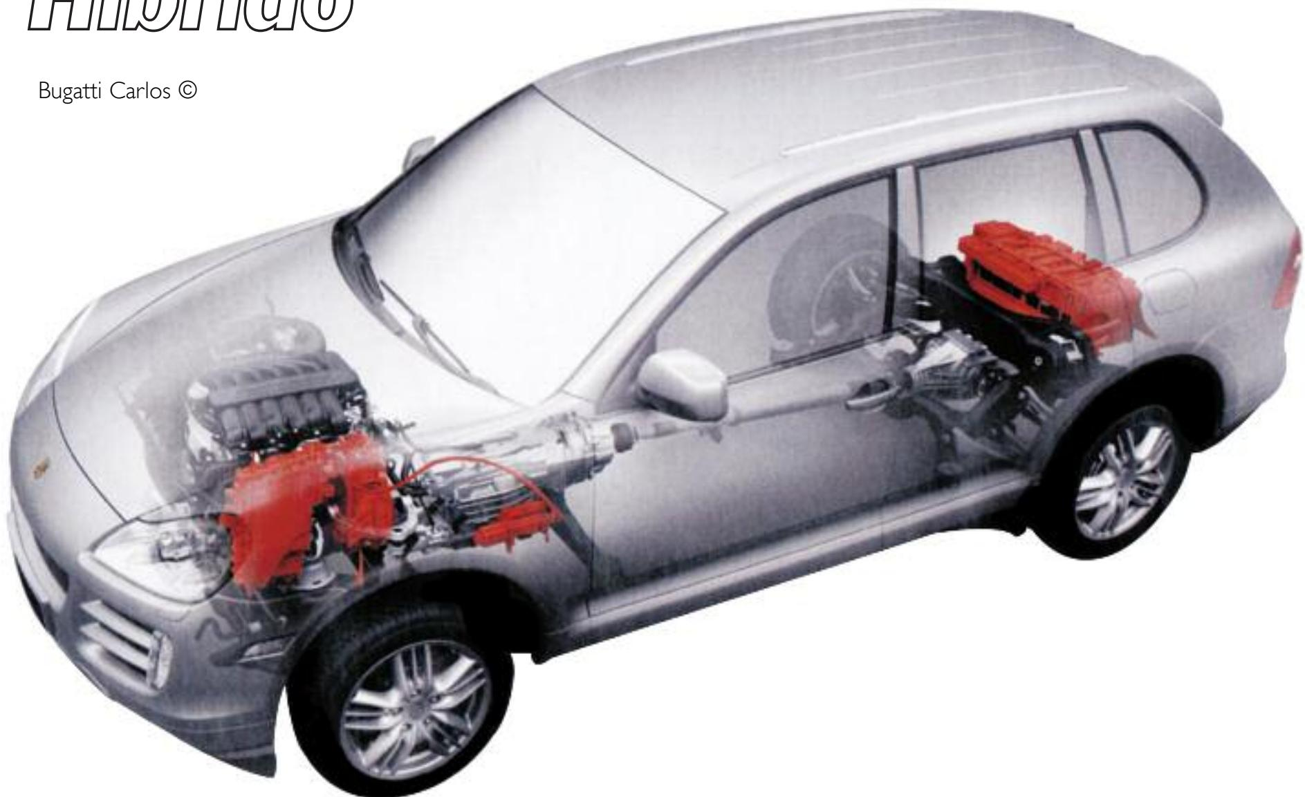
**El motor eléctrico del Cayenne "Híbrido", está ubicado entre el motor V6, y la caja de velocidades, y puede accionar al vehículo hasta una velocidad de 120 km/h. Instalada en la parte trasera, está la batería de 30 KW compuesta de 240 células que aseguran una tensión de 280 Volts. - Porsche**
