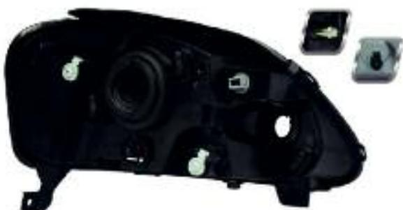
Terminaciones de alta calidad, con fijaciones reforzadas y sellado de precisión que protege de filtraciones.
