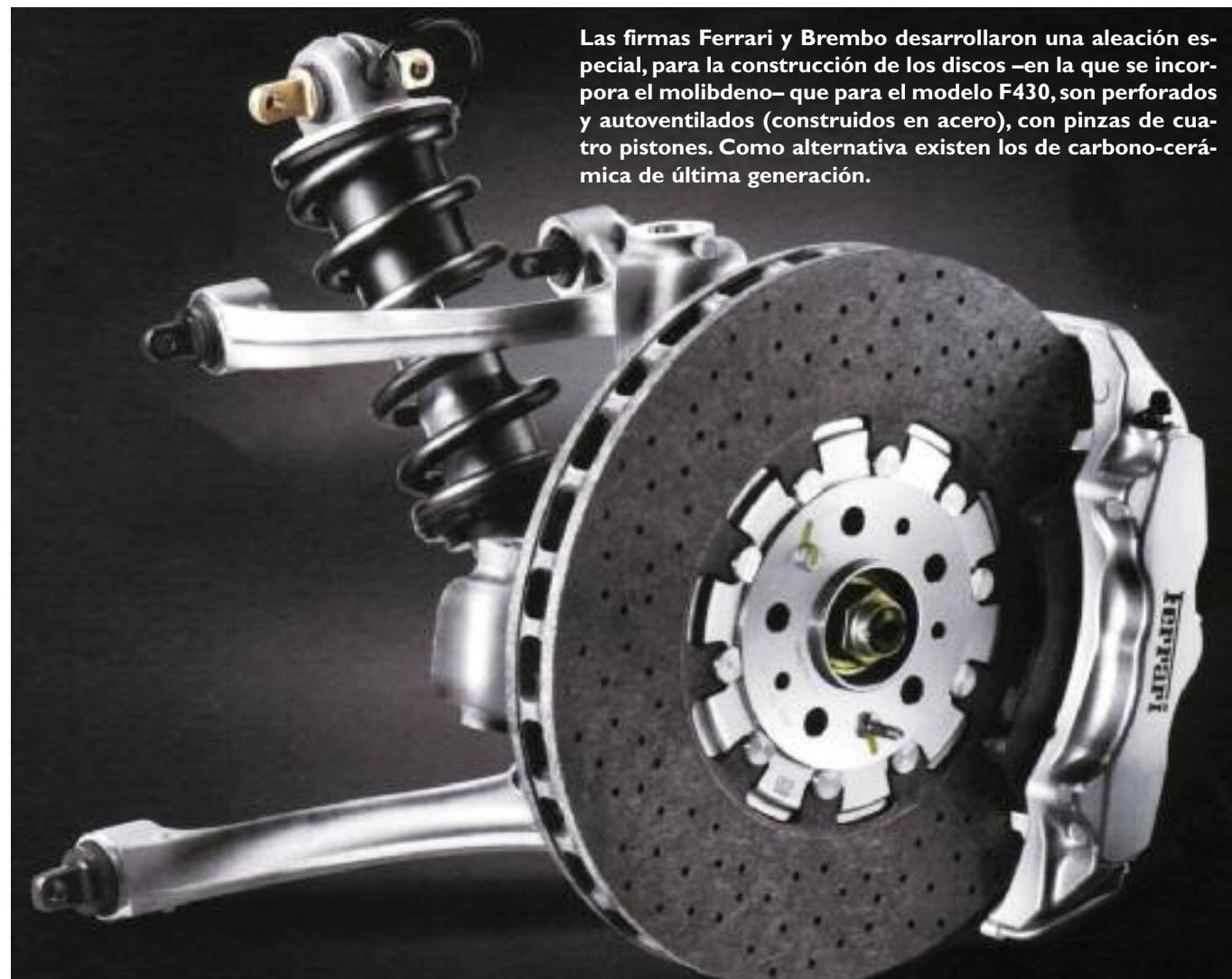
Las firmas Ferrari y Brembo desarrollaron una aleación especial, para la construcción de los discos –en la que se incorpora el molibdeno– que para el modelo F430, son perforados y autoventilados (construidos en acero), con pinzas de cuatro pistones. Como alternativa existen los de carbono-cerámica de última generación.
