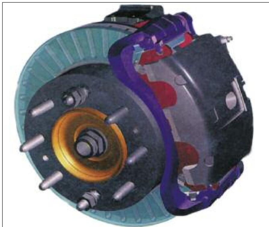
**En el diseño del conjunto de frenos, se utiliza mucho la computadora, tanto en los discos como en las pinzas, que normalmente son del tipo auto-ventilados.**
