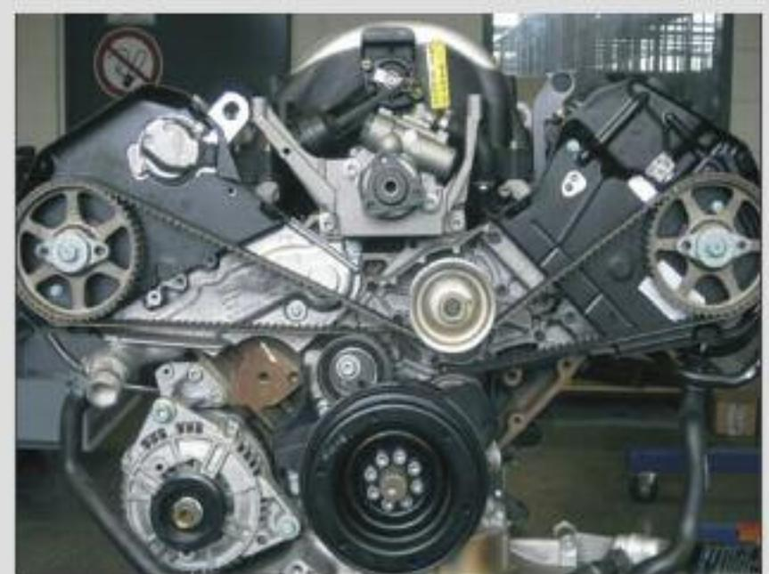
4. Gire el cigüeñal hacia la derecha al punto muerto superior OT del tercer cilindro. Las marcas de control deben enrasar.
