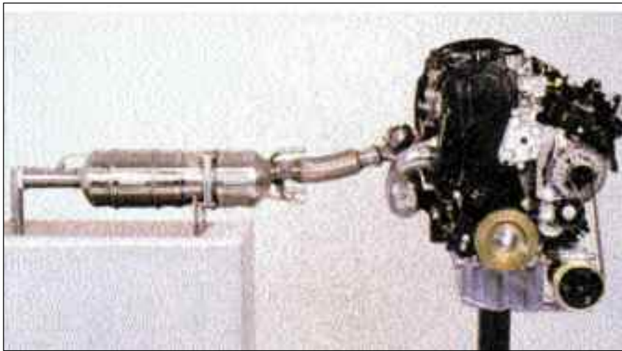
El sistema FAP puede eliminar el 95 por ciento en forma aproximada, del carbono particulado en los gases de escape, y gestionar periódicamente la regeneración del filtro.
