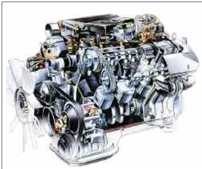
Motor de 8 cilindros en V, de 5 litros de cilindrada total, todo aluminio con 4 válvulas por cilindro de la década del '90- M. Benz SL 500.
