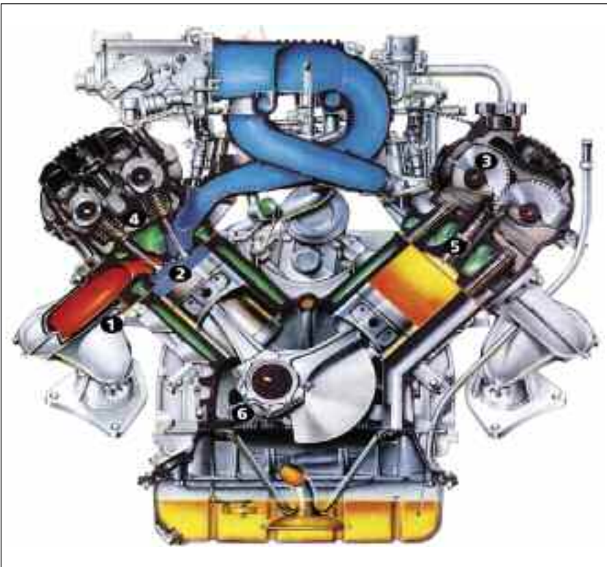
Motor de 8 cilindros en V a 90 grados con inyección indirecta de nafta/gasolina de fabricación japonesa - Lexus. 1- Múltiple de escape. 2- Cámara de combustión. 3- Engranaje de comando de los árboles de levas. 4- Tapa de cilindros. 5- Bujía de encendido. 6- Cama de apoyo del cigüeñal (bancadas).
