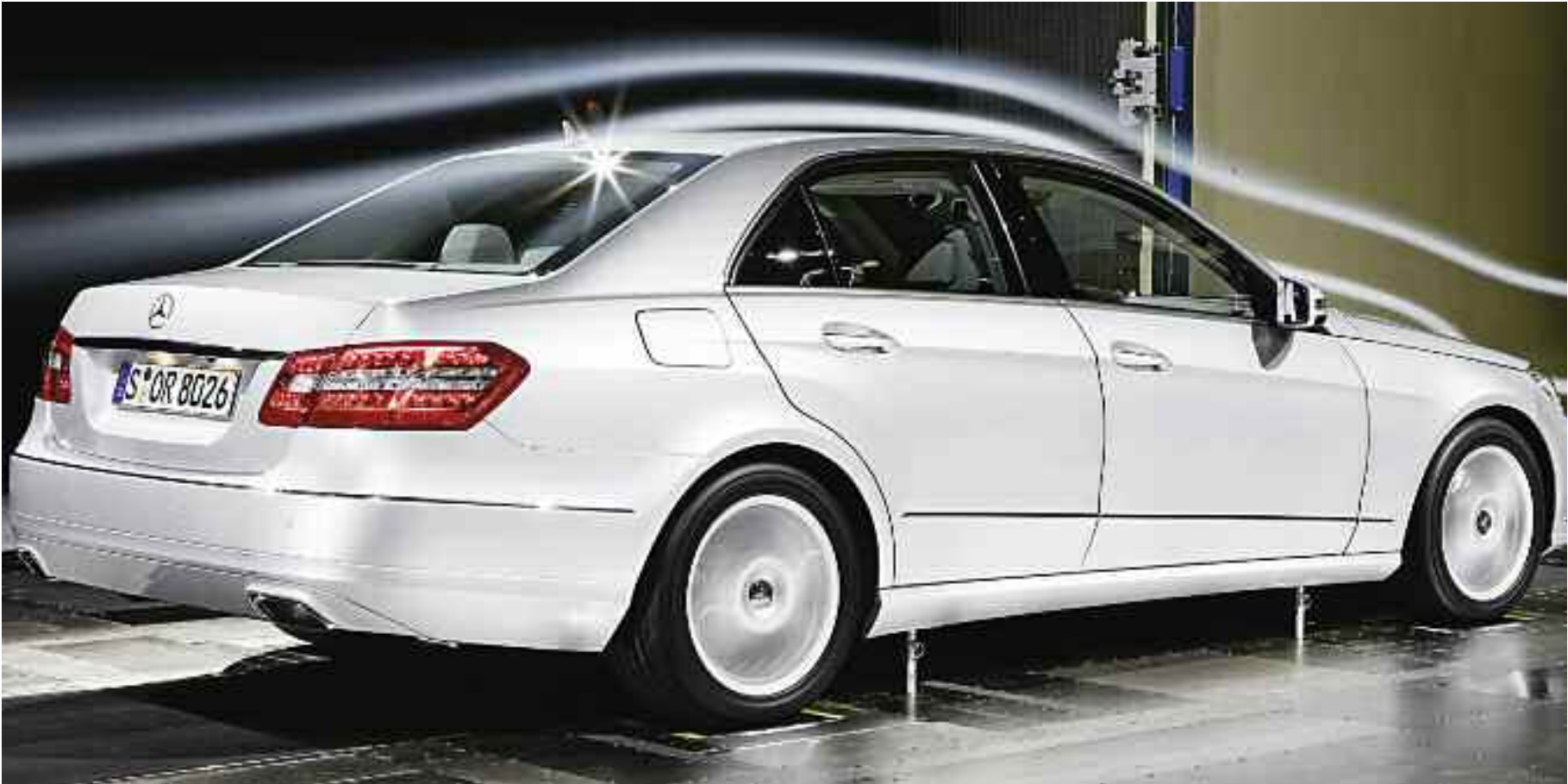
El coeficiente Cx. mide la influencia de la forma del auto, en la resistencia que presenta el aire a su avance.
