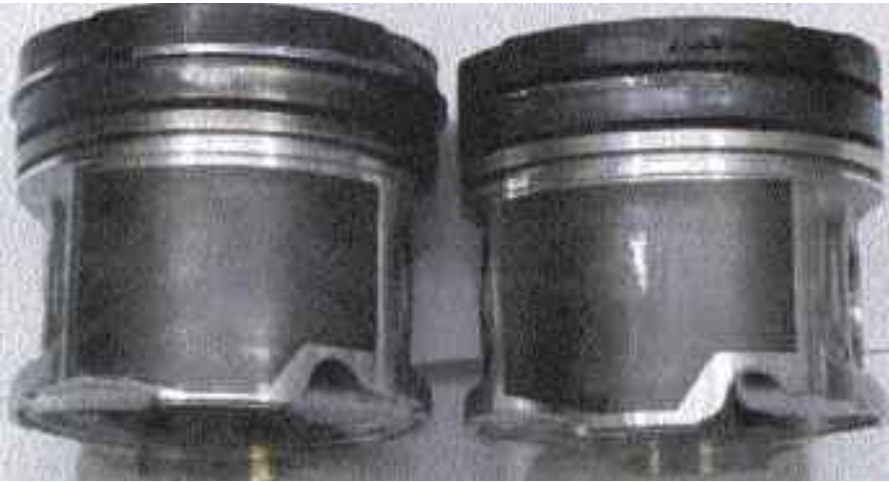
Ambos pistones muestran un desgaste diferente, por ejemplo en la falda o pollera: el de la izquierda está íntegro, incluyendo las ranuras de los aros de pistón que presentan pocos depósitos. Esto significa que la película lubricante permaneció estable.
