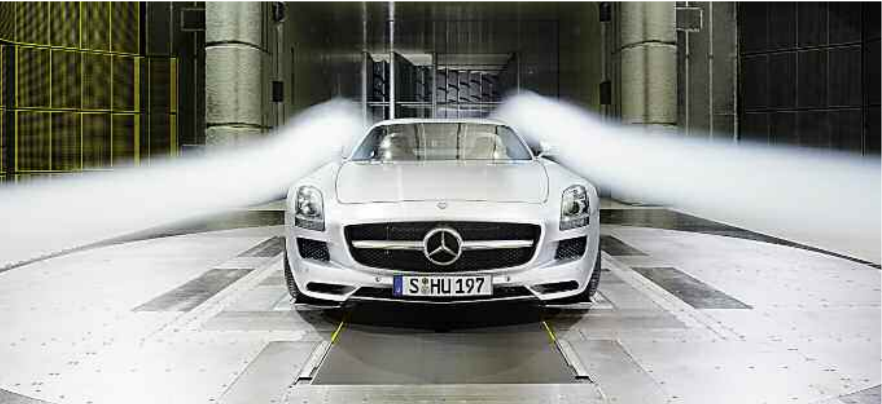
Automóvil en túnel aerodinámico, estudio con flujo realizado con humo químico, vista de frente. M. Benz SLS/AMG.
