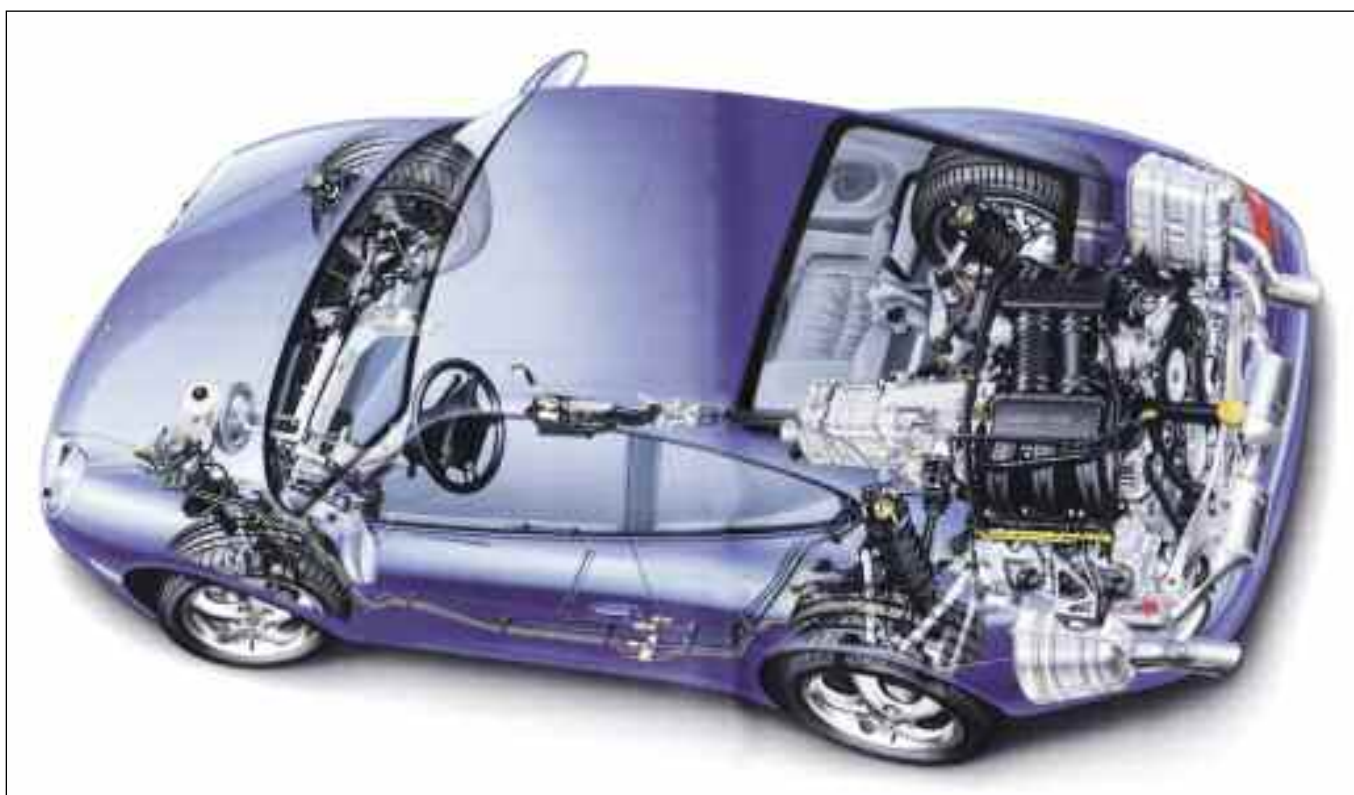
El 911 está equipado con un motor de 6 cilindros boxer, de 3.387 cm 3 de cilindrada y 300 CV de potencia a 6.800 rpm, con un par motor máximo de 350 Nm a 4.600 rpm, logrando una relación peso/potencia excelente – Porsche 2000.
