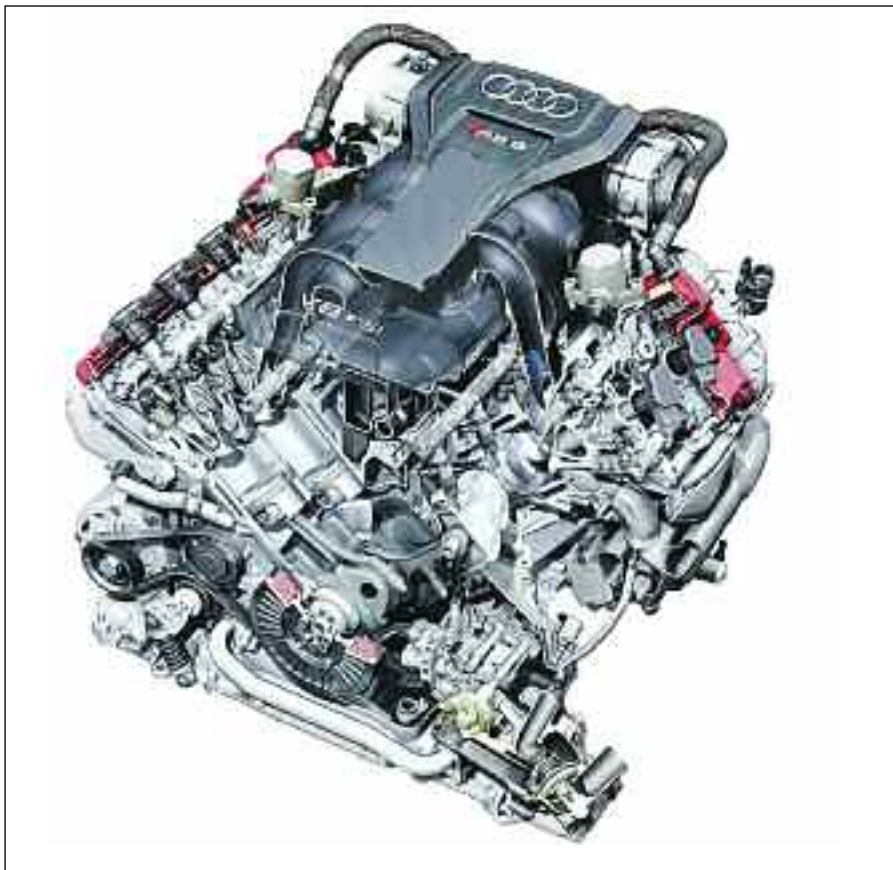
Motor en corte V8 FSI con inyección directa de nafta/gasolina, de 4,2 litros - Audi.
