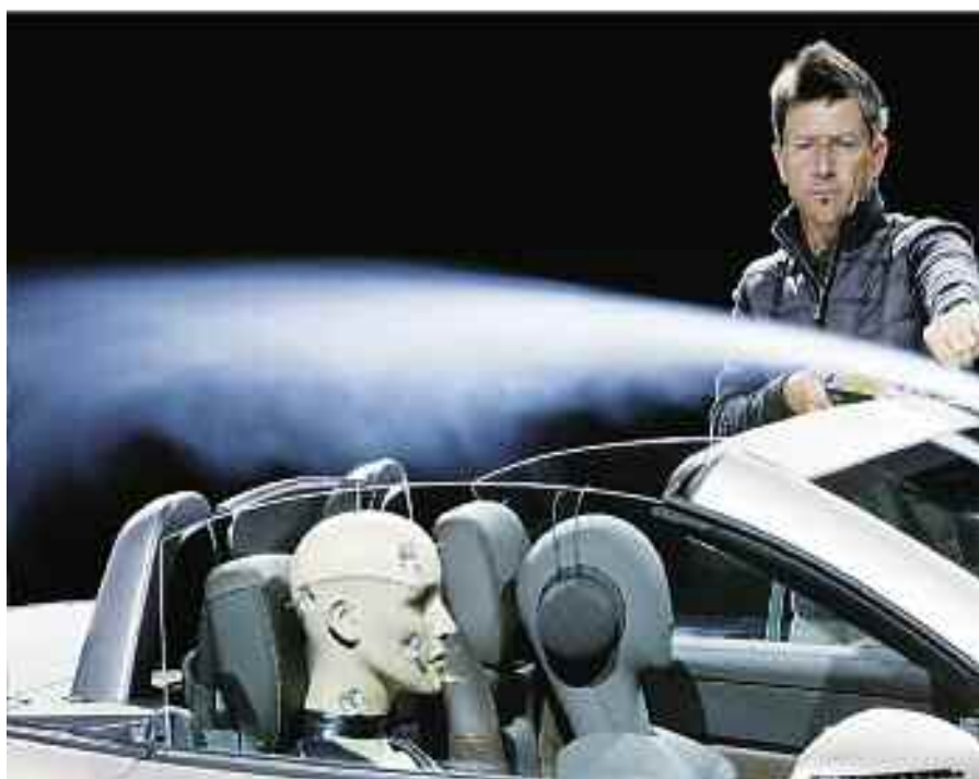
Modelo SLK Class, y estudio aerodinámico con maniquí y humo químico. M. Benz.
