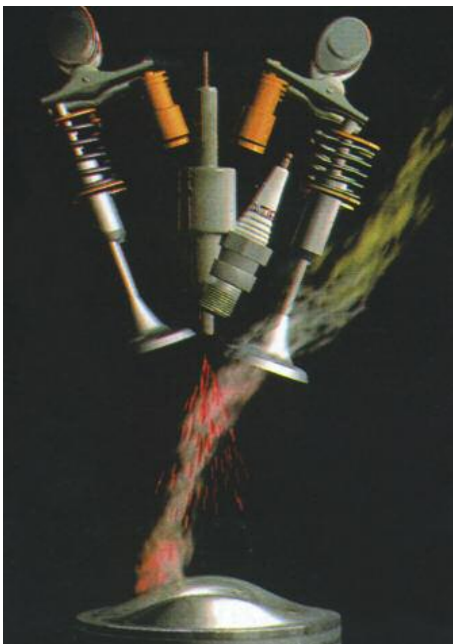
Perspectiva de un cilindro de un motor de 5 válvulas, con bujía en el centro, y detalle de posicionamiento del electroinyector de la inyección directa de nafta.
