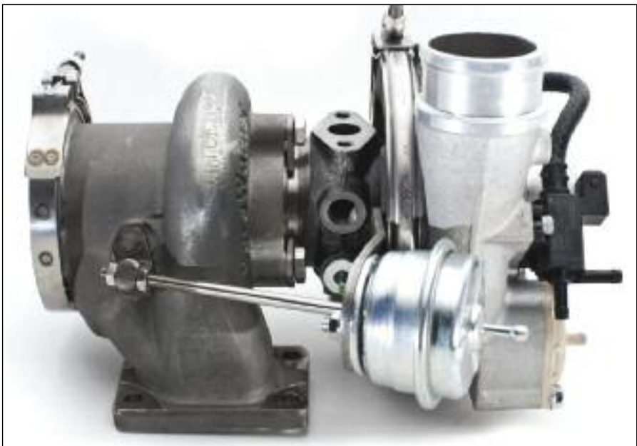
El turbo resulta ser muy eficaz para la sobrealimentación, e ingresa a la cámara una cantidad en peso de aire o mezcla - Borg Warner EFR.
