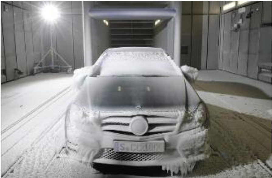
En la actualidad, la evolución técnica permite someter a modelos y prototipos a frios extremos y a altas temperaturas. (entre -40 y 60 grados C.)
