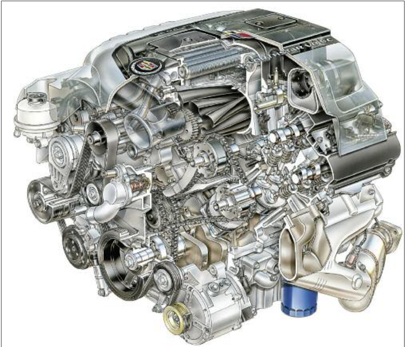
Corte en perspectiva del motor Nordstar V8 con compresor volumétrico – Cadillac.
