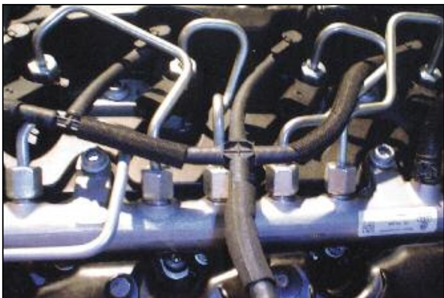
El sistema "Common rail" aportó en gran medida, al mejoramiento del proceso de combustión completa.
