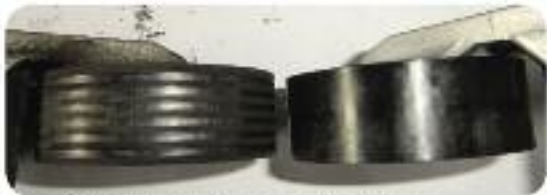
Polea del tensor desgastada y nueva polea del tensor
