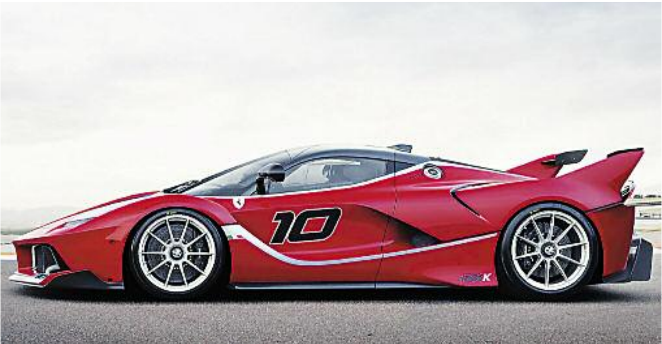
Los neumáticos —son de la marca Pirelli sin dibujo— tienen sensores que transmiten la aceleración (longitudinal, transversal y radial), la presión y la temperatura. Según Ferrari, así se asegura un análisis preciso de la interacción entre el neumático y la pista, además de permitir actuar sobre el control de tracción garantizando el máximo rendimiento de la Ferrari FXX K.
