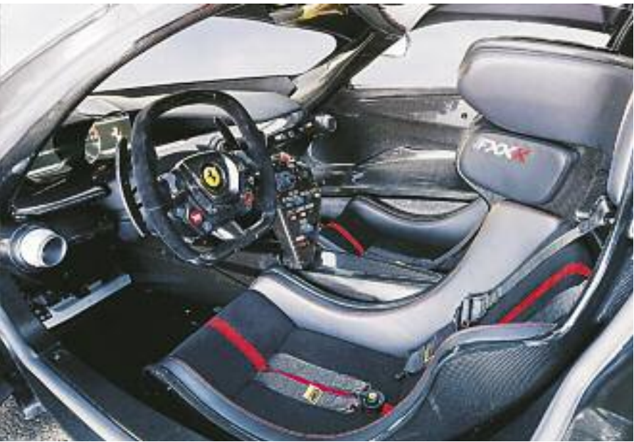
El nivel de intervención del diferencial electrónico E-Diff, control de tracción F-Trac, Racing SSC (Slip Side Control de ángulo) - ahora calibrado especialmente para adaptarse a los neumáticos lisos del auto- y el alto rendimiento de ABS se puede controlar mediante cinco posiciones (dials de ajuste) en el volante.
