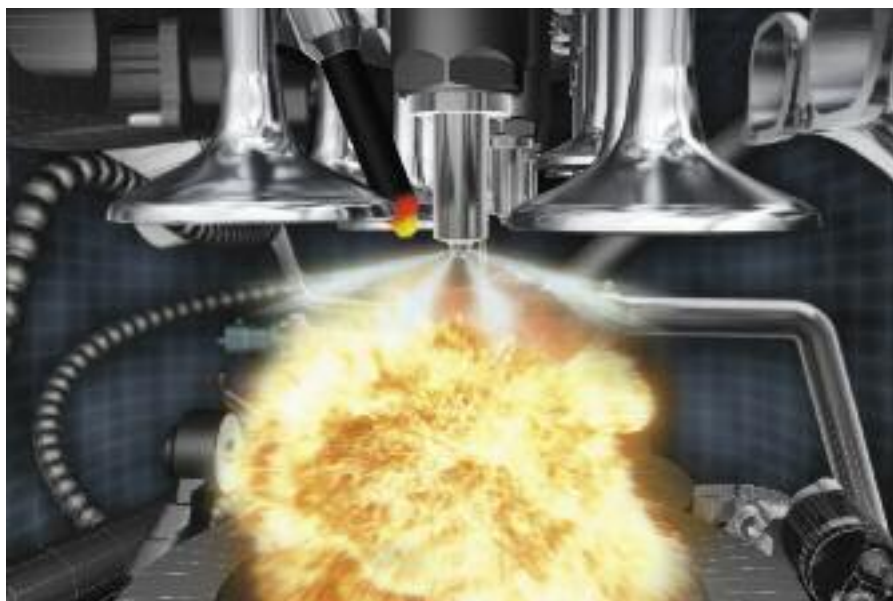
La inyección de alta presión, en sus comienzos, lograba una reducción considerable del consumo, y un alto valor de par motor en bajos regímenes.
