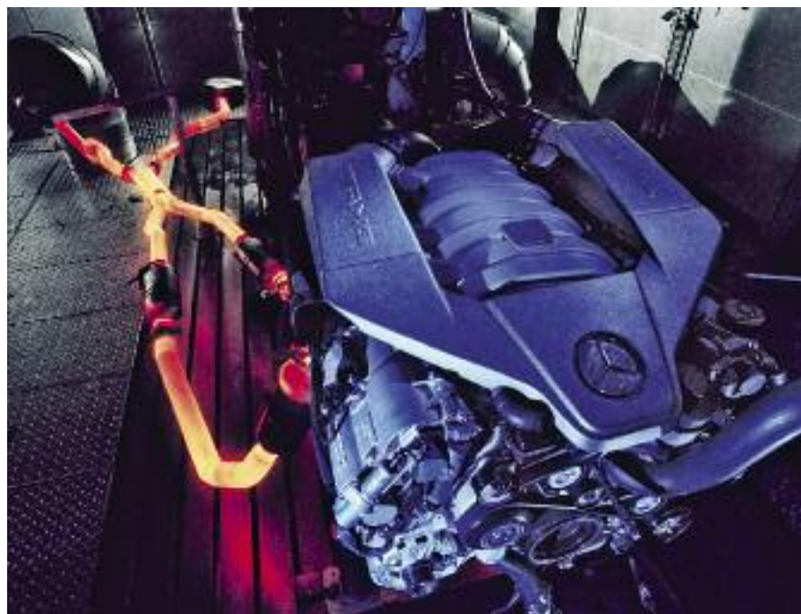
Motor V8 Mercedes AMG. escape al rojo en banco dinamométrico de pruebas.
