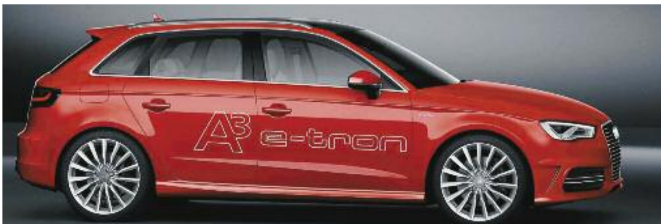
El e-tron A3 Sportback ofrece 150 kW (204 CV) de potencia del sistema y logra consumo medio de sólo 1,5 litros cada 100 km. En el modo eléctrico de su rango de operación es de hasta 50 kilómetros con el motor TFSI aumentaría a 890 km.
