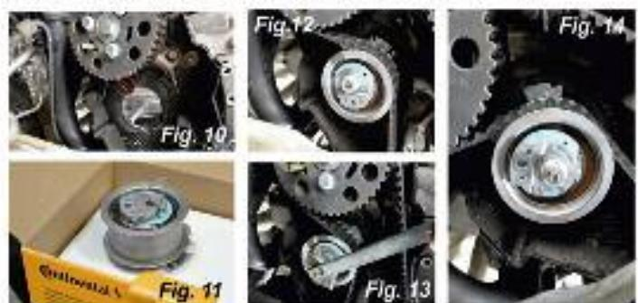
3. Colocar la correa de distribución, comenzando por el piñón del árbol de levas, en contra del sentido del reloj: El piñón del árbol de levas, el rodillo tensor, el piñón del cigüeñal y, por último, el piñón de la bomba de agua. En este paso debe evitarse que la correa de distribución se doble al colocarla. La correa debe quedar tensada en el lado de tracción entre los engranajes!
