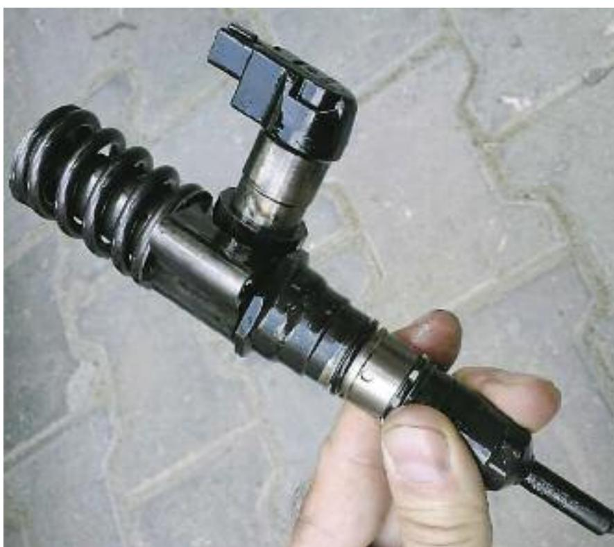
**El inyector/bomba regrupa en un solo cuerpo, una bomba de alta presión, una electroválvula de comando, y un inyector.**
