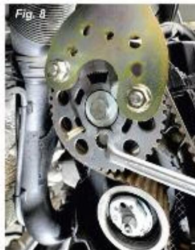
2. Montar los componentes nuevos. Asegurarse de que, en el rodillo tensor, la borquilla de sujeción (Fig. 9) asiente correctamente en la escotadura del revestimiento (Fig. 10). Montar el rodillo tensor con la herramienta 303-1054 insertada (Figs. 7 y 11).
