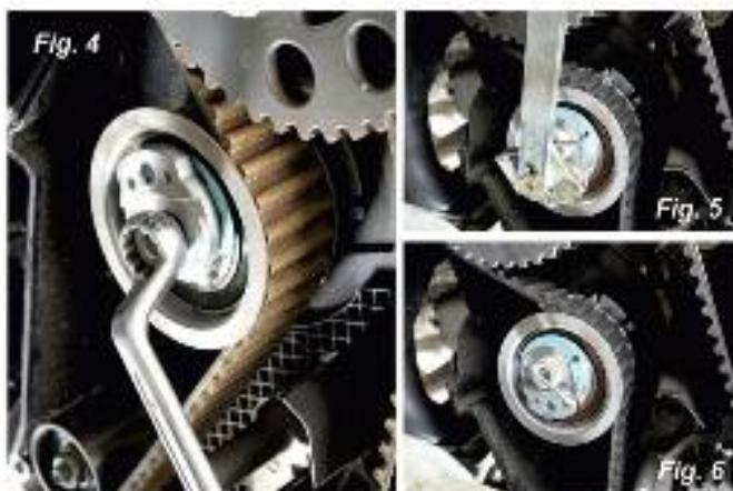
Para destensar la excéntrica del rodillo tensor, girar el rodillo tensor con la llave para tuercas dedos agujeros OE (303-1053) en contra del sentido del reloj, hasta que la herramienta de sujeción OE (303-1054) pueda insertarse en el rodillo tensor (Figs. 5 y 6). En el nuevo kit de correa de distribución, hay partes de la herramienta de sujeción sueltas en el embalaje (Fig. 7).
