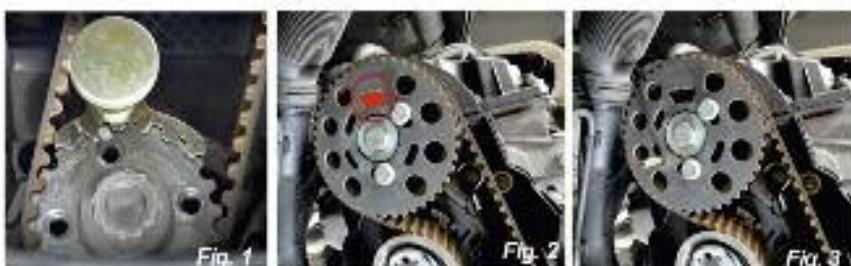
2. Colocar la herramienta de fijación del árbol de levas OE (VW 3359) en el árbol de levas (Fig. 3). 3. Montar la herramienta de fijación del cigüeñal OE (310-085) (Fig. 1). La marca de la herramienta OE (310-085) debe quedar alineada con la marca de la rueda dentada. 4. Aflojar el tornillo del rodillo tensor y destensar la correa de distribución y rodillo tensor (Fig. 4).
