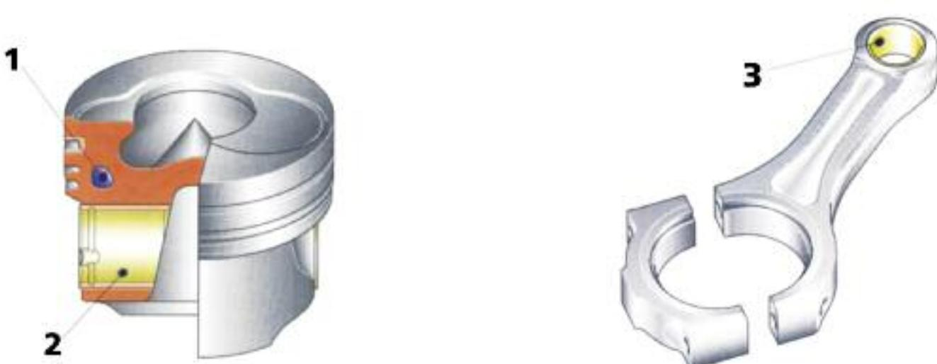
**Pistón biela (con cabeza separada por cracking): I- Conducto de enfriamiento. 2- Bujes de latón. 3- Buje de latón del pie de biela.**
