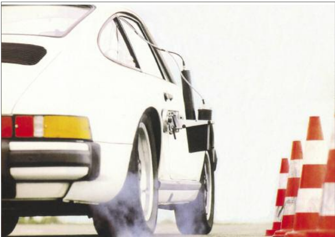
Ensayo instrumentado de la eficiencia frenante bajo diferentes condiciones – Porsche.
