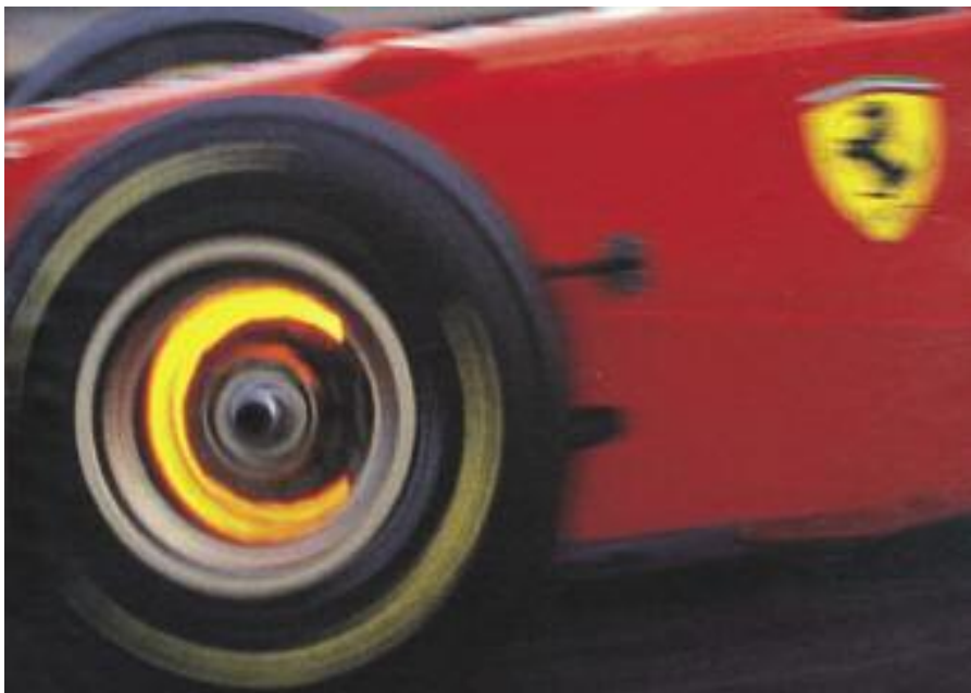
Discos de freno de un automóvil de F1 al rojo vivo – Ferrari/Brembo.
