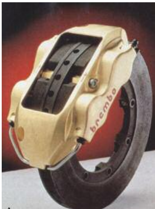
A.- Conjunto de disco y pinza, contruidos en carbono y en aleación liviana respectivamente para un automóvil de F1 – Brembo. B.- Conjunto de frenos en donde el disco es perforado y ventilado, y corresponde a la Ferrari F50 – Brembo.
