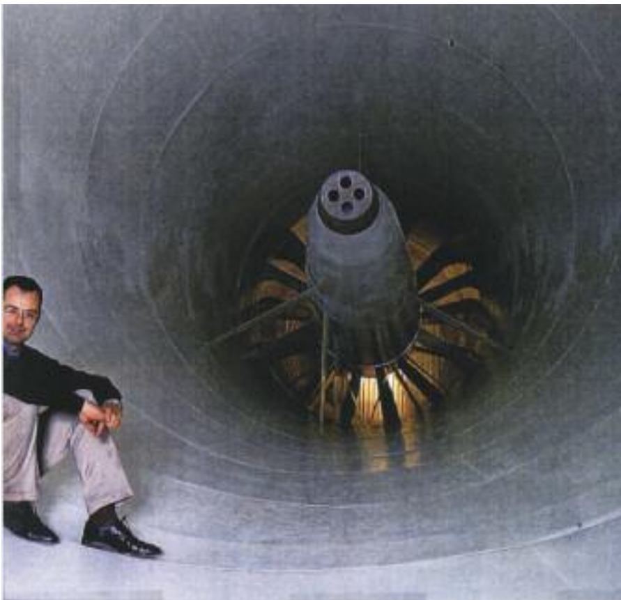
El túnel de viento es una sala en la cual se hace pasar un flujo rápido de aire, a través de un vehículo real o de uno a escala, con el fin de recopilar datos aerodinámicos.
