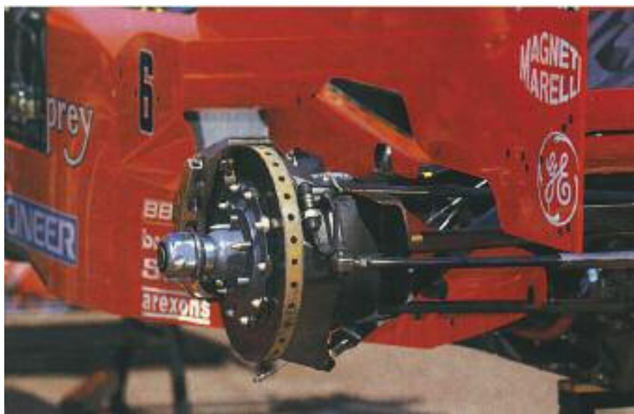
Conjunto de un sistema de frenos traseros, que utiliza una pinza de 4 pistones en una Ferrari 310B – Brembo.
