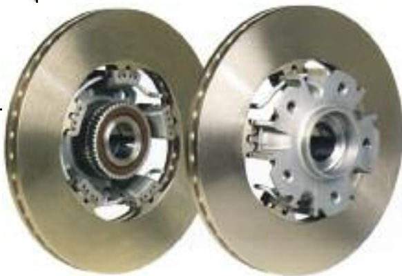
Frenos de diseño de avanzada; conjunto integral de construcción modular para mejorar peso y costo de la estructura. El sensor de ABS está integrado dentro del cojinete de rueda. Disco de freno integrado, montado directamente sobre el cubo del cojinete. - Continental/Teves.
