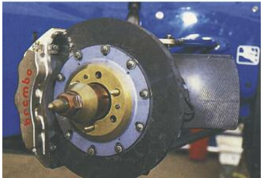
Arriba: discos de frenos delanteros y traseros en material "composite". Abajo: Conjunto disco/pinza, proyectado, producido y probado por Brembo para la FI; las altas prestaciones del sistema frenante garantizan seguridad y confiabilidad.
