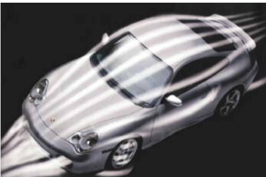
El coeficiente Cx de penetración, es un factor de forma que indica cuánto de eficiente es el vehículo, en pasar a través del fluido, con la sección frontal - S-Porsche.
