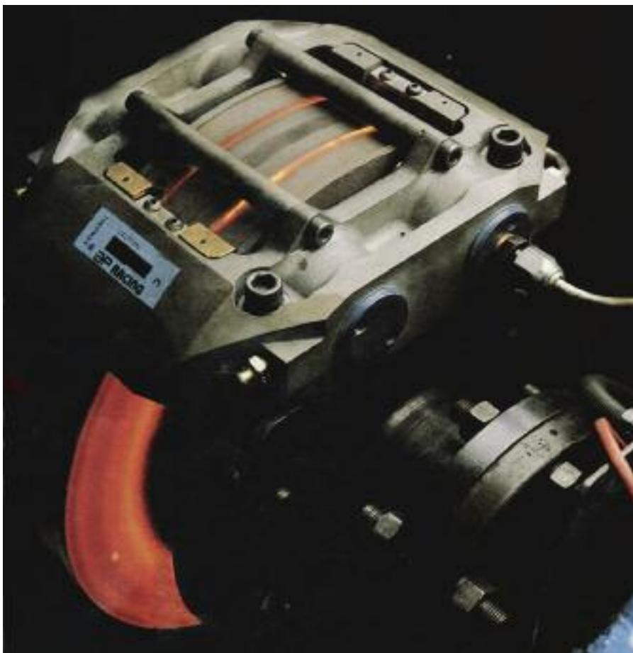
La fuerza de frenado depende de la superficie de contacto de las pastillas con el disco, de la presión ejercida sobre el pistón de la bomba (cilindro maestro), y del coeficiente de fricción entre ambos (pastillas y disco) –AP Racing.
