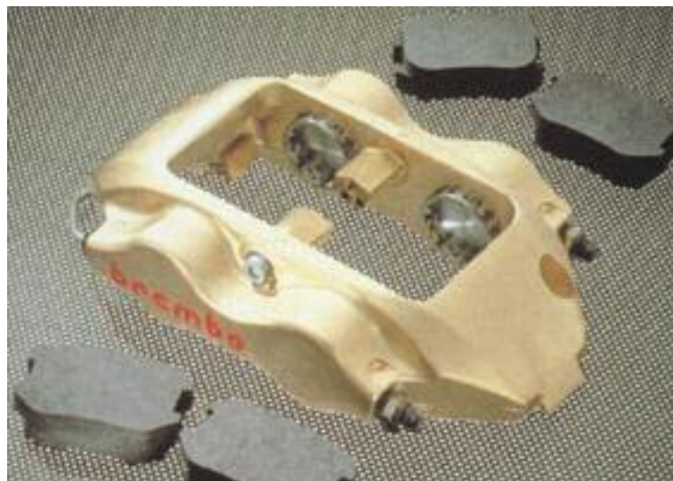
Pinza de aluminio y disco construido en carbono, utilizados en la Fórmula 1. Las pastillas están fabricadas en carbono-carbono – Brembo.
