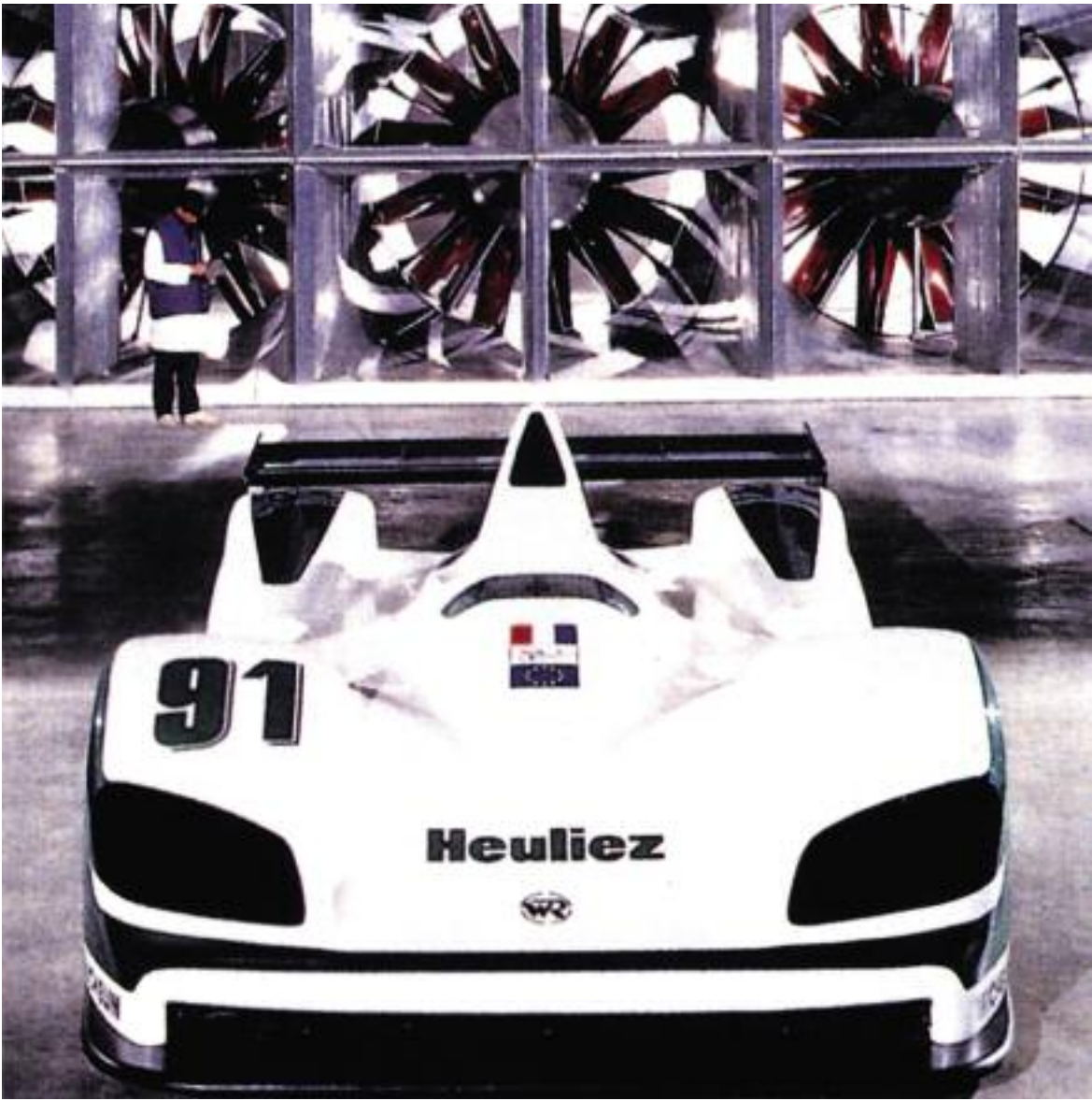
Prototipo deportivo frente a la batería de ventiladores, del túnel aerodinámico – Heuliez.
