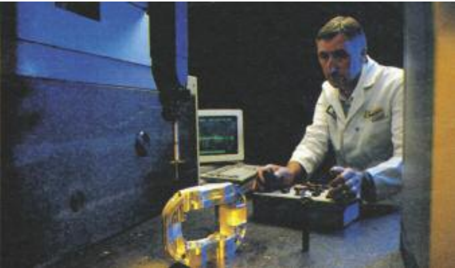
Control dimensional del mecanizado (metrología) de las partes componentes del sistema, construidas en aleaciones de aluminio, o de materiales compuestos con matriz metálica (CMM).
