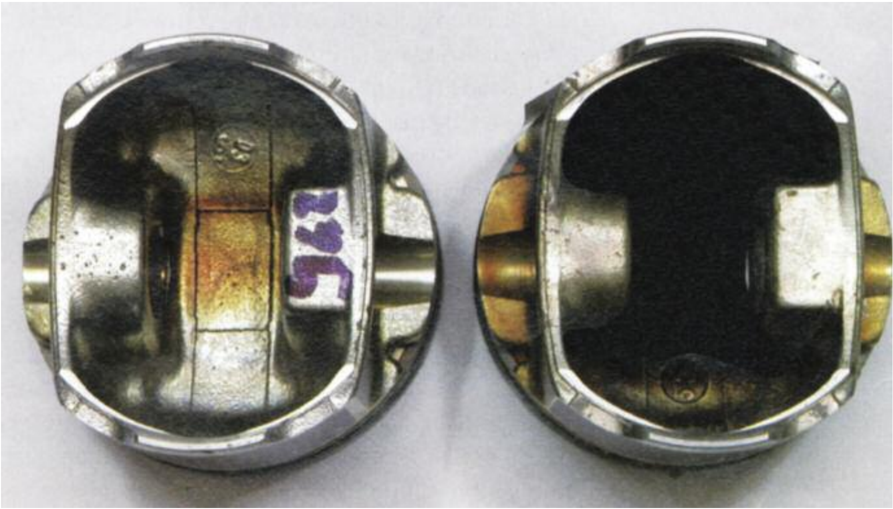
Dos pistones que funcionan con distintos aceites, el de la izquierda no tiene prácticamente ningún depósito, el de la derecha tiene placas formadas por la poca estabilidad térmica del aceite lubricante.
