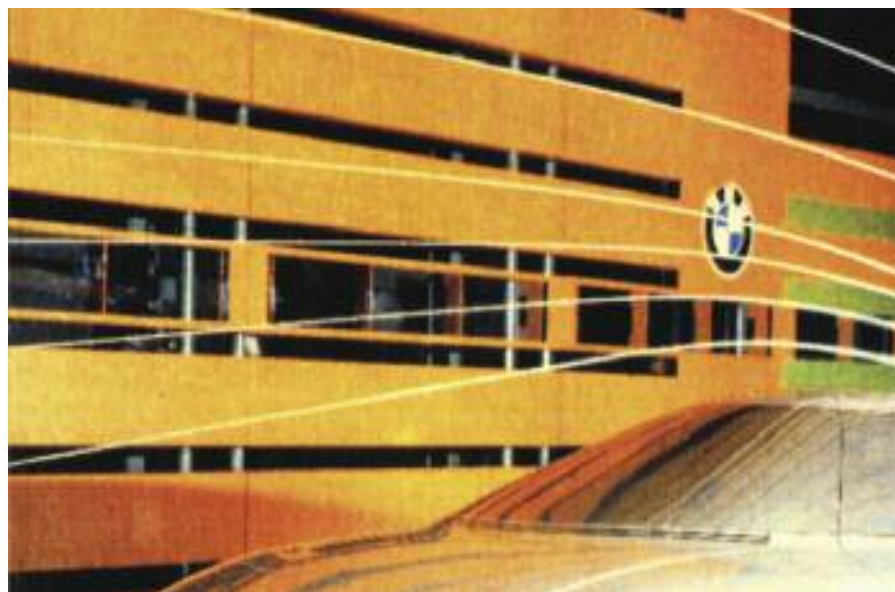
Trayectoria de filetes, de un "Concept car" en el túnel de viento, con las ruedas posteriores carenadas - BMW.
