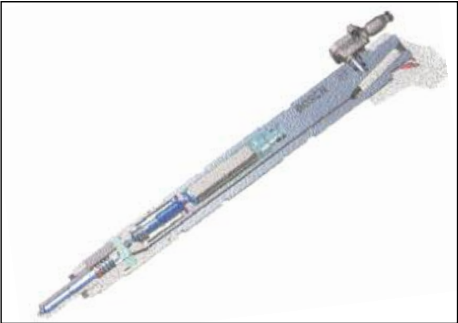
Los inyectores piezoeléctricos permiten repartir la inyección en 5 partes o etapas, también denominada inyección múltiple.
