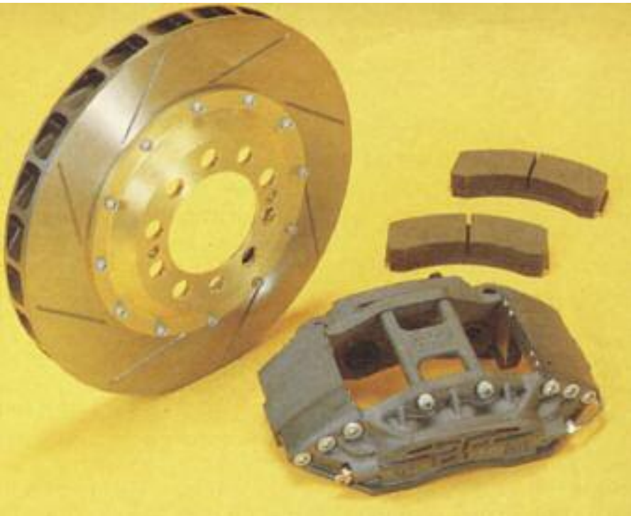
Componentes fundamentales del sistema de frenos: disco de fundición ventilado, pinza de aluminio aleado, y pastillas de carbono-metal – AP Racing.
