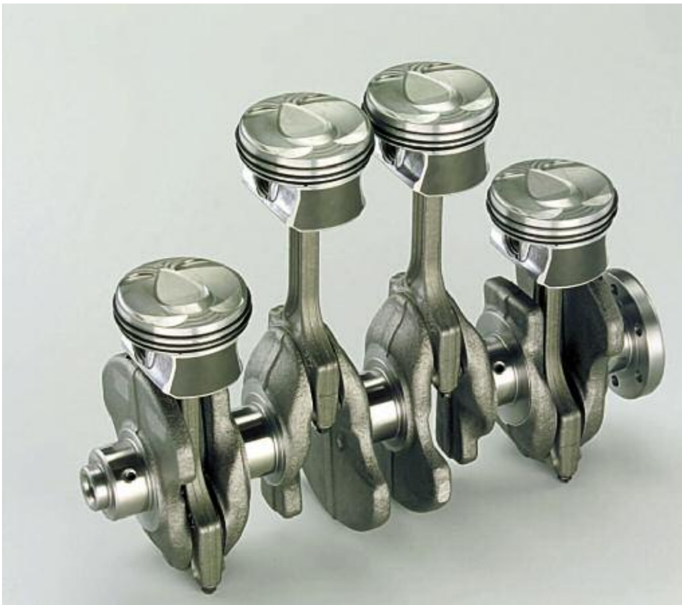
Componentes del conjunto rotativo-alternativo (cigüeñal, bielas y pistones), del motor naftero de inyección directa y turbo.
