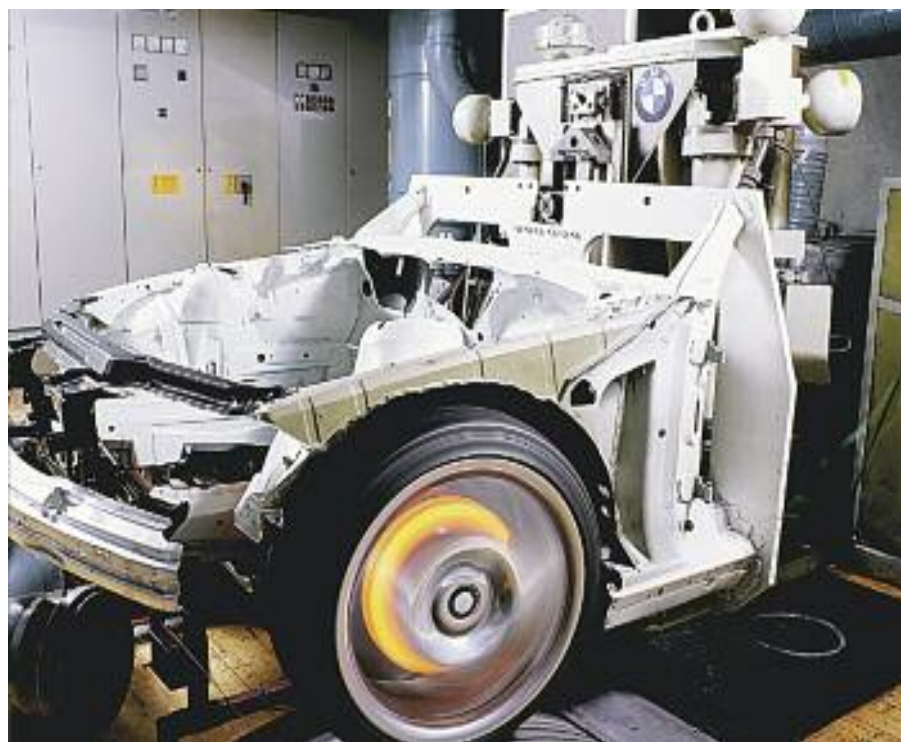
Laboratorio de ensayos de componentes, banco de pruebas dinámico de ruedas y frenos – BMW.
