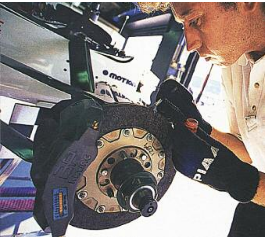
Los discos de freno actuales de la FI, están contruidos de carbono-carbono, y los mismos pueden desarrollar temperaturas de más de 700 grados C.
