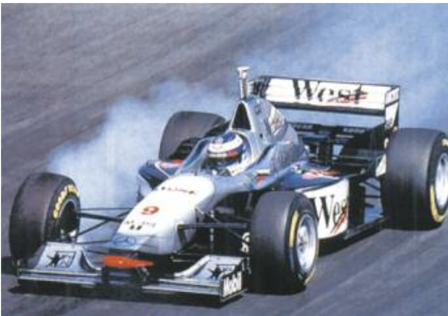
Bloqueo de las ruedas y densa columna de humo; Mc Laren – Mercedes FI.
