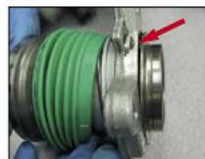
Fig. 6: Actuador desmontado por alojamiento incorrecto en su posición.
