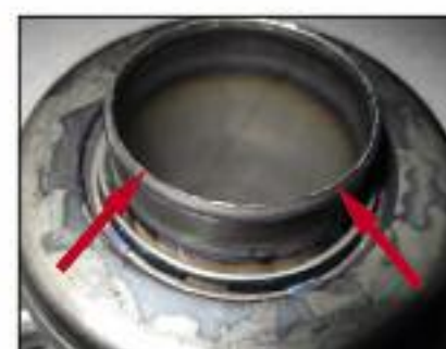
Fig. 2: Anillo tope del actuador desgastado por montaje de disco al revés.
