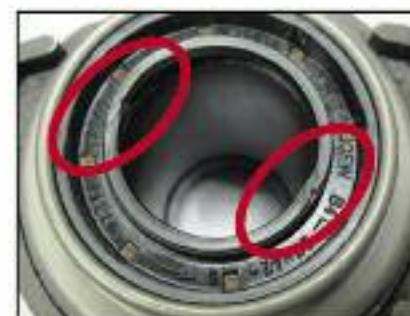
Fig. 4: Retén dañado en el momento del montaje.
