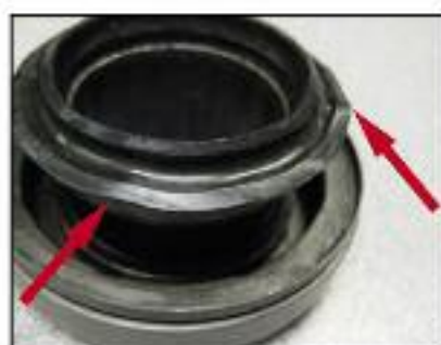
Fig. 5: Retén interno dilatado por contacto con líquido incompatible.
