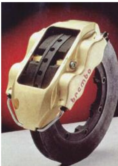
A.- Conjunto de disco y pinza, construidos en carbono y en aleación liviana respectivamente para un automóvil de F1 – Brembo. B.- Conjunto de frenos en donde el disco es perforado y ventilado, y corresponde a la Ferrari F50 – Brembo.
