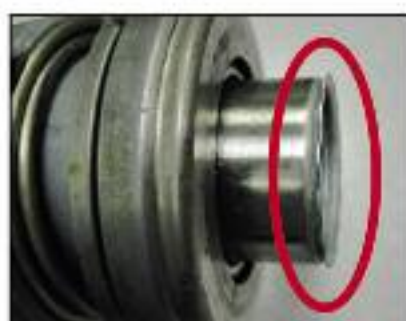
Fig. 7: Anillo tope deformado por exceso de recorrido.
