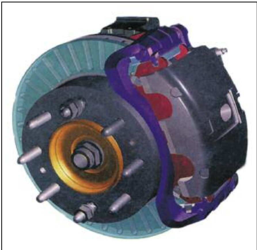
En el diseño del conjunto de frenos, se utiliza mucho la computadora, tanto en los discos como en las pinzas, que normalmente son del tipo auto-ventilados.
