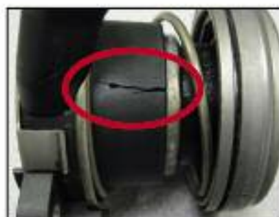
Fig. 3: Actuador fracturado por defecto de montaje.
