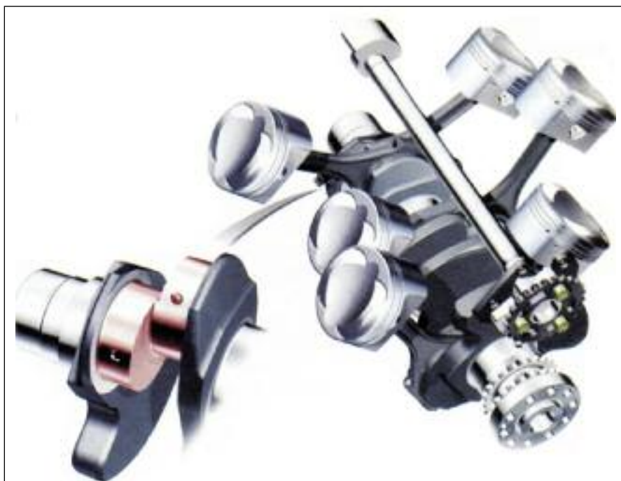
Conjunto rotativo/alternativo – cigüeñal, bielas y pistones – con desplazamiento de los muñones de biela de 30 grados, con eje de equilibrado de las fuerzas de inercia – Audi V6 3.2 FSI.
