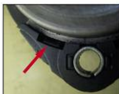
Fig. 1: Espiga plástica dañada por ajuste desparejo. Recomendamos ajustar en cruz y progresivamente.
