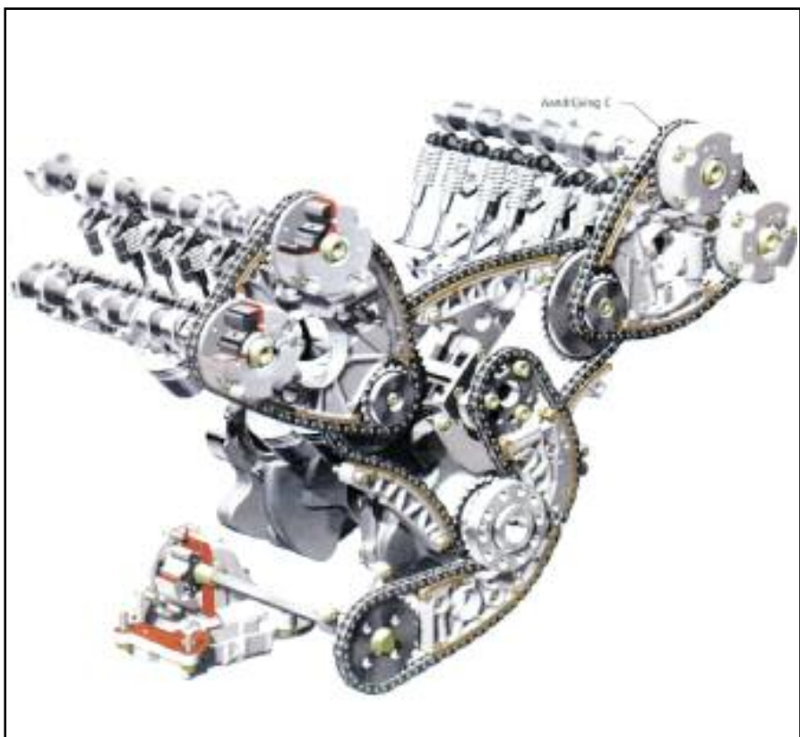
Sistema de distribución complejo de un motor V6, con configuración variable para los árboles de levas de admisión y escape, con tensores accionados hidráulicamente, para las cadenas que mueven incluso la bomba de aceite y el eje de equilibrado.
