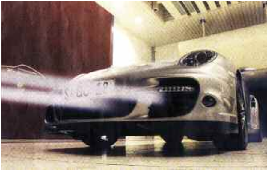
Automóvil PORSCHE 911 Turbo en el túnel aerodinámico, para desarrollar un Cx. de 0,31 y obtener mayores fuerzas de apoyo, con el uso de un alerón accionado electrohidráulicamente, cuando se supera cierta velocidad -PORSCHE.
