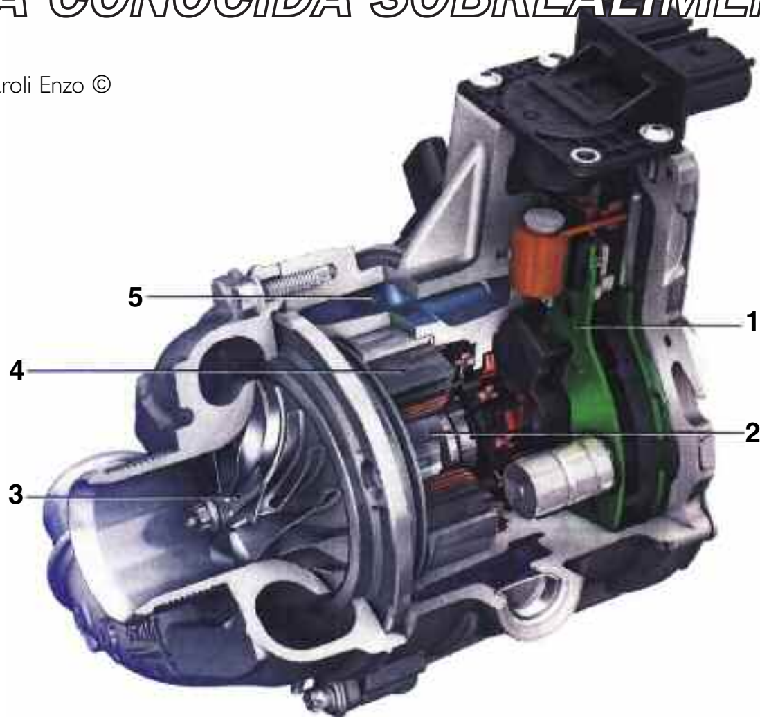
Vista en corte de un turbo eléctrico (e-Booster) y sus partes componentes: 1-Parte electrónica. 2-Rotor eléctrico. 3-Rotor del compresor. 4-Estator eléctrico. 5- circuito de Enfriamiento.
