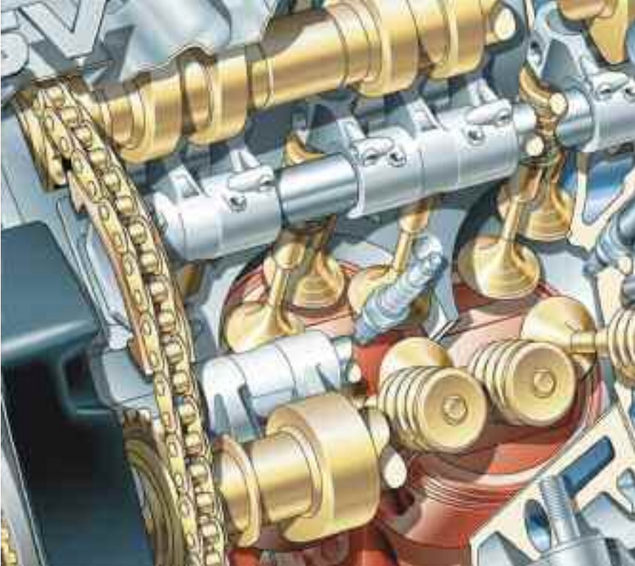
Para llenar mejor la cámara de combustión, lo ideal sería tener siete válvulas por cilindro, pero hasta ahora solo se fabricaron motores con 5 y 6 válvulas por cilindro.
