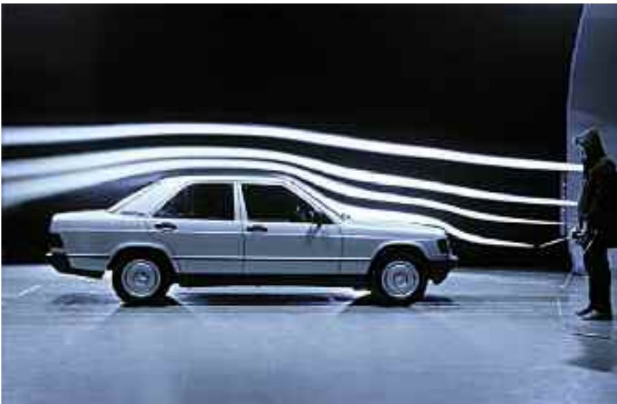
El coeficiente de puntuación Cx, es un factor de forma que indica la eficiencia de un automóvil, respecto a la sección frontal.
