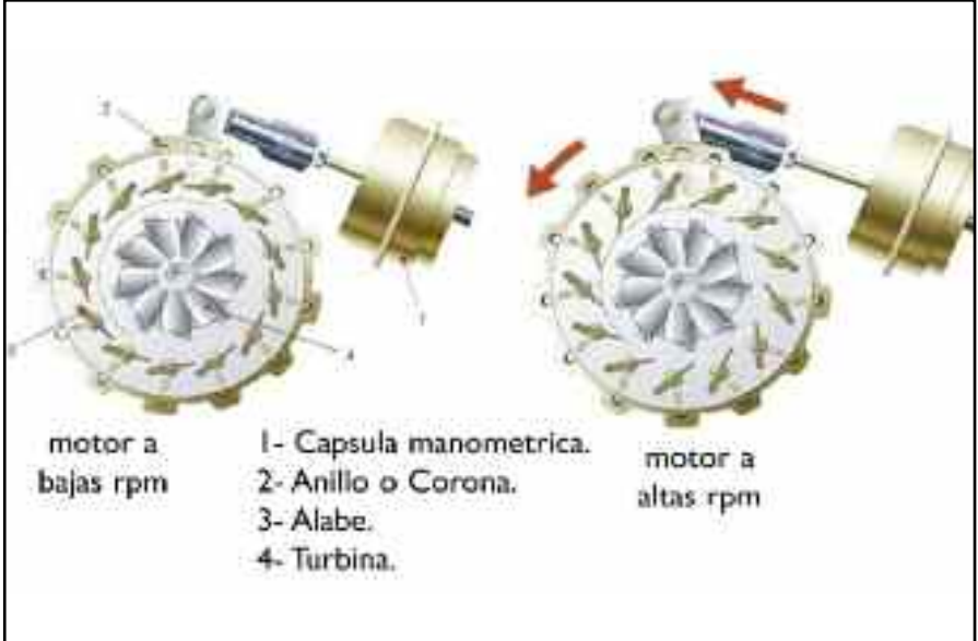
Cuando el motor funciona a altos regímenes, el caudal de gases de escape es importante, debido a la apertura de los álabes.
