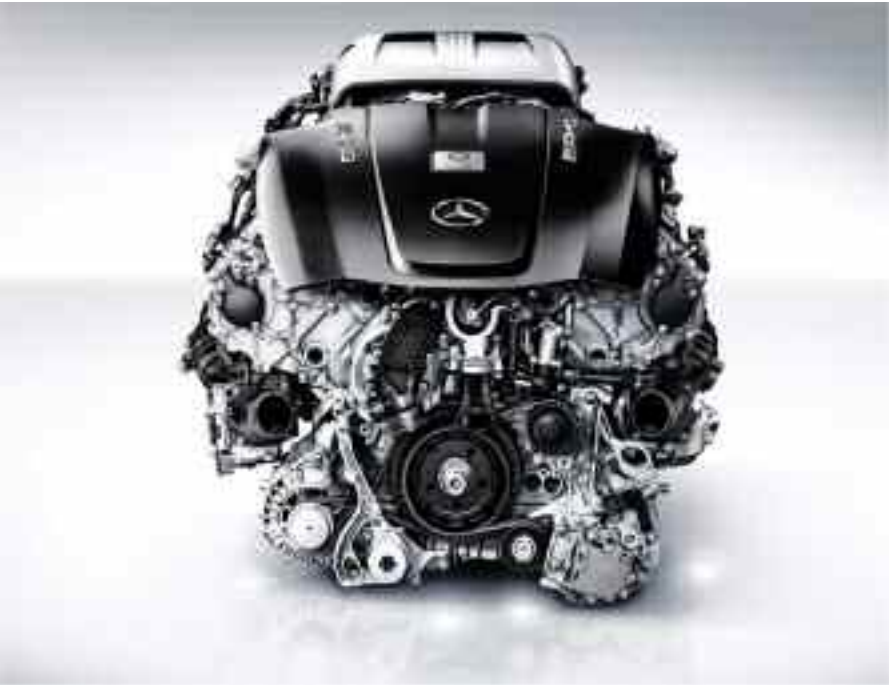
Motor V8 biturbo, detalle de los dos turbos, la admisión y la inyección, y el conjunto alternativa- rotativo-AMG.
