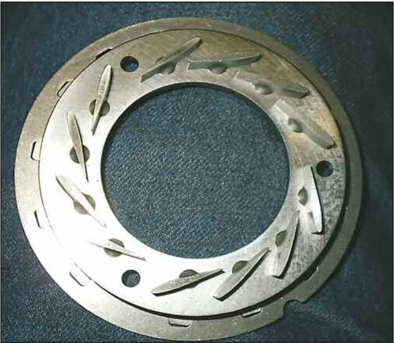
En los TGV, o VNT, con álabes móviles sobre la turbina, son controlados por un pequeño motor eléctrico, regentado por la ECU o unidad de control electrónico. - Anillo de álabes.
