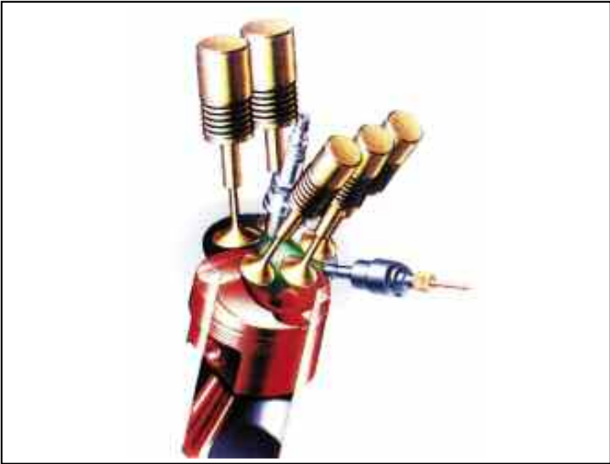
Diseño de una tapa de cilindros, de un motor con inyección directa de nafta/gasolina y 5 válvulas con botadores tipo vaso invertido.
