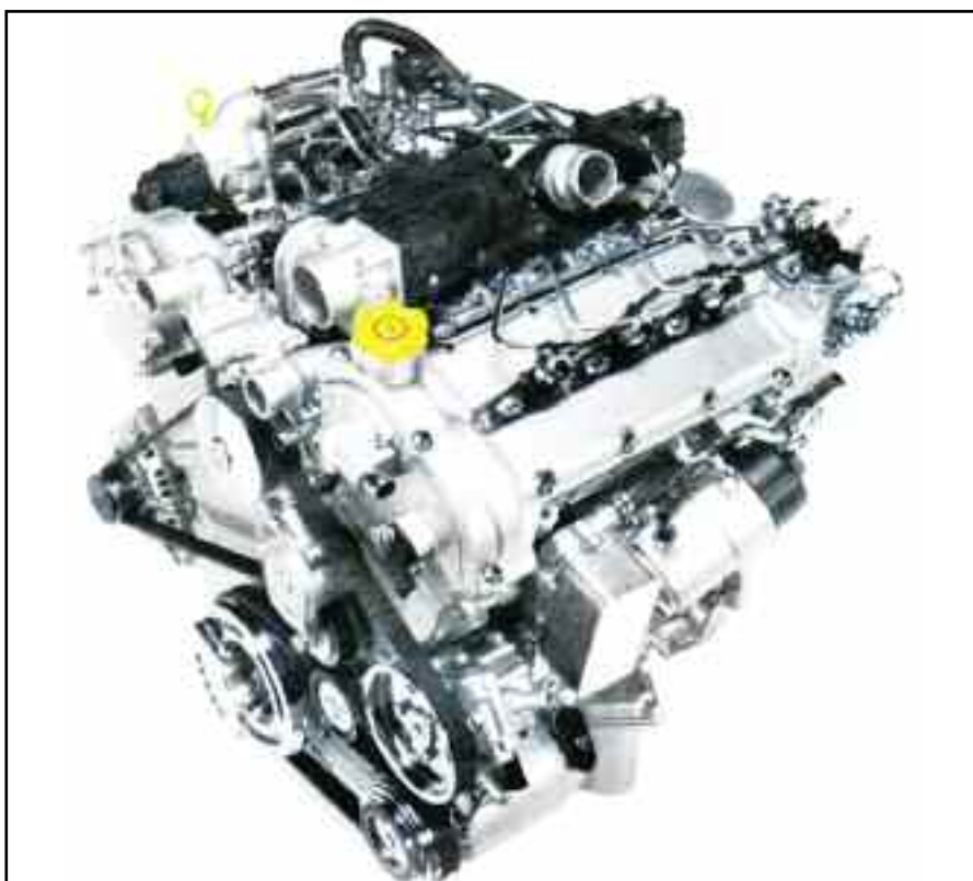
Motor Diesel V6 de 3 litros de GM con bujías incandescentes de pre-poscombustión, que miden directamente la presión de combustión. Con esta información, la ECU puede modificar el momento de inyección del gasoil.
