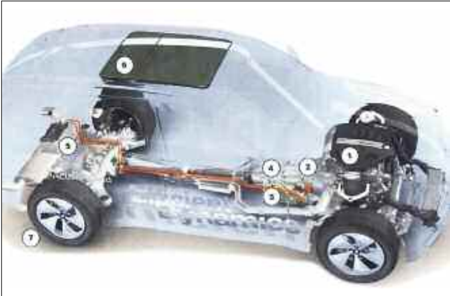
La BMW X5 "Active Hybrid" posee un diseño diferente al X6, que ha sido desarrollado con GM y Mercedes Benz: 1. Motor Diesel de 2.0 litros "Twin turbo" de 150 kW (204 CV). 2. Motor eléctrico de 15 kW (20 CV) con regulación electrónica. 3. Caja automática de 8 velocidades. 4. Baterías de ion litio de 120 Volts. 5. Motor eléctrico de 15 kW para cargar las baterías durante la marcha. 6. Paneles solares para calentar el aceite de la caja automática. 7. Ruedas de diseño aerodinámico.
