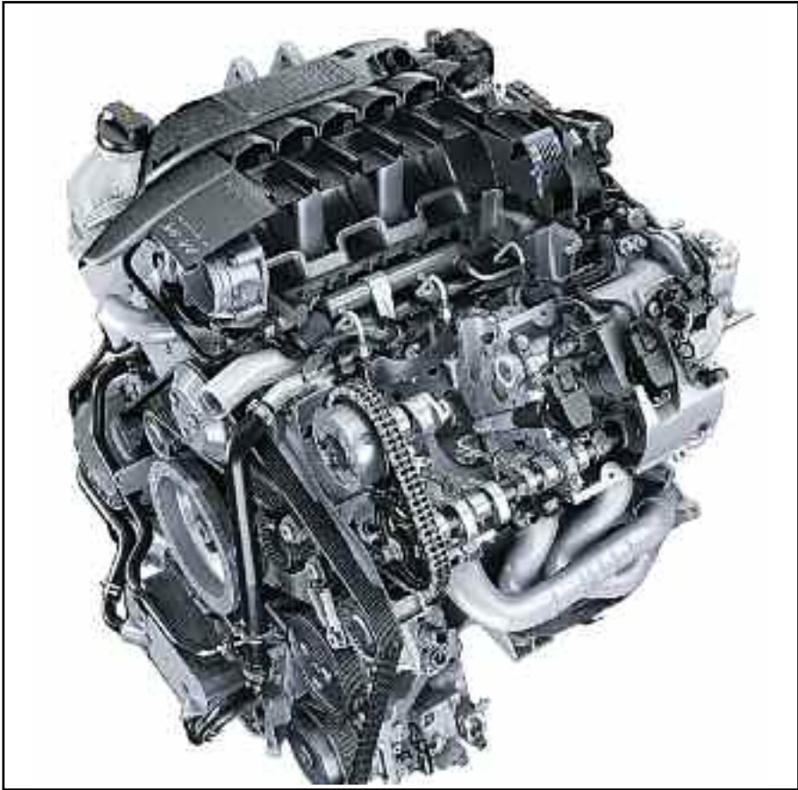
Corte parcial del motor de 6 cilindros en V con inyección directa de 3.6 litros, y sistema de distribución - Porsche Panamera.
