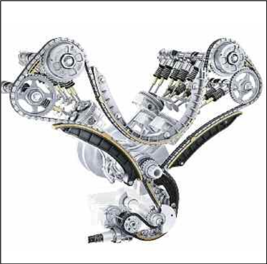
Corte parcial del motor de 6 cilindros en V con inyección directa de 3.6 litros, y sistema de distribución - Porsche Panamera.
