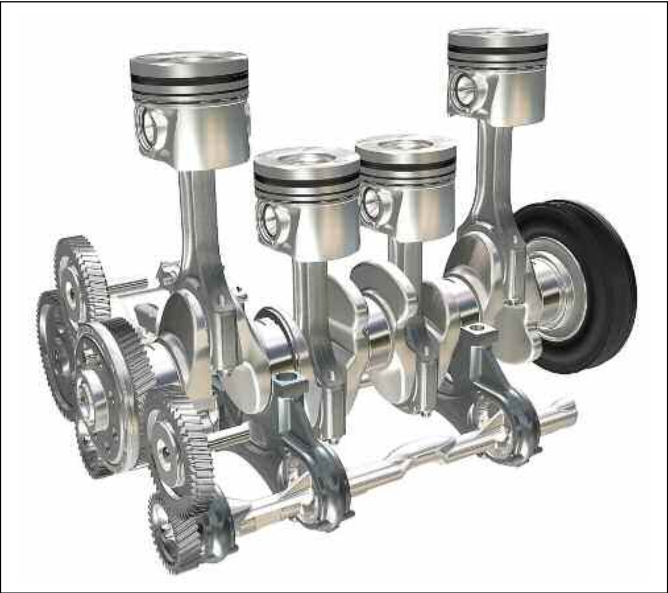
Motor de ciclo Diesel de 4 cilindros en línea en su parte alternativa rotativa (pistón, biela, cigüeñal), con eje de equilibrado tipo Lanchester - M.Benz.
