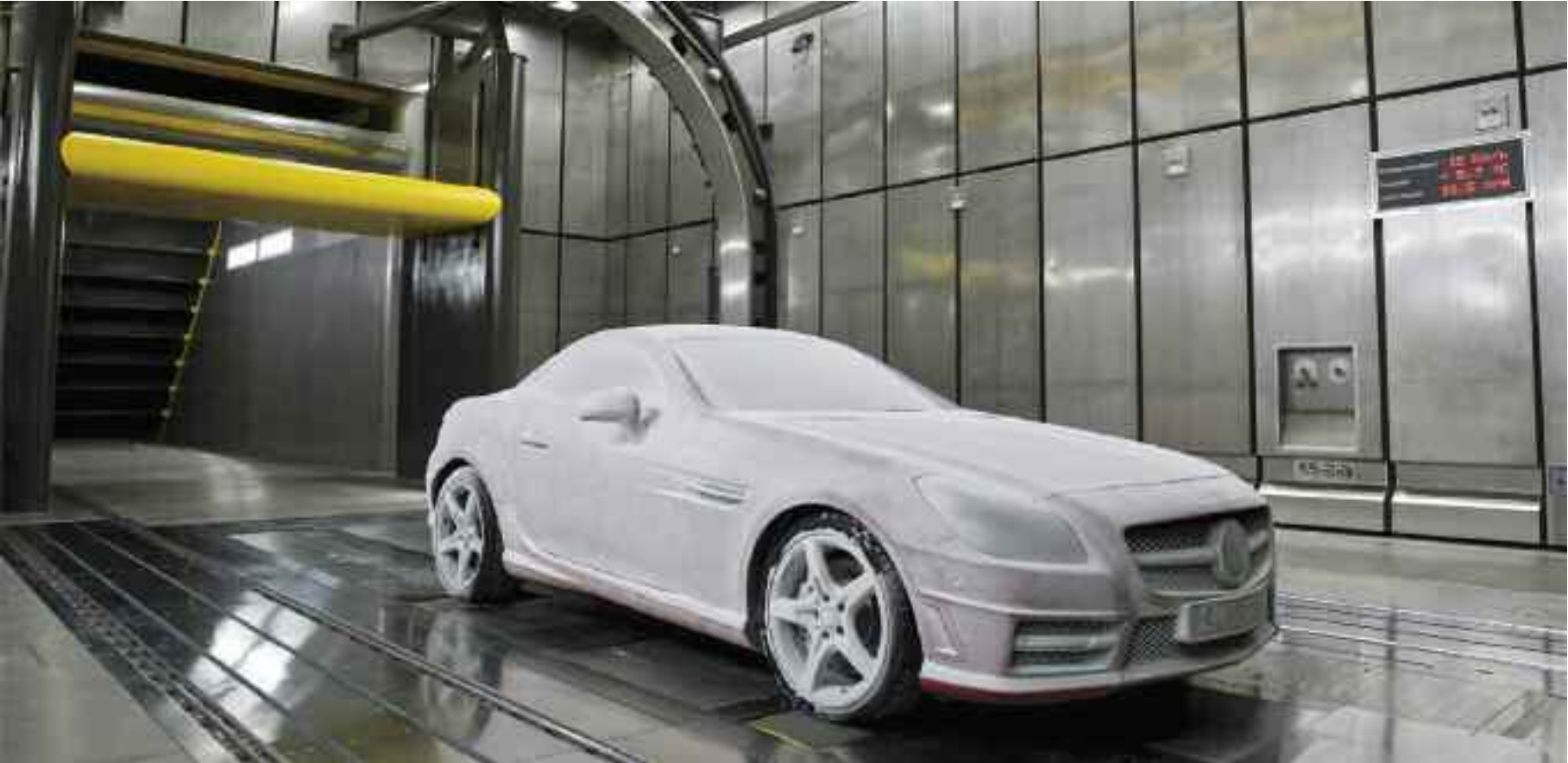
Posee un potente ventilador, capaz de generar velocidades de viento de 270 km/h., apoyado en amortiguadores.
