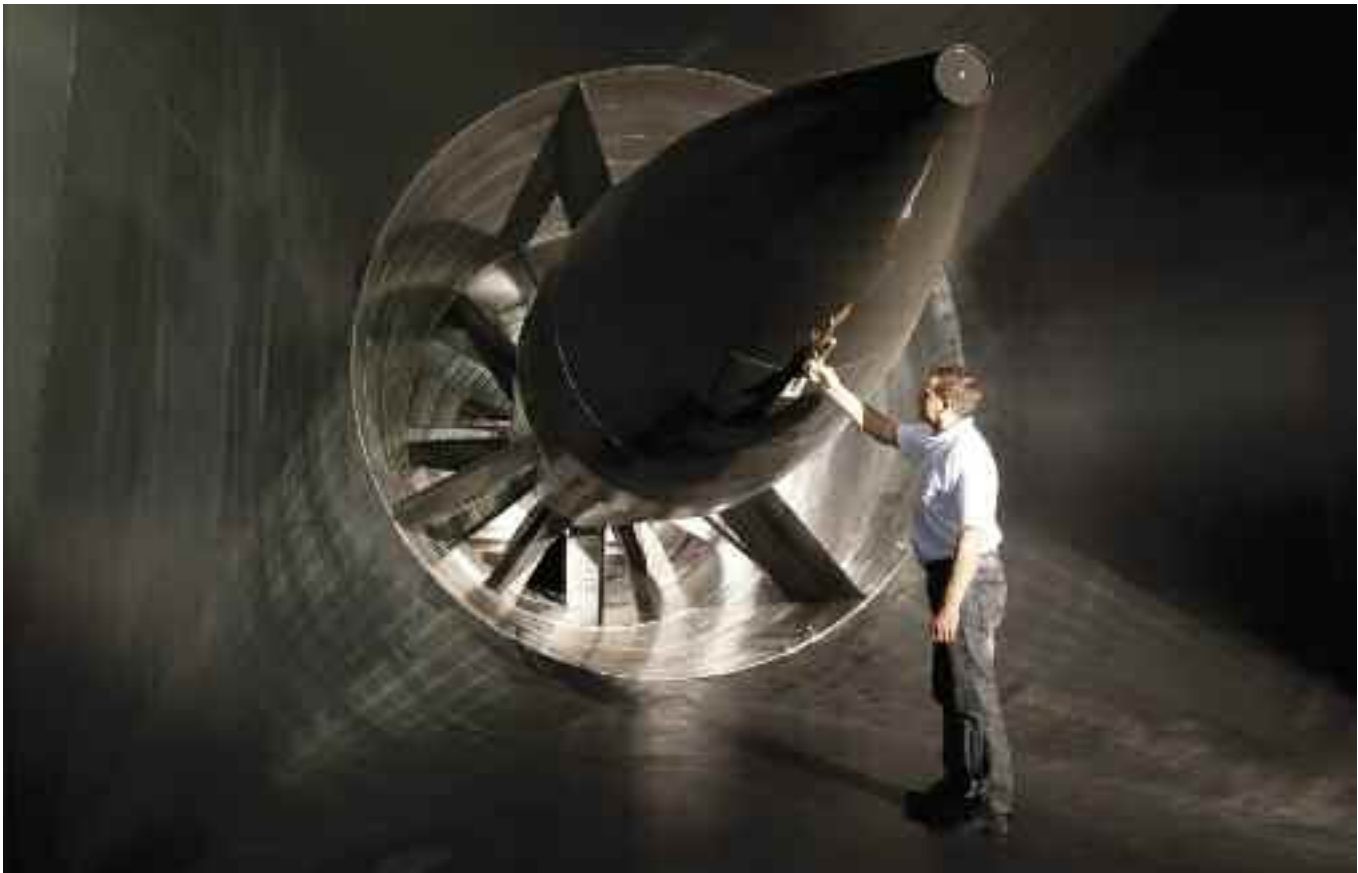
Nuevo túnel de viento climático, para que la terminal automotriz realice pruebas en condiciones extremas - M.Benz.
