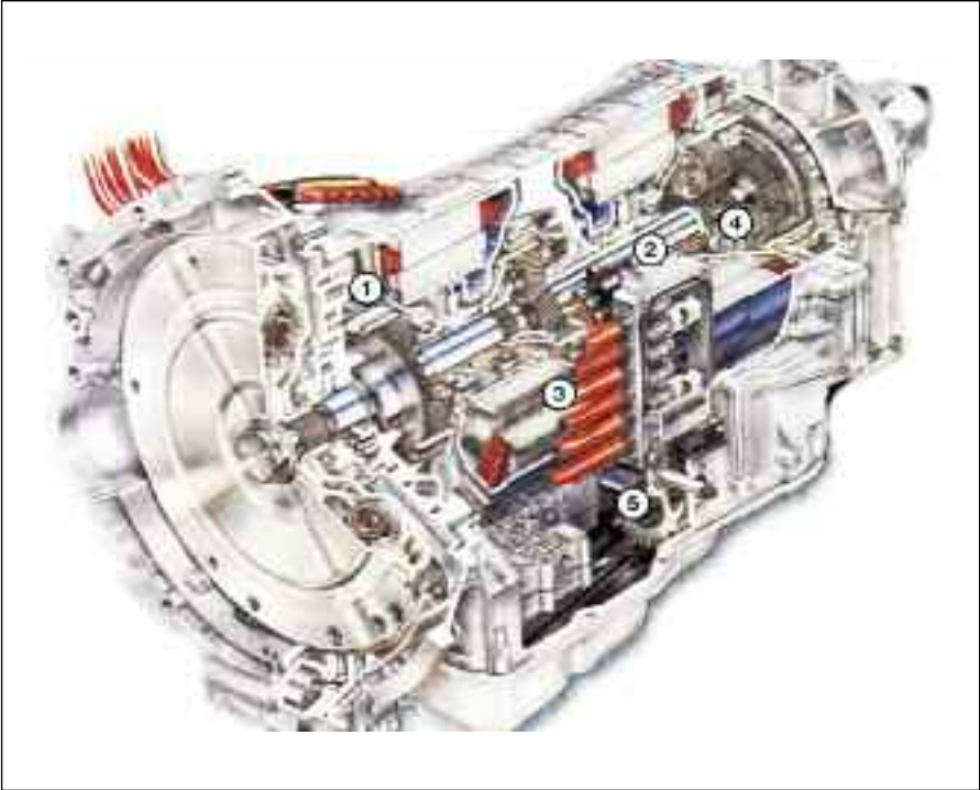
Caja de velocidades especial para los automóviles Híbridos, que contiene al motor eléctrico: 1. Motor eléctrico. 2. Generador. 3. Cables de alto voltaje. 4. Tren de engranajes epicicloidales. 5. Convertidor.
