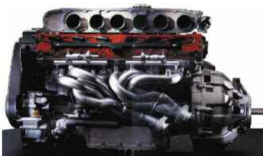
Los conductos de admisión y escape, son de longitud variable, y la alimentación de combustible es por inyección MPI multipunto Bosch Motronic M5.2 integrada. (motor del modelo “550 Maranello”).
