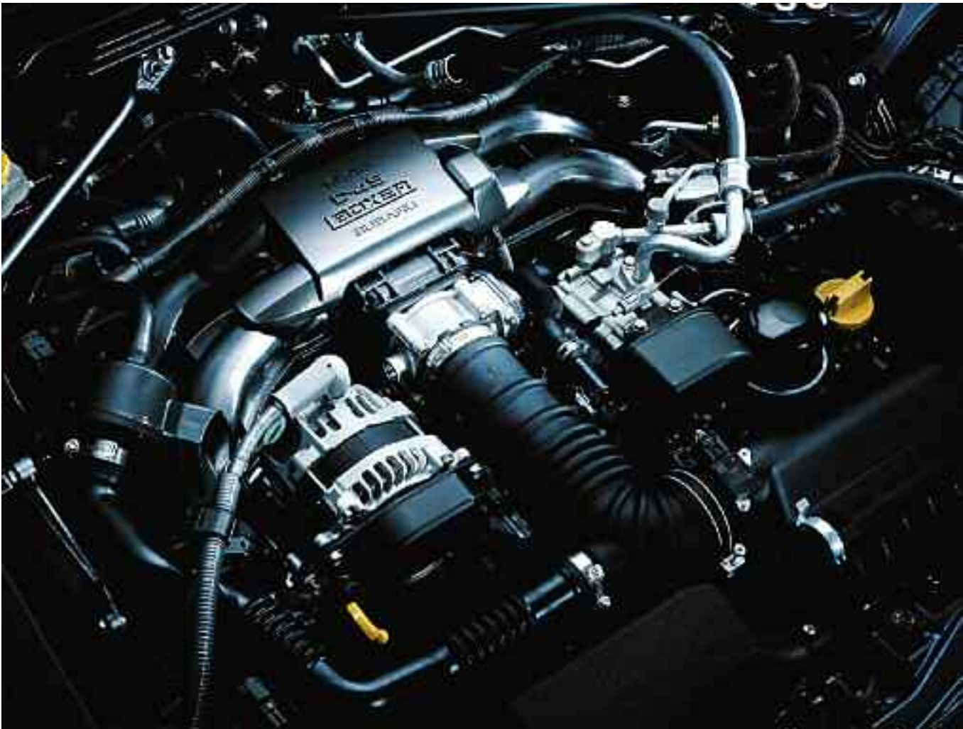
Motor D4S Boxer en el cofre, con inyección de nafta/gasolina doble (directa-indirecta) utilizado por el Subaru BRZ, y por el Toyota GT 86.
