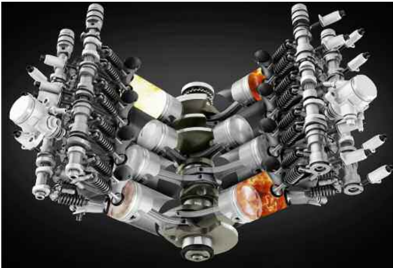
Los motores de alta cilindrada, utilizan el sistema de desconexión de los cilindros, para economizar combustible.
