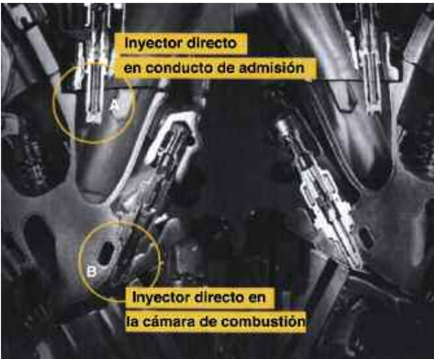
Primer motor en recibir la inyección doble: 6 cilindros en V de 3,5 litros de Lexus: A- Inyección indirecta en el conducto de admisión. B- Inyección directa en la cámara de combustión.
