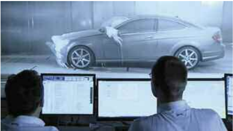
En este túnel, se pueden además realizar precipitaciones pluviales, regulando la intensidad y la forma de los gotas.
