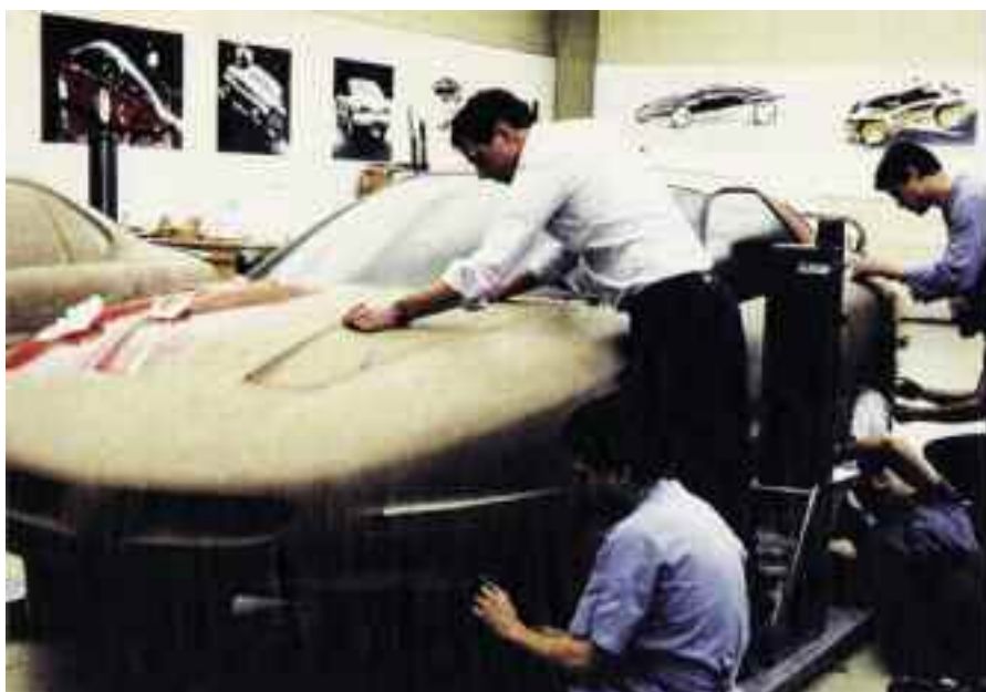
Maqueta realizada en arcilla, en “tamaño real”, donde trabajan todos los especialistas.
