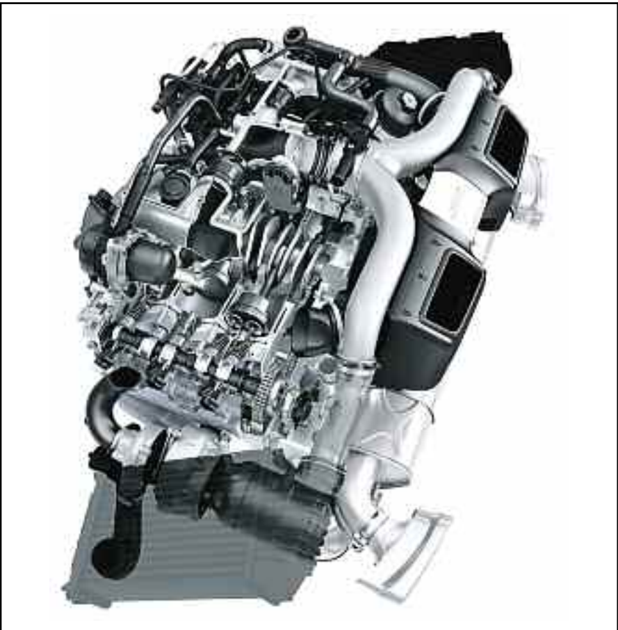
Motor de inyección directa de nafta/gasolina, de 6 cilindros boxer - Porsche 911 Turbo Cabriolet.
