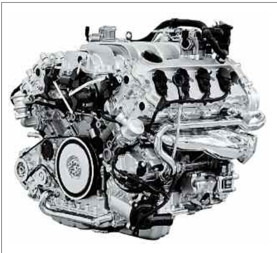
Las terminales automotrices apuestan ultimamente, a las nuevas generaciones de motores Diesel, con inyección directa de alta presión - Volkswagen V8 TDI de 4.2 litros.
