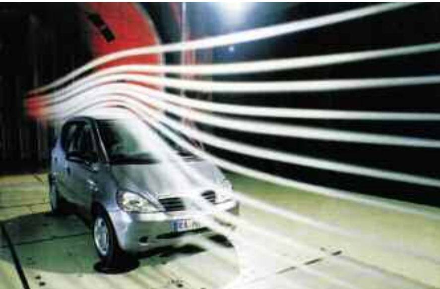
Mercedes Benz Clase A, con una amplia superficie frontal, pero con un coeficiente de penetración aerodinámica Cx relativamente bajo.
