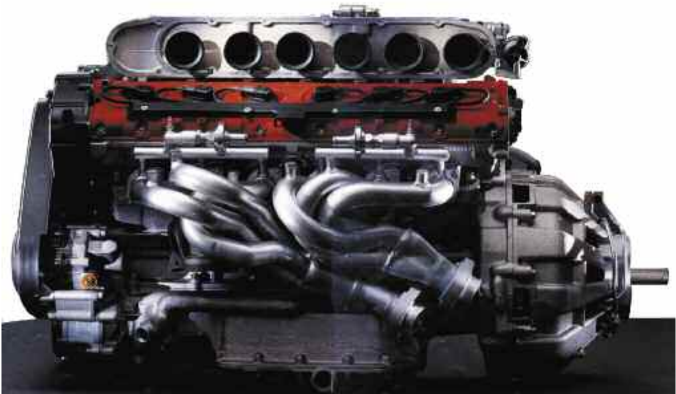
Los conductos de admisión y escape, son de longitud variable, y la alimentación de combustible es por inyección MPI multipunto Bosch Motronic M5.2 integrada. (motor del modelo “550 Maranello”).
