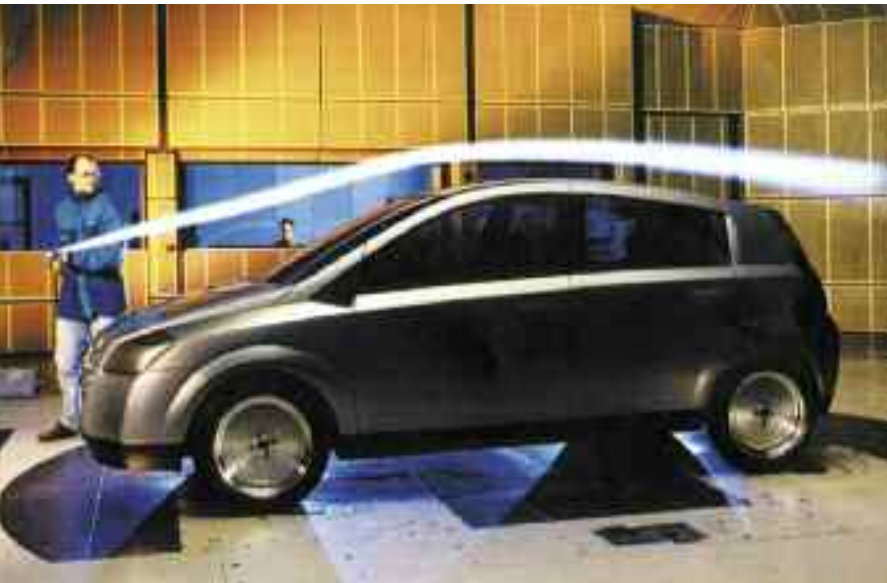
Ensayo en el túnel de viento con humo químico, en donde se descubre el potencial aerodinámico de este modelo G90, que posee un coeficiente de resistencia a la penetración Cx de 0,22.
