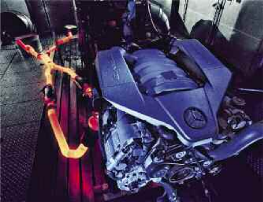
Motor V8 Mercedes AMG. escape al rojo en banco dinámico de pruebas.
