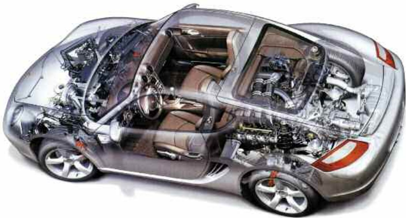
Transparencia del modelo “Cayman S”, que es sin duda el más equilibrado de la actual gama, con un motor de nafta/gasolina boxer de 6 cilindros, 3.4 litros de cilindrada y 295 CV a 6.250 rpm de potencia – Porsche.
