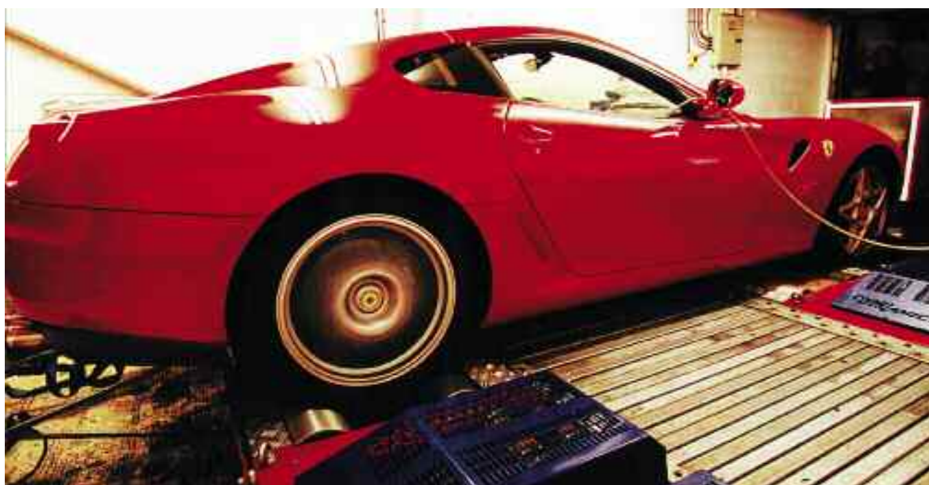
El Cx de la “Ferrari 599 Fiorano” es de 0,34, y no posee ningún tipo de alerón, solo tiene un suave resalte en el borde de la tapa del baúl, que se complementa con un “difusor” trasero que le da toda la “downforce”.
