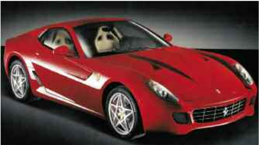
La “Ferrari 599 GTB” posee un motor de 5.999 cm3 de 12 cilindros en V – derivado directamente del modelo Enzo– que entrega 620 CV a 7.600 rpm – Ferrari.
