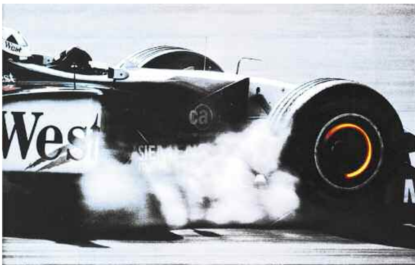
Típica frenada de F1, con bloqueo de las ruedas y columna de humo, y detalle del disco de freno al rojo vivo.
