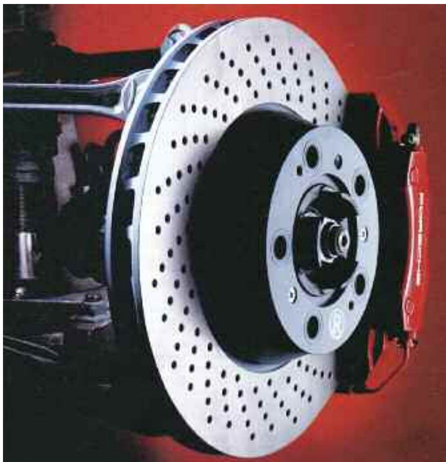
Conjunto de freno delantero a disco (ventilado y perforado) y pinza, desarrollado por Porsche
