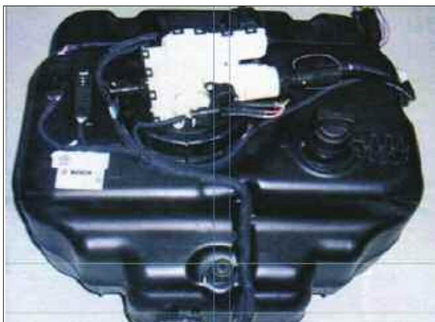
Depósito del aditivo AdBlue ubicado en la parte posterior del vehículo, con una capacidad de 30 litros-M.Benz.
