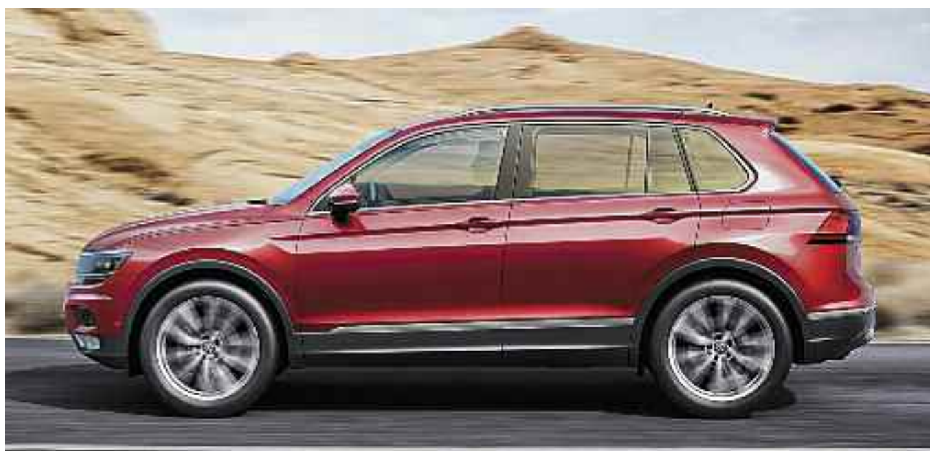
El Volkswagen Tiguan 2016, está construido sobre la plataforma MQB del grupo Volkswagen y sustituye a la primera generación del Tiguan (modelo 2011). Es más largo (mide 4,49 cm), ancho (1,84 cm), la altura es de (1,63 cm) que el modelo al que reemplaza. La distancia entre ejes también aumenta; en 8 cm, mientras que la longitud total se ha incrementado sólo 6 cm.
