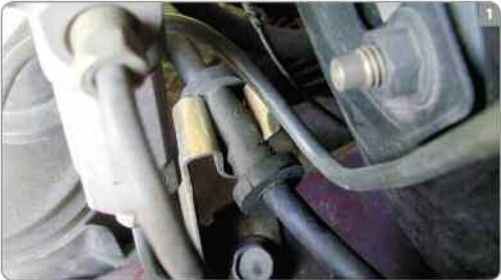
Posición correcta del cable del embrague
