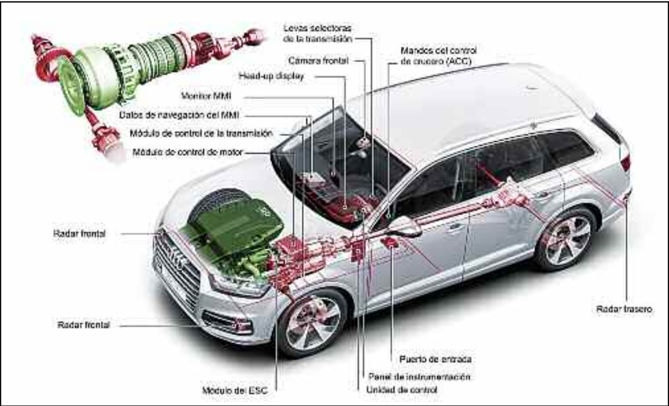
El sistema de tracción total del Audi Q7 e-tron es el mismo que Audi emplea en el resto de la gama. Es un sistema permanente, que en condiciones normales hace un reparto del 40 % a las ruedas delanteras y que puede variar ese valor entre el 15 y el 70%. Del diferencial central autoblocante, que forma parte del conjunto de la caja de cambios, sale un árbol de transmisión hacia el diferencial trasero y otro hacia el delantero. Éste también forma parte del bloque de la transmisión (queda a su lado derecho) y el palier izquierdo atraviesa la carcasa del cambio para poder conectarse con la rueda.
