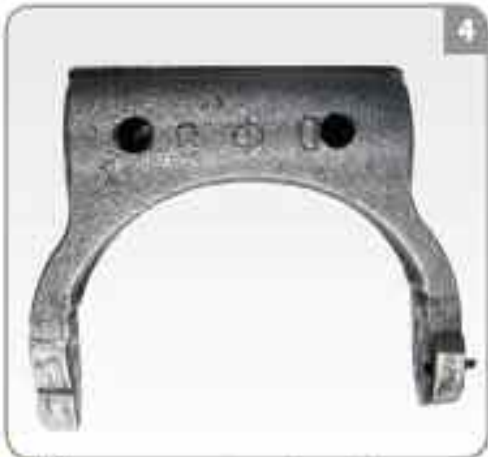
Desgaste excesivo en horquilla.
