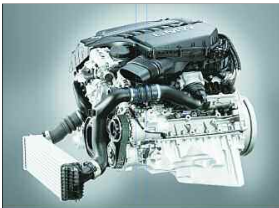
Motor V6 Diesel con sistema BluePerformance compuesto por los dos componentes principales, filtro anti-partículas y catalizador de NOx, cumple con la norma Euro 6-BMW.
