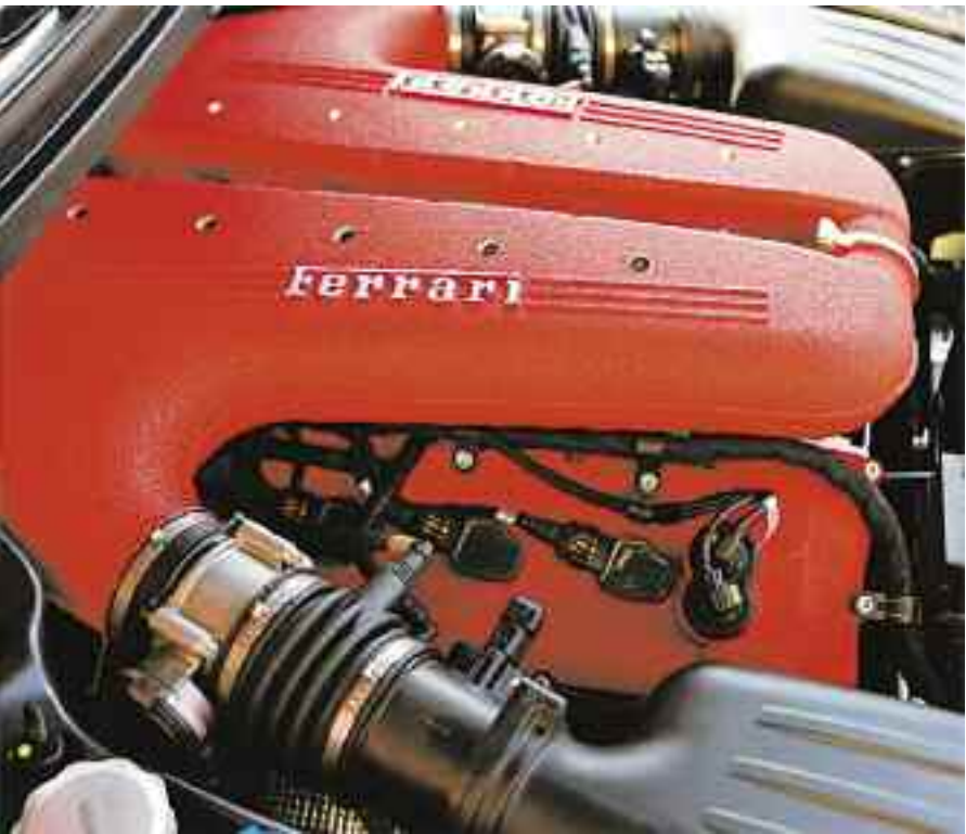
Motor V12 a 65 grados dentro del habitáculo de la GTO.
