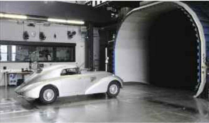
Vehículo deportivo de la década del '40, frente al túnel de viento para estudios aerodinámicos.
