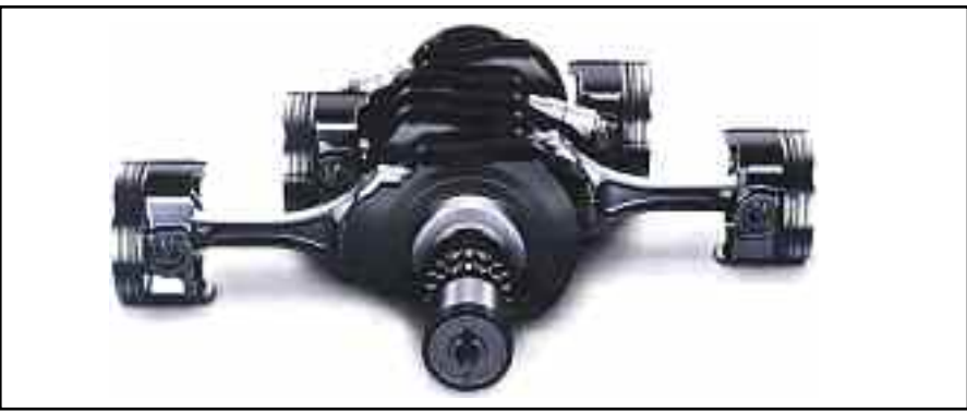
Parte rotativa / alternativa del motor Subaru boxer, de 4 cilindros; cigüeñal, bielas y pistones.
