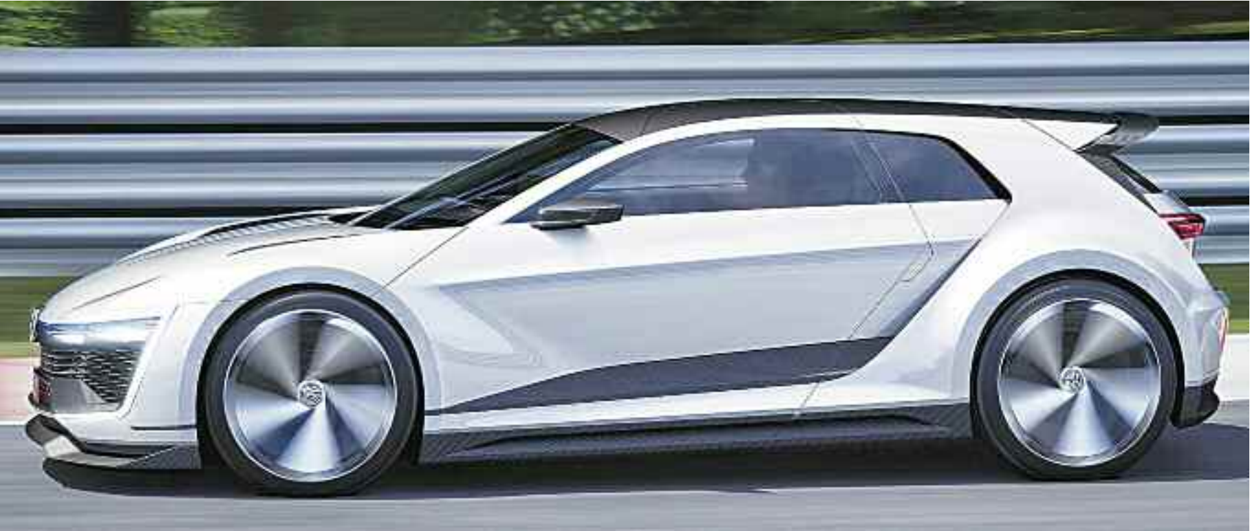
En el “modo GTE” deportivo los tres motores trabajan juntos, dando a todas las ruedas motrices del Golf GTE deporte desde parado hasta 100 Km. / h en 4,3 segundos y una velocidad máxima de 280 Km. / h. En el ciclo NEDC de plug-in de vehículos híbridos el deportivo consume apenas 2,0 l / 100 Km. / h.a
