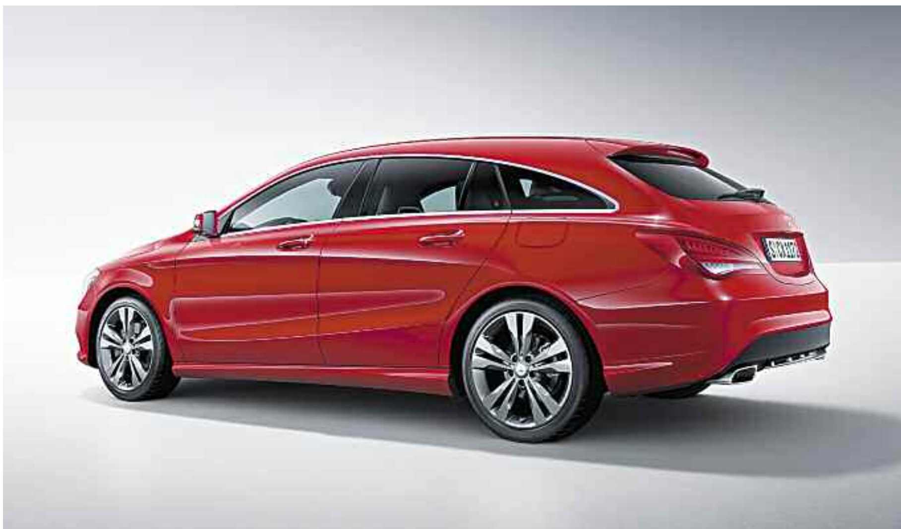
El coeficiente aerodinámico (Cx) mínimo que Mercedes-Benz declara para el CLA Shooting Brake es 0,26. Los neumáticos de serie son de medidas 235/40 R 18. Como alternativa hay disponibles neumáticos 235/35 con llantas de 19 pulgadas..
