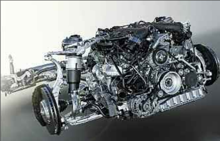
El nuevo motor W12 del Bentley Bentayga utiliza inyección directa e indirecta de combustible sin problemas entre las dos tecnologías, la combinación de estos sistemas maximiza refinamiento, ofrece bajas emisiones de partículas y maximiza la potencia y el par de la entrega. Una impresionante cifra de 292 g / km de CO2 se hace posible en parte gracias al Sistema de desplazamiento variable de Bentley, que cierra la mitad del motor bajo condiciones definidas. De admisión y escape, válvulas de inyección de combustible y de ignición están cerradas en los cilindros definidos, con el motor en marcha con seis cilindros para mejorar la eficiencia.
