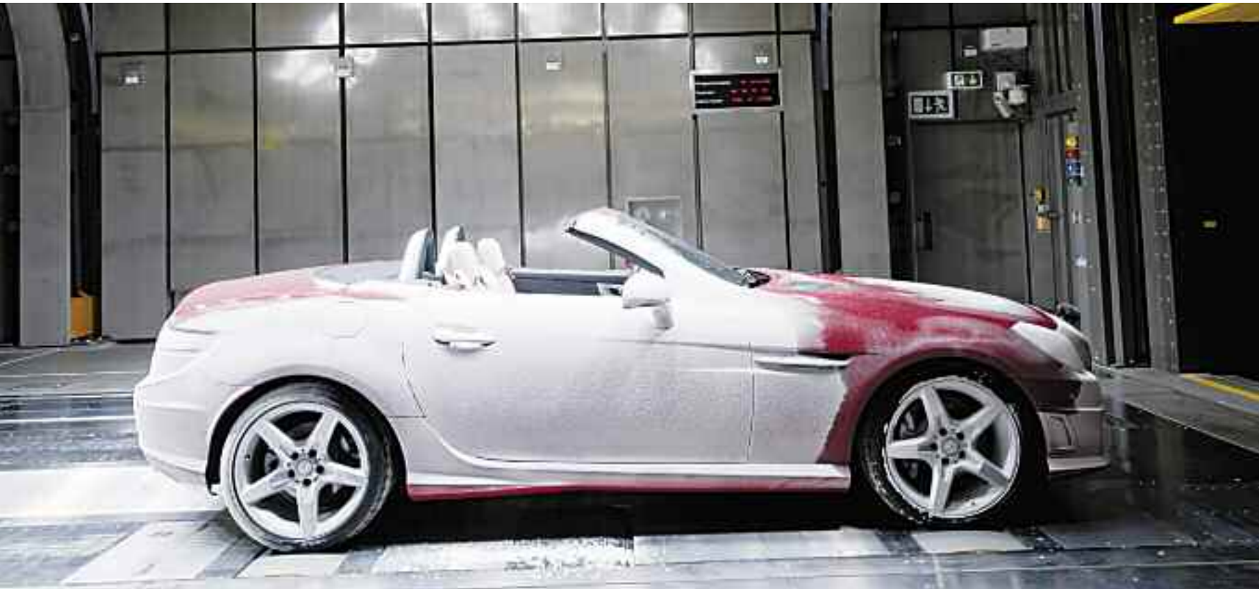
En los últimos años, las terminales automotrices han invertido en la construcción de túneles de viento y climáticos con las ruedas en movimiento.
