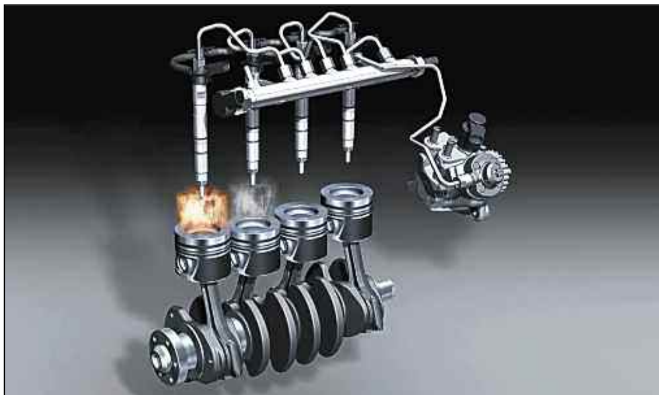
El sistema de inyección "Common rail" aportó en gran medida, al mejoramiento del proceso de combustión completa.
