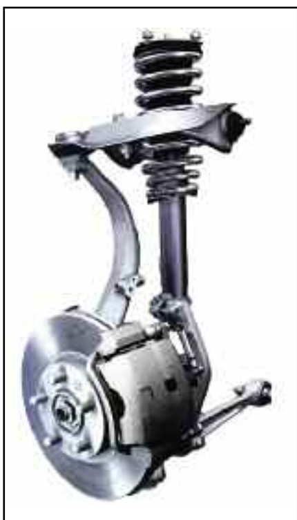
Componentes de la suspensión McPherson delantera, con amortiguador, resorte helicoidal, brazo lateral e inferior.
