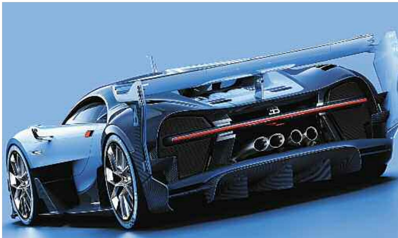
La parte trasera del Bugatti Vision Gran Turismo, tiene un fuerte borde de salida que proporciona una excelente estabilidad de conducción, agota el aire caliente del compartimento del motor y, no menos importante, demuestra inequívocamente el competidor virtual que un Bugatti está consiguiendo adelante y lejos de ellos.
