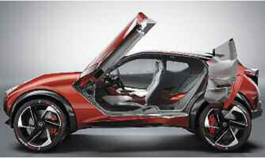
Nissan Gripz Concept Tiene cuatro plazas y cinco puertas. Las laterales delanteras se abren hacia adelante y arriba, y las traseras lo hacen hacia detrás. La carrocería carece de pilar central. El motor de nafta/gasolina se emplea para generar electricidad. Nissan no da más información técnica del sistema de impulsión. Es algo más corto y bajo que el Nissan Juke pero considerablemente más ancho (4,10 m de largo, 1,89 m de ancho y 1,50 m de altura, frente a 4,14 m, 1,77 m y 1,57 m).
