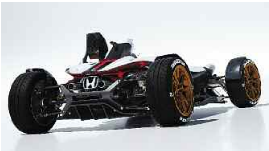
Según Honda, el puesto de conducción del Honda Project 2&4 tiene un diseño con asiento flotante que hace que el conductor vaya sentado muy cerca del suelo, sin apenas interponerse la carrocería entre él y el suelo.
