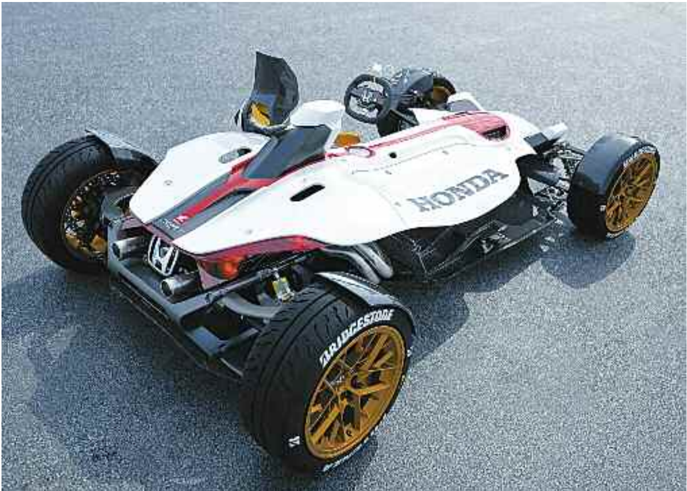
El motor del Honda Project 2&4 tiene cuatro cilindros en V, 1,0 litros de capacidad, la potencia es de 215 CV con 118 Nm de par máximo a 10.500 rpm. Es capaz de girar hasta a 14.000 rpm y está colocado en posición central.
