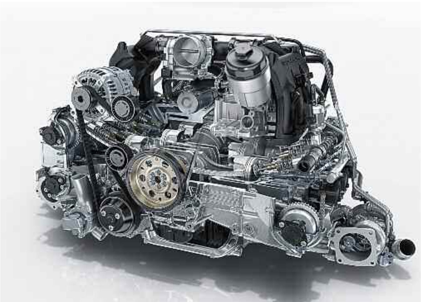
El motor del 911 Carrera S ahora entrega 420 caballos de fuerza (309 Kw.). En ambos casos, esto representa un aumento de potencia de 20 CV (15 Kw.). Ambos motores tienen una cilindrada de tres litros. La mayor potencia de los 911 Carrera S resultados de turbocompresores con compresores modificados, un sistema de escape específico y de gestión del motor afinado.
