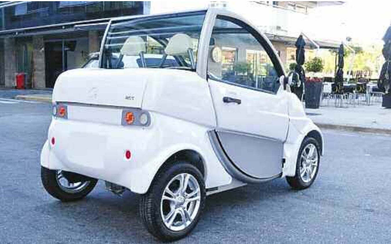
El motor del Sero Electric tiene una potencia máxima de 8 Kw. (10,8 CV) con autonomía de 65 km provisto de batería de gel. Con baterías de litio se estima que llegará a los 120 km.
