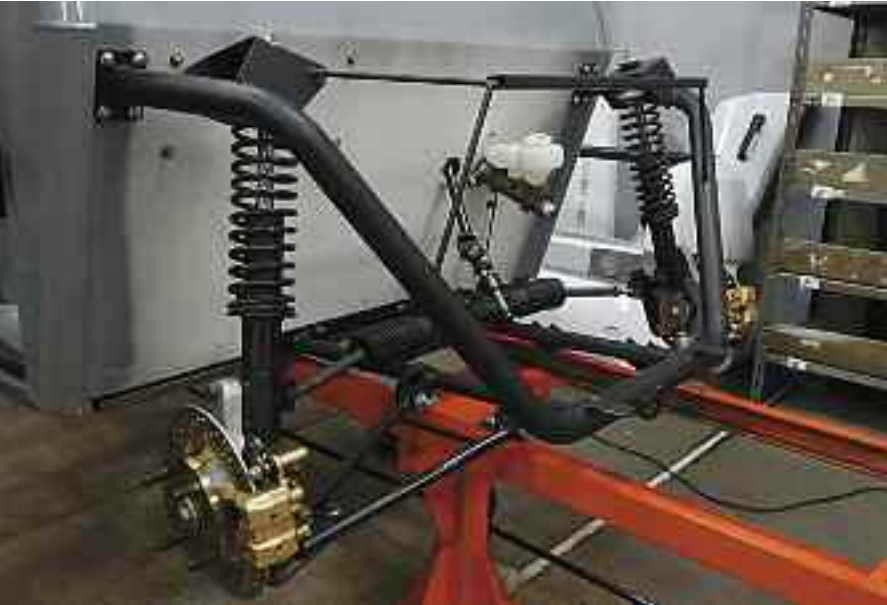
Componentes ensamblados en el tren delantero del Sero Electric.
