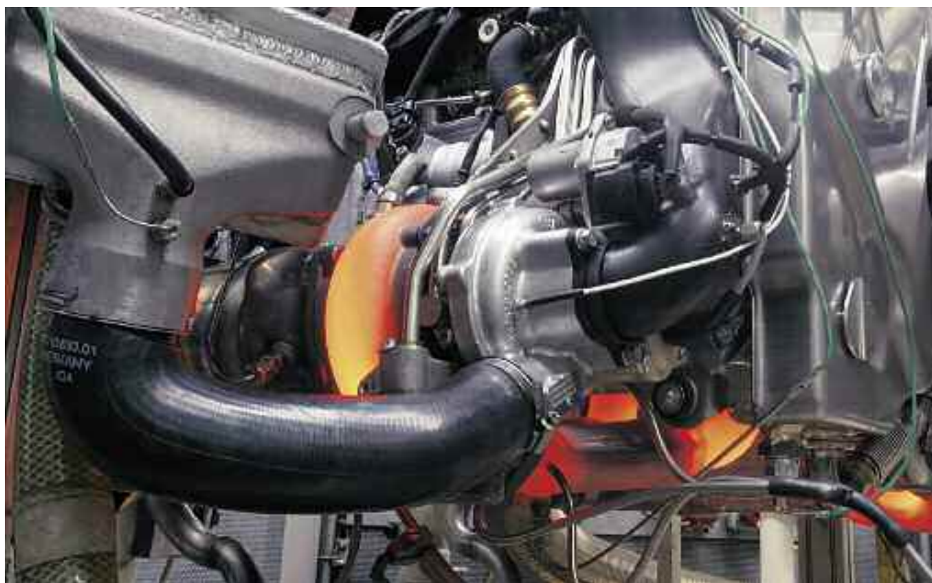
Motor boxer de 6 cilindros opuestos en banco de pruebas, con turbosobrealimentación- Porsche.
