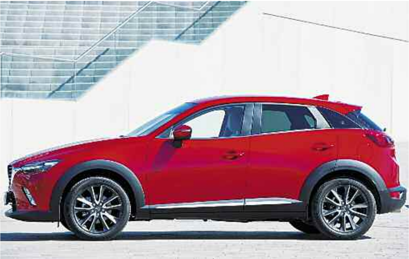
El Mazda CX-3 mide 4,28 metros de longitud y, a pesar de su denominación, no está relacionado con el Mazda3, sino que es un modelo derivado del Mazda2, con el que comparte plataforma aunque sea más alto.
