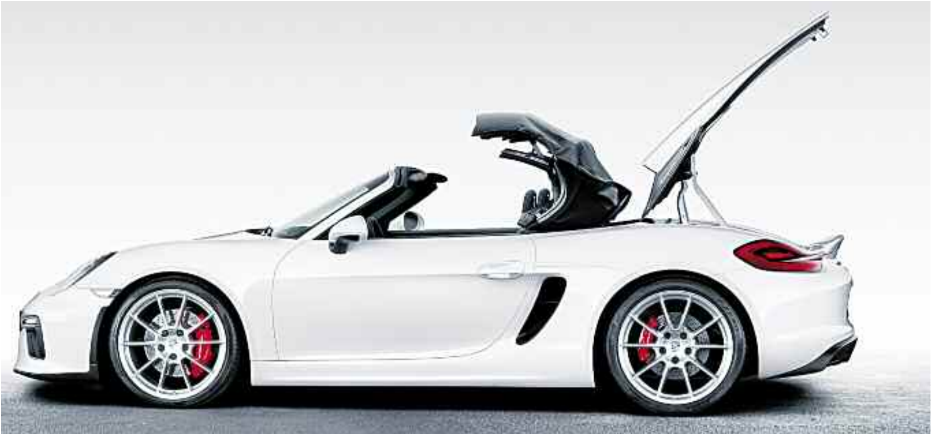
La capota del Boxster Spyder, está menos elaborada que la de cualquier otro Booster y eso influye en que no aisle tanto del ruido, y posiblemente, del frío o del calor. Se nota que es sencilla porque por su cara interior se ve gran parte de su estructura metálica y articulaciones. La operación de plegado o desplegado requiere bajarse del auto y hacer una serie de pasos sencillos, pero que toman un tiempo en torno a un minuto, si se conoce el procedimiento y se ha realizado varias veces con anterioridad.
