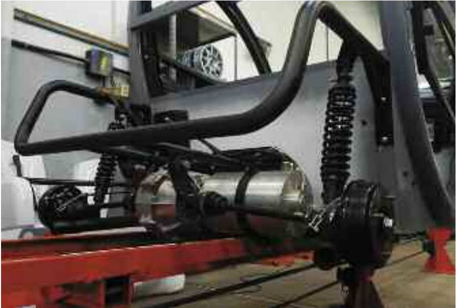
Componentes del propulsor y la suspensión delantera del Sero Electric.
