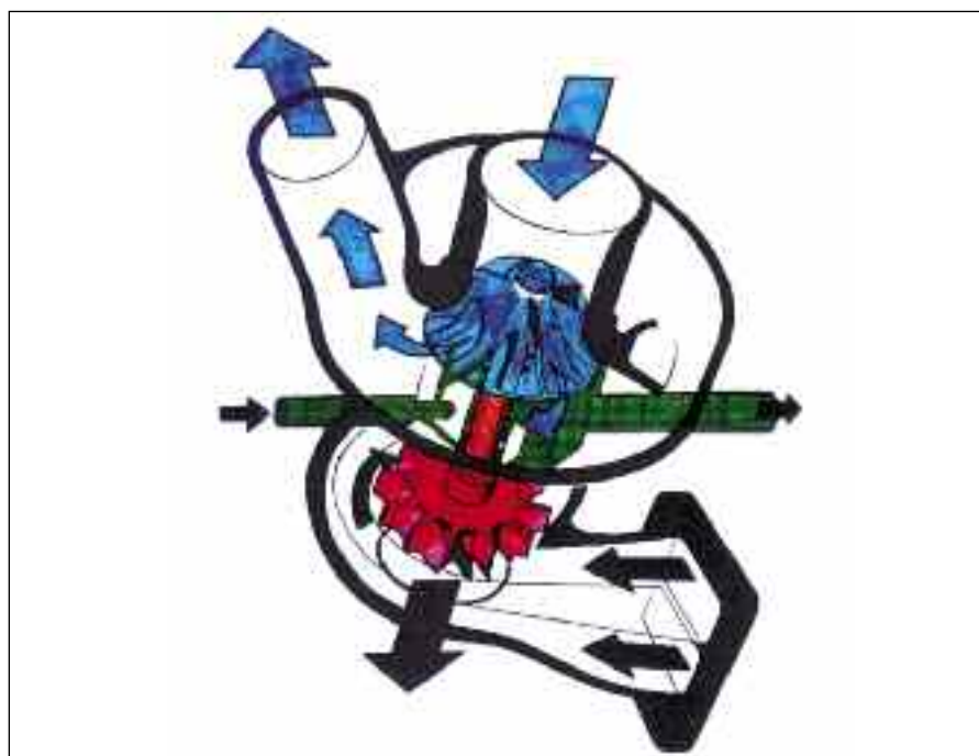
Turbosobrealimentador básico, y detalle de la turbina caliente y el compresor.
