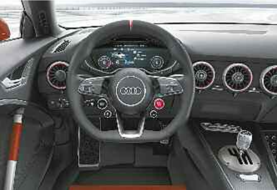
En el Audi TT clubsport turbo su interior nos muestra un panel de control completo. En las puertas y en la consola central, piezas de CFRP con sus grandes superficies crean acentos deportivos, y las puertas se cierran tirando de una empuñadura en forma de tubo con una incrustación de Alcantara.
