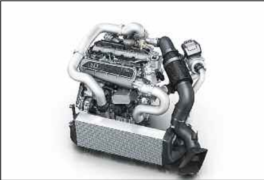
El motor 2.5 TFSI del Audi TT clubsport turbo es enfriado por un radiador de tipo de carreras. A partir de 2.480 cc de desplazamiento, el motor de cinco cilindros produce 441 Kw. (600 CV) de potencia y 650 Nm de par motor, de 3.000 a 7.000 rpm. Esto significa potencia de 176 Kw. (240 CV) y 260 Nm por litro de cilindrada. El poder es transferido a través de una transmisión manual de seis velocidades.
