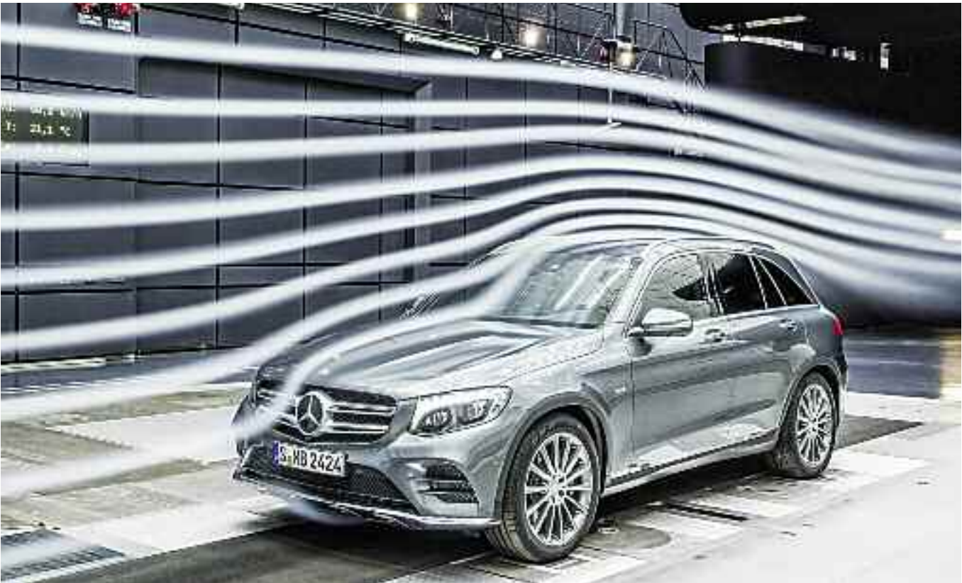
En el túnel de viento el Mercedes Benz GLC prueba, su mejor aerodinámica: pesa 80 kg menos (50 kg se reducen en la carrocería, que tiene de aluminio las aletas delanteras, el capó y el techo) y el coeficiente aerodinámico mejora de 0,34 a 0,31. No hay ninguna antena a la vista porque todas van integradas en los retrovisores exteriores y en el alerón del techo.
