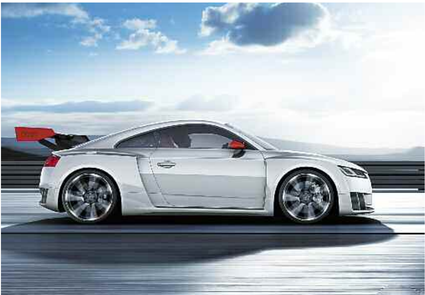
Las llantas del Audi TT clubsport turbo son de tamaño 9,5 J x 20. Su diseño de seis radios dobles está acabado en un aspecto bicolor - tanto brillo turno terminado y negro mate - y los neumáticos son de tamaño 275/30. Los discos de freno cerámicos de carbono de fibra se montan detrás de las cuatro ruedas; son muy livianos y resistentes al desgaste. Los discos de freno delanteros miden 370 mm de diámetro.
