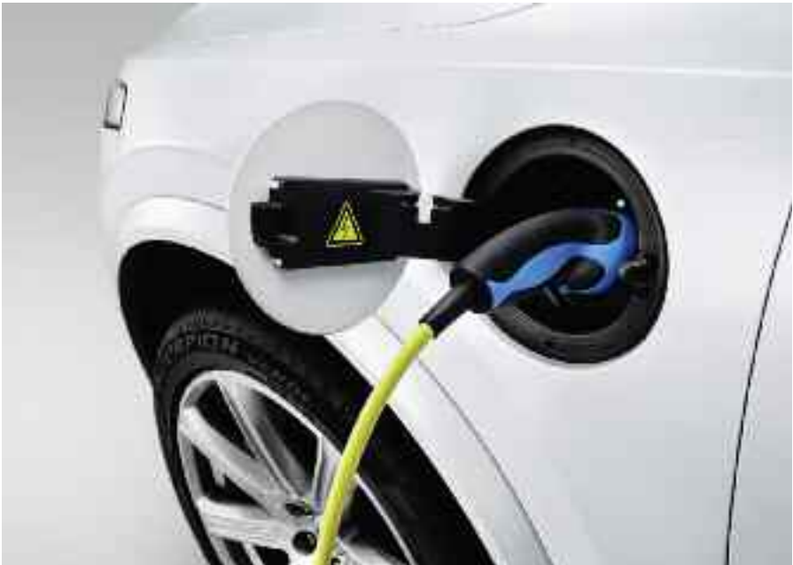
Toma de recarga eléctrica exterior de la batería que genera 65 kW del Volvo, el XC90 con una tensión de entre 270V y 400V.
