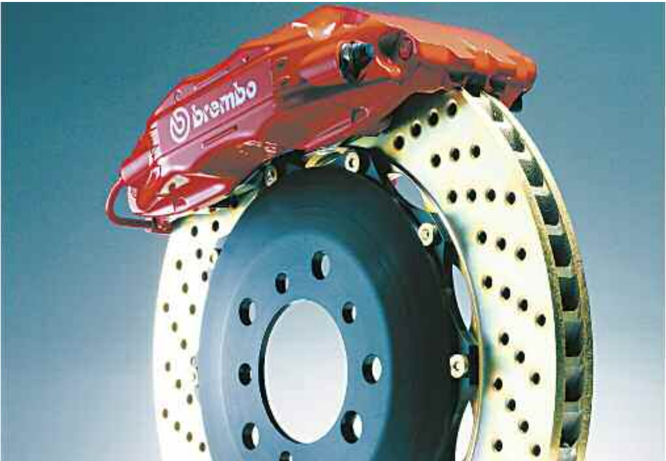
La distribución del caudal de calor Los vehículos deportivos y de competición utilizan, desde hace un tiempo, discos de freno ventilados y perforados – Brembo.
