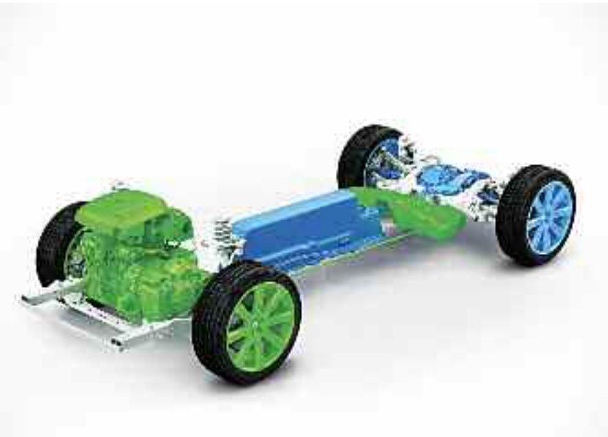
La batería del Volvo, el XC90 genera 65 kW con una tensión de entre 270 y 400 voltios y está ubicada en el túnel central. El motor eléctrico situado en el eje trasero desarrolla 82 CV de potencia y 240 Nm. Un único sistema gestiona la distribución de la energía recuperada durante la frenada, derivándola a la carga de la batería, bien a la impulsión de manera inmediata
