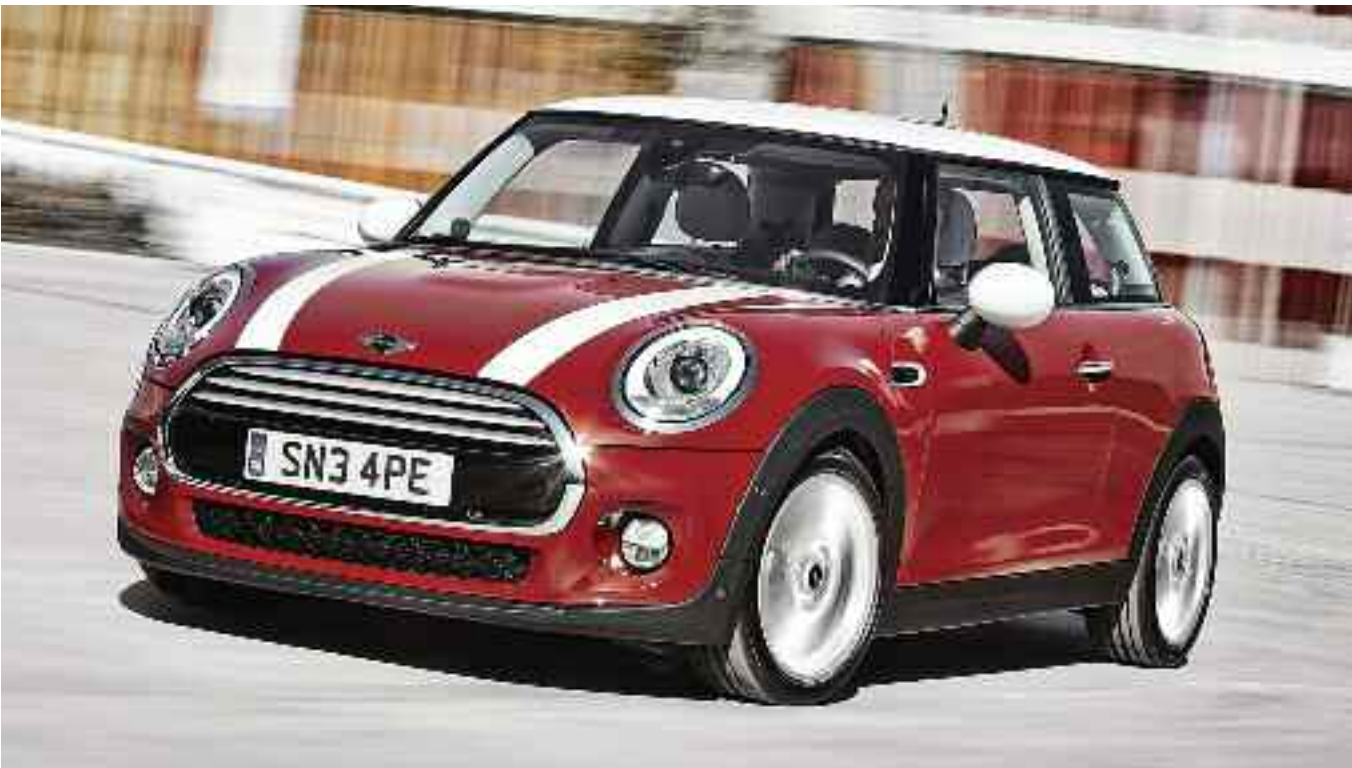
El nuevo MINI Cooper D posee un motor Diesel de 3 cilindros que moviliza su potencia máxima de 85 KW/116 CV a 4.000 rpm. El par máximo de 270 Nm a 1 750 rpm, lo que permite una aceleración de cero a 100 km / h en 9,2 segundos, con transmisión manual y automática. La velocidad máxima es de 205 km / h., también logra óptimo consumo de combustible, con un promedio de 3.5 a 3.6 litros (3.7 a 3.8 litros) a los 100 km. Su nivel de emisiones de CO2 es de 92 a 95 gr/ km (98 a 99 g / km, cifras ciclo de pruebas UE, que dependen del formato de los neumáticos seleccionados.
