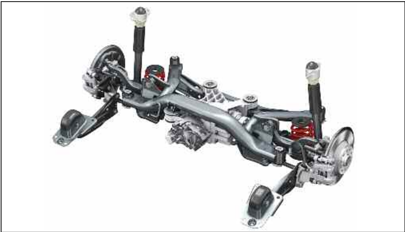
La suspensión en las ruedas traseras la componen cuatro brazos. De serie en el TTS, y opcionalmente en el resto, hay unos amortiguadores de dureza variable —Audi magnetic ride— cuyo funcionamiento (basado en la aplicación de un campo magnético sobre un fluido que ve alterada su resistencia al movimiento) ha sido mejorado.
