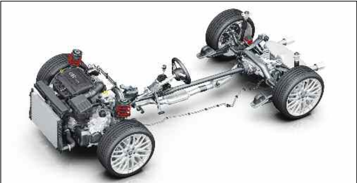
La suspensión en las ruedas traseras la componen cuatro brazos. De serie en el TTS, y opcionalmente en el resto, hay unos amortiguadores de dureza variable —Audi magnetic ride— cuyo funcionamiento (basado en la aplicación de un campo magnético sobre un fluido que ve alterada su resistencia al movimiento) ha sido mejorado.
