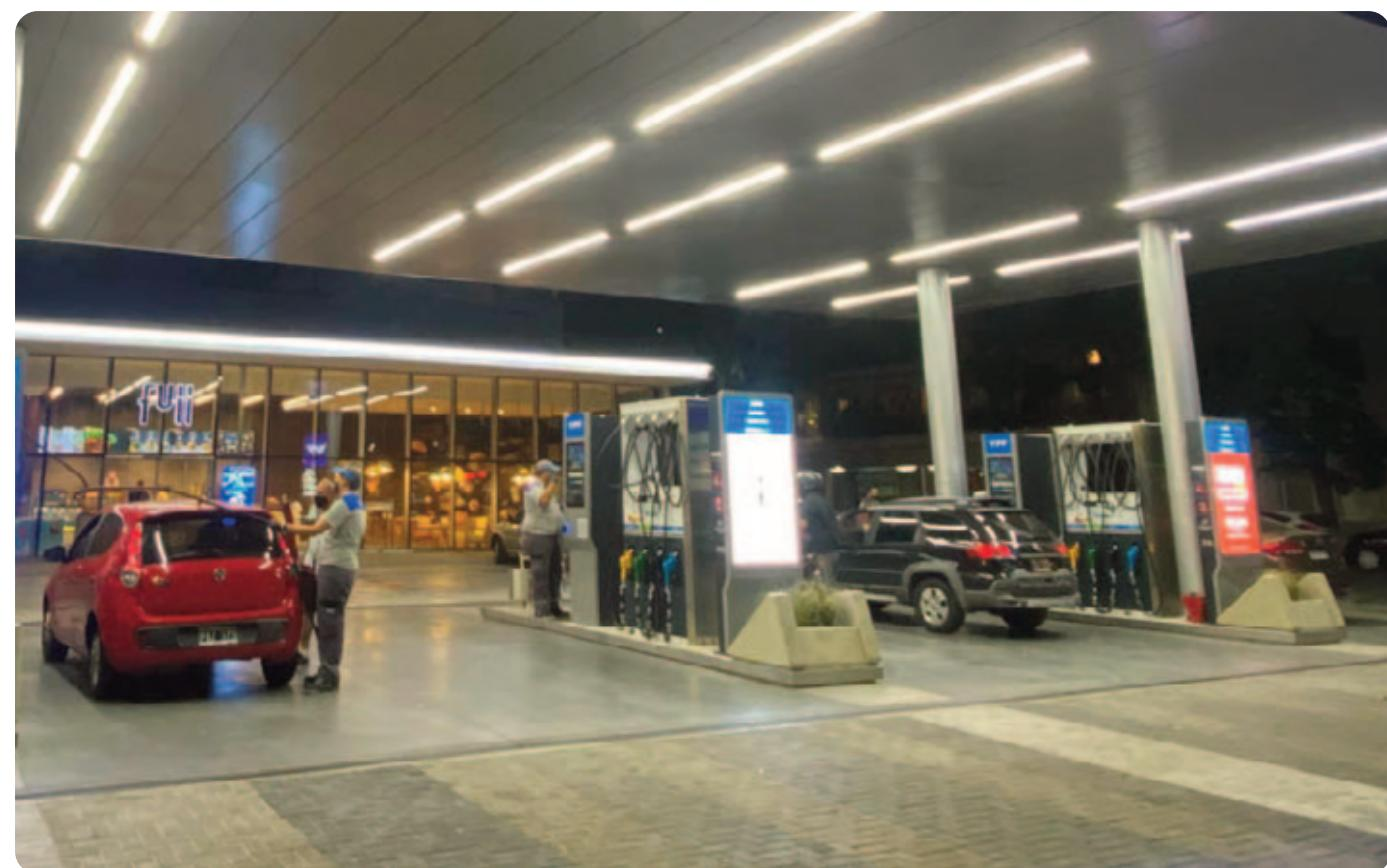
Una definida área alrededor del surtidor de Nafta es clasificada como área de riesgo de explosión. Esta zona es definida como un cono con una base cilíndrica centrada alrededor del eje del surtidor.
